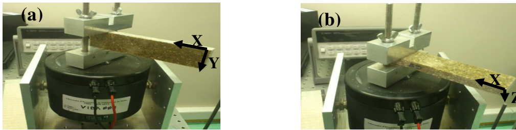
Figure 4.9: Les deux configuration permettant d'exciter le béton base polymère en résonance. (a) : Le plans XY (vertical). (b): Le plans XZ (horizontal).
