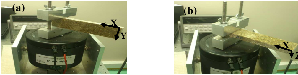
Figure 4.9: Les deux configuration permettant d'exciter le béton base polymère en résonance. (a) : Le plans XY (vertical). (b): Le plans XZ (horizontal).
