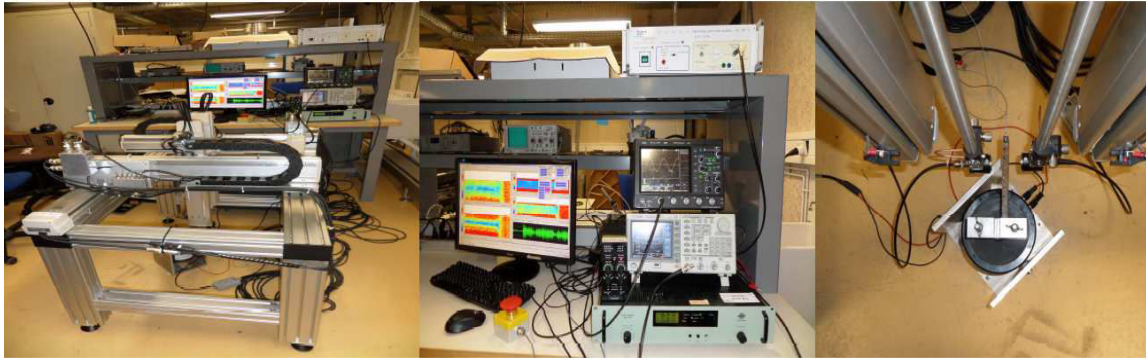
Figure 4.1 : Système d'imagerie par ultrasons aériens ayant servi à imager un béton polymère soumis à une résonance linéaire en flexion.
