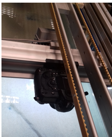
FIGURE 2.4 – Photo du Nikon D3S avec le spot d'éclairage en position au dessus du canal expérimental.
