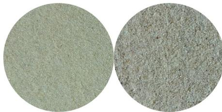
FIGURE 3.2 – Photos des sables  $S_{328}$  ( $D_{50} = 328\mu m$ ) et  $S_{617}$  ( $D_{50} = 617\mu m$ )
