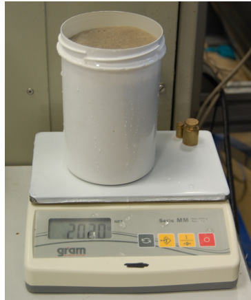
FIGURE 2.21 – Récipient+sable+ eau sur la balance
