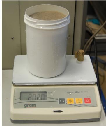
FIGURE 2.21 – Récipient+sable+ eau sur la balance
