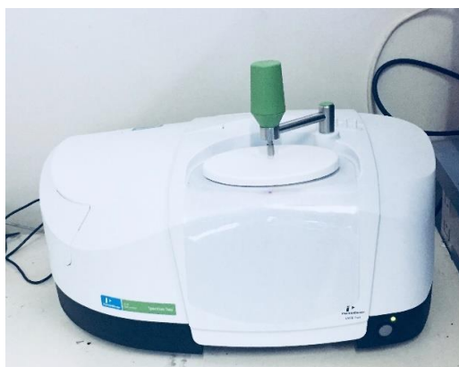
Figure 81 : Photographie du spectromètre infrarouge modèle Spectrum Two de PerkinElmer
