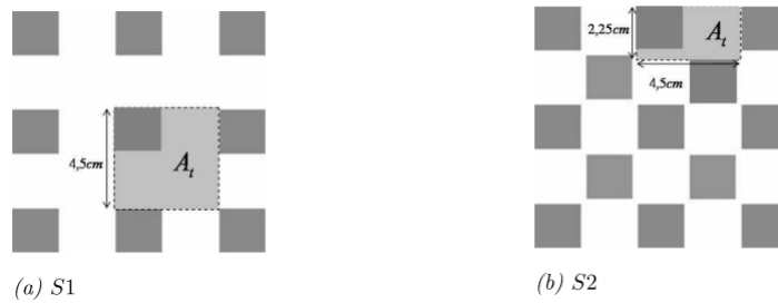
Figure 3.8 : Expériences de Florens : différentes dispositions des cubes [5].
