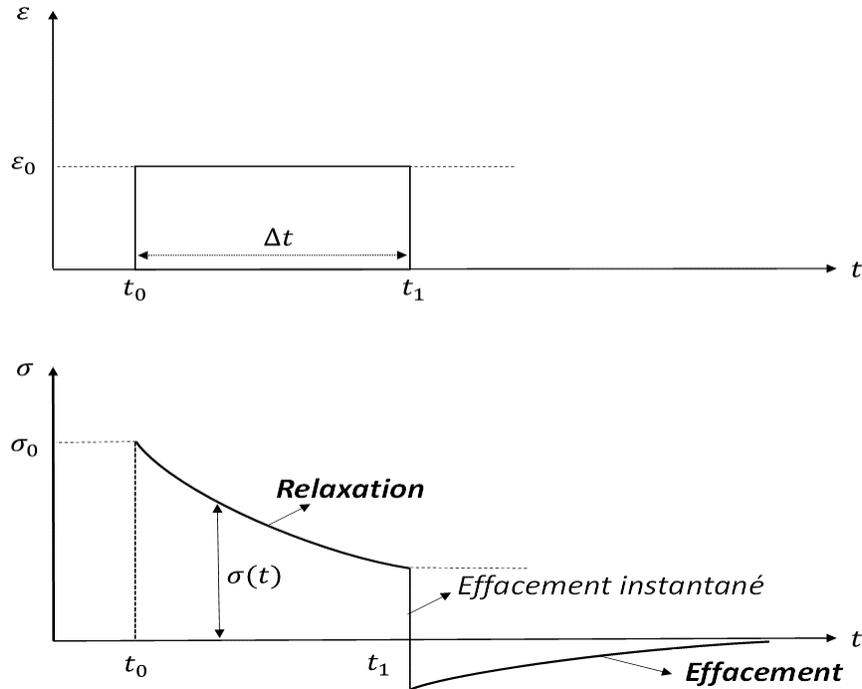
FIGURE 1.9 – Représentation de l'essai de Relaxation-Effacement
