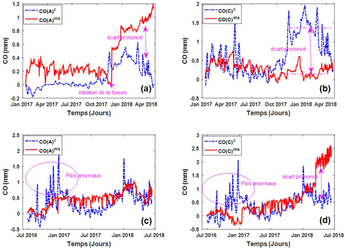
FIGURE 3.18 – comparaisons des évolutions des ouvertures de fissures calculées ( $CO^{(c)}$ ) et mesurées ( $CO^{(ms)}$ ) sur les PE S12 et D6 : (a) ouverture observée sur la face A de la PE S12 ; (b) ouverture observée sur la face C de la PE S12 ; (c) ouvertures observées sur la face A de la PE D6 ; ouverture observée sur la face C de la PE D6.
