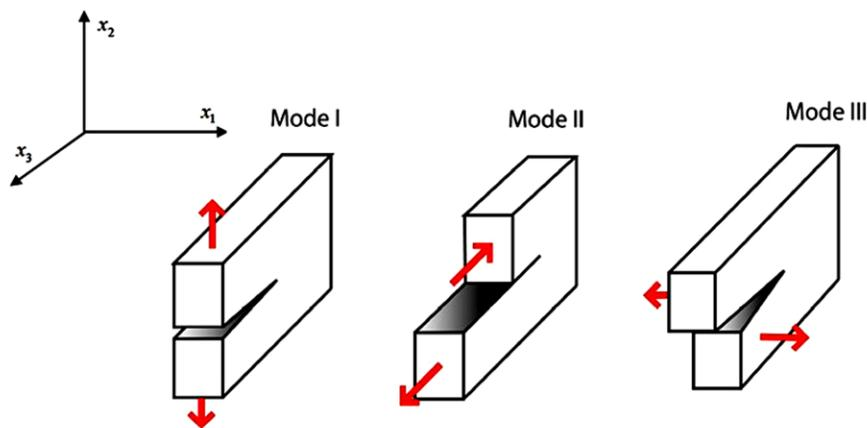
FIGURE 1.16 – Modes de sollicitation d’une fissure
