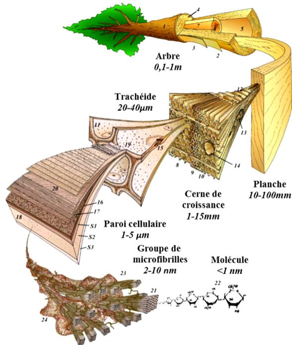
FIGURE 1.1 – Schéma multi-échelles d'un bois tempéré [1].
