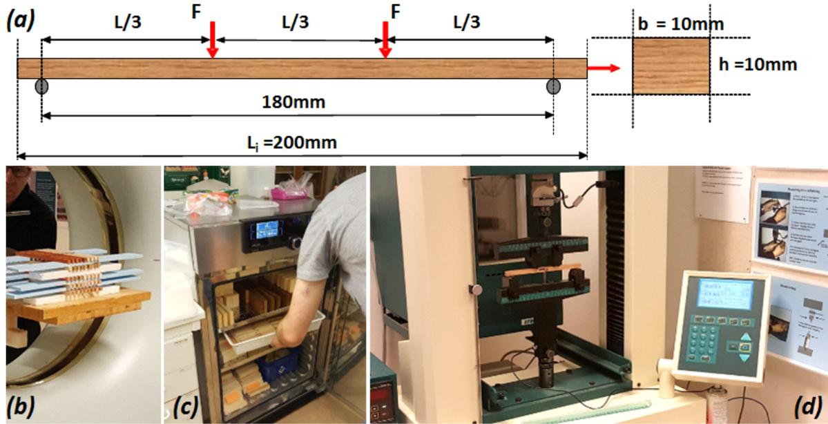
FIGURE 4.7 – Étapes suivies pour la caractérisation des éprouvettes; (a) Dimensions des éprouvettes ( $L_i$  : longueur totale de l'éprouvette;  $L$  : distance entre les appuis de la presse;  $b$  : épaisseur;  $h$  : hauteur); (b) Scan des éprouvettes par l'intermédiaire d'un CT-Scanner; (c) Conditionnement des éprouvettes dans une chambre climatique; (d) Essais de flexion 4-points des éprouvettes jusqu'à rupture.
