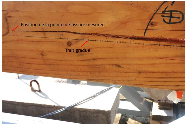
FIGURE 2.26 – Type de fissure observée (CD1B).
