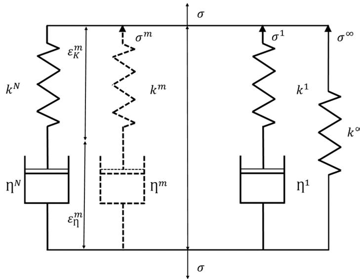
FIGURE 1.10 – Représentation du modèle de Maxwell généralisé
