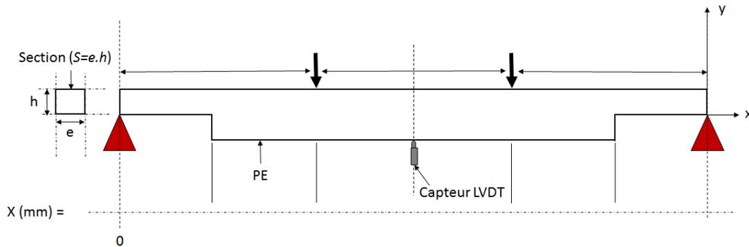
FIGURE 4.13 – Dispositif expérimental et géométrie des poutres arrêtées.
