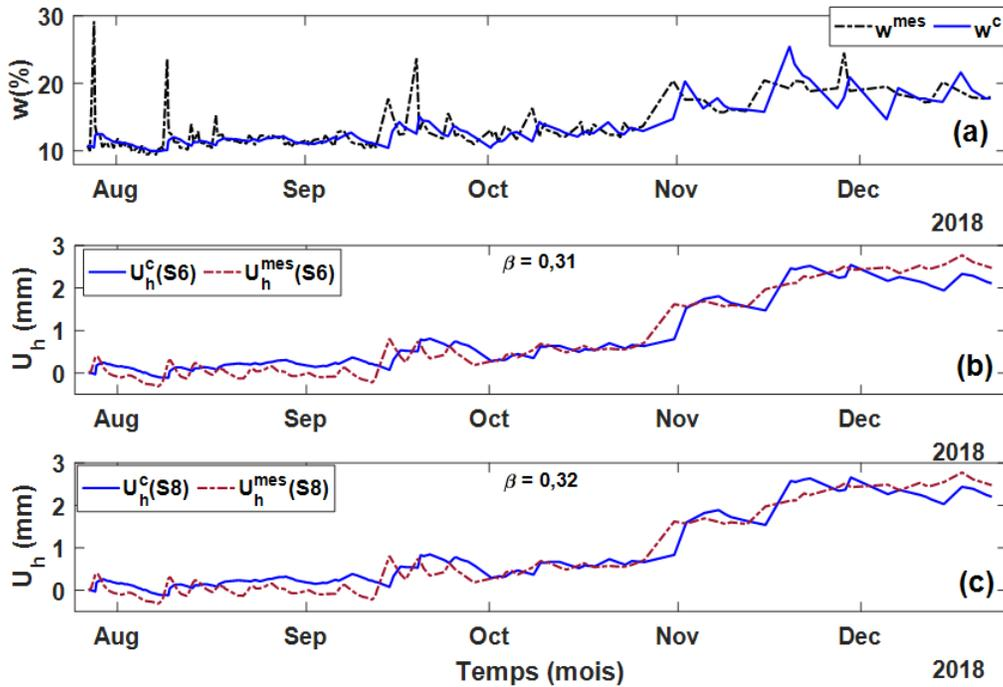
FIGURE 3.11 – Évolutions du déplacement hydrique calculé ( $U_h^c$ ) et mesuré ( $U_h^{mes}$ ) en fonction de l'humidité interne de la poutre témoin  $S0$  : (a) Évolutions des  $w^{mes}$  et  $w^c$  ; (b) Évolutions des  $U_h$  de  $S6$  ; (c) Évolutions des  $U_h$  de  $S8$ .
