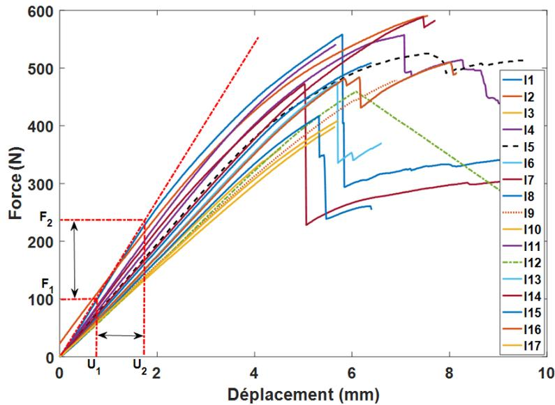
FIGURE 4.10 – Courbes force-déplacement des éprouvettes du groupe *I*.
