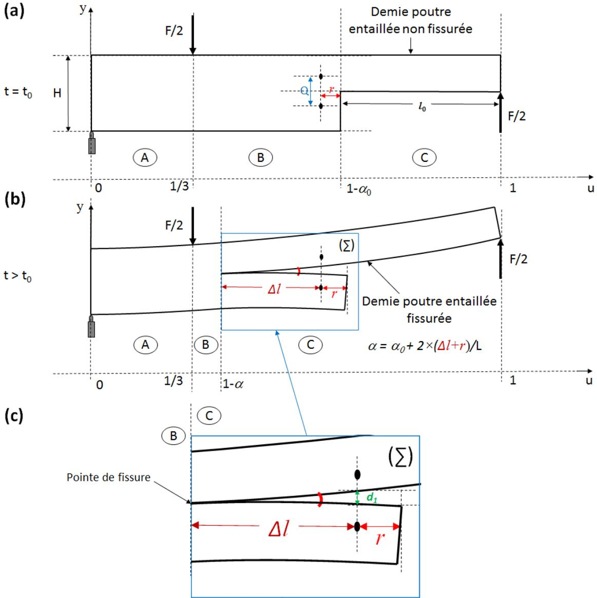
FIGURE 3.15 – Démie PE en flexion 4-points : (a) demi PE non fissurée à  $t = t_0$ , début du chargement ; (b) demi PE fissurée à  $t > t_0$  ; (c) zoom réalisé de la surface  $(\Sigma)$  contenant la pointe de la fissure.
