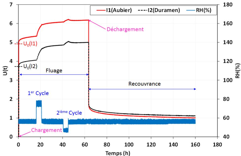
FIGURE C.5 – Comportement viscoélastique des éprouvettes d'Iroko.
