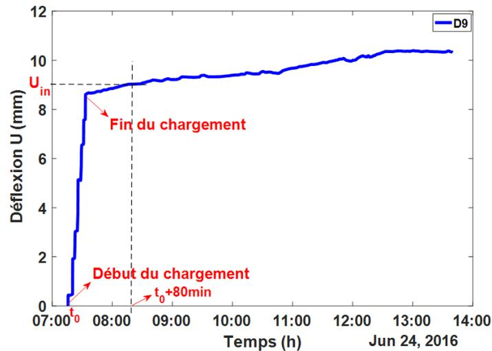
FIGURE 2.10 – Méthode de détermination du déplacement initial  $U_{in}$
