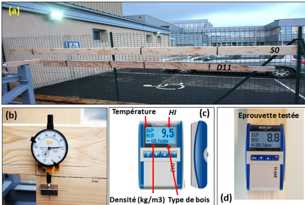
FIGURE 2.7 – Suivi de l'évolution des paramètres de fissuration et de  $HI$  durant la phase des essais différés : (a) Poutres témoins utilisées  $D11$  et  $S0$ ; (b) Comparateur; (c) et (d) Principe de fonctionnement de l'humidimètre type MERLIN.
