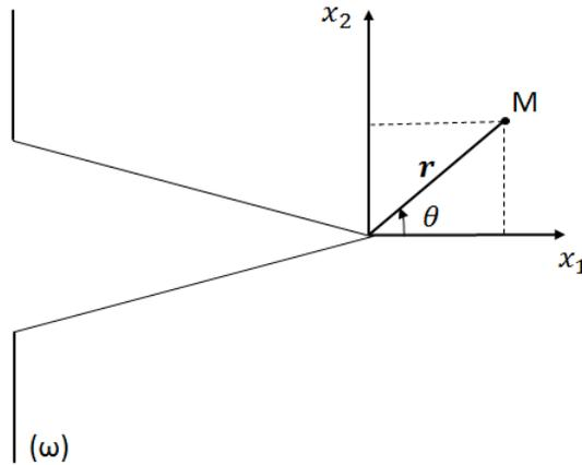
FIGURE 1.18 – Coordonnées polaires en pointe de fissure [9]
