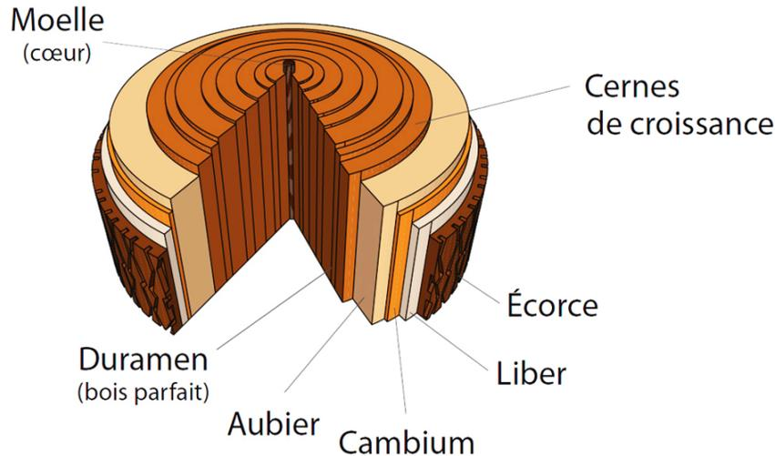
FIGURE 1.5 – Coupe transversale d'un tronc d'arbre
