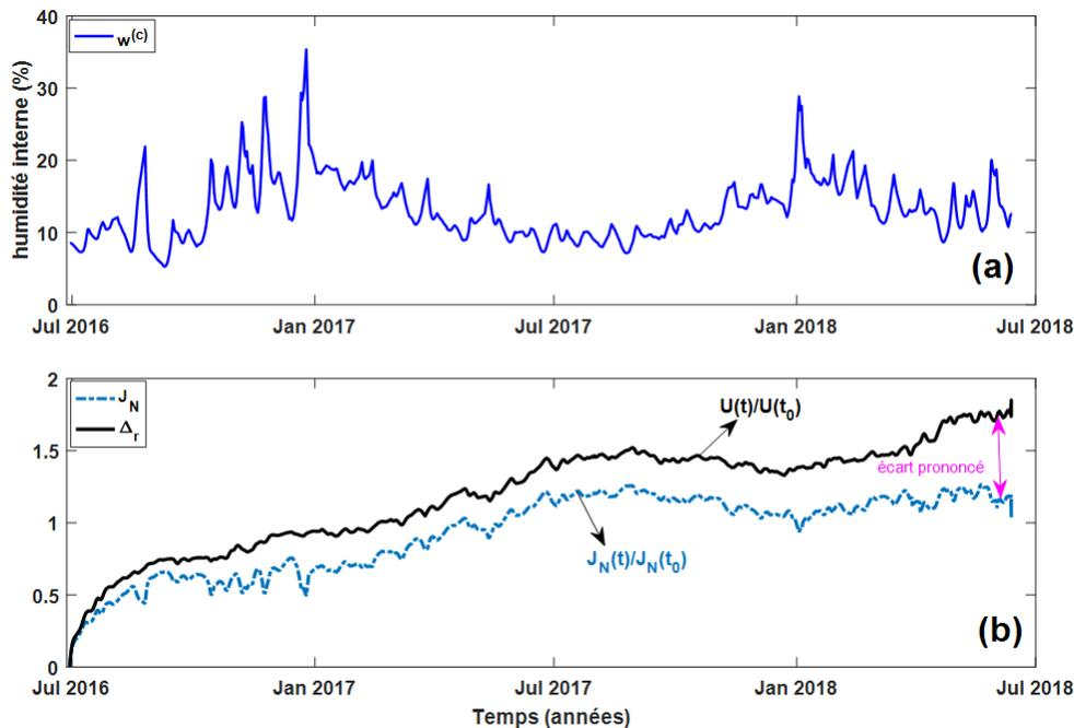
FIGURE 3.19 – Évolution dans le temps de  $\Delta_r$  et de  $J_N$  en fonction de  $w^{(c)}$  de  $S0$  (C.f. Chapitre 2) : (a) courbe des variations de  $w^{(c)}$ ; (b) courbes de  $\Delta_r$  et  $J_N$  de la PE  $D6$ .
