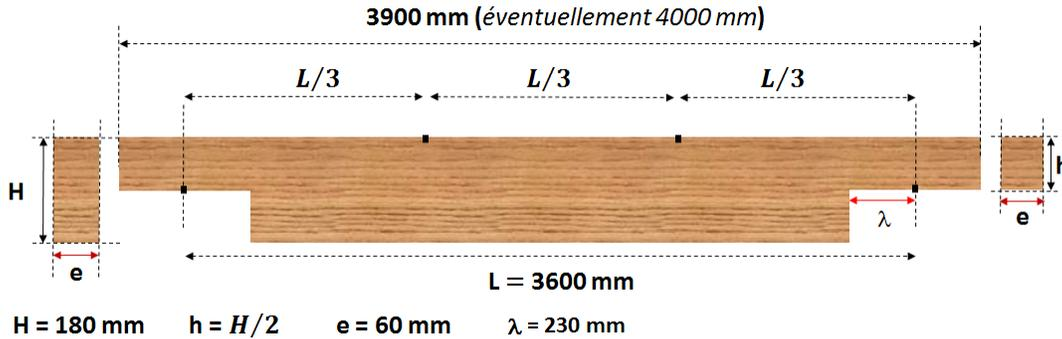
FIGURE 1.20 – Configuration géométrique de la PE étudiée.
