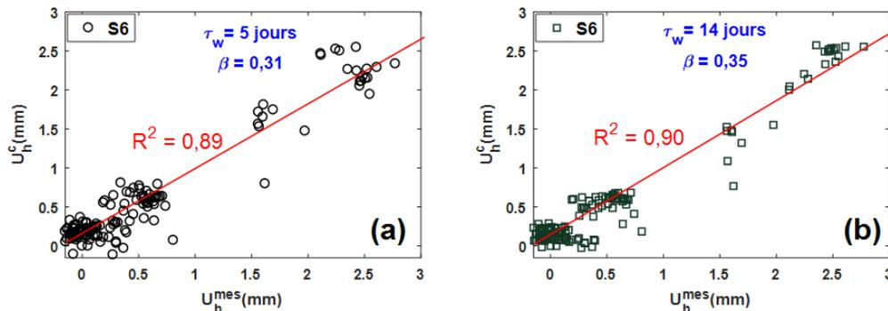
FIGURE 3.9 – Courbes des comparaisons effectuées entre les déplacements hydriques mesurés ( $U_h^{mes}$ ) et calculés ( $U_h^c$ ) de la PE S6 : (a) pour  $\tau_w = 5$  jours ; (b) pour  $\tau_w = 14$  jours.
