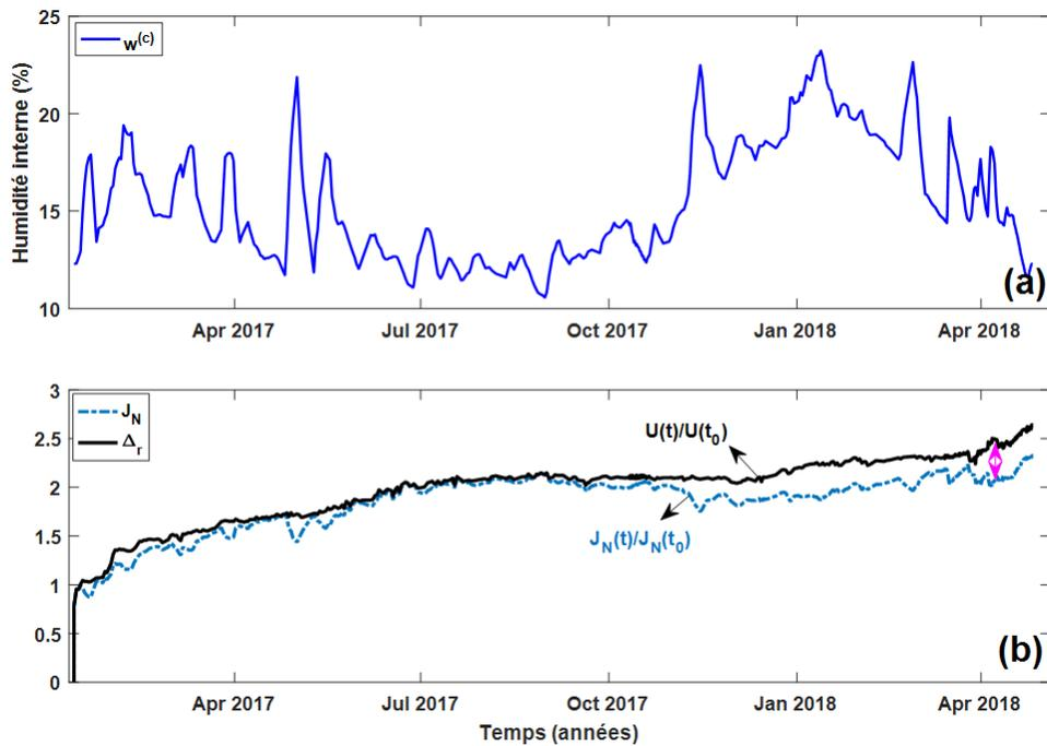
FIGURE 3.20 – Évolution dans le temps de  $\Delta_r$  et de  $J_N$  en fonction des variations de  $w^{(c)}$  de  $D11$  (C.f. Chapitre 2) : (a) courbe des variations de  $w^{(c)}$  ; (b) courbes des évolutions de  $\Delta_r$  et  $J_N$  de la PE  $S12$ .
