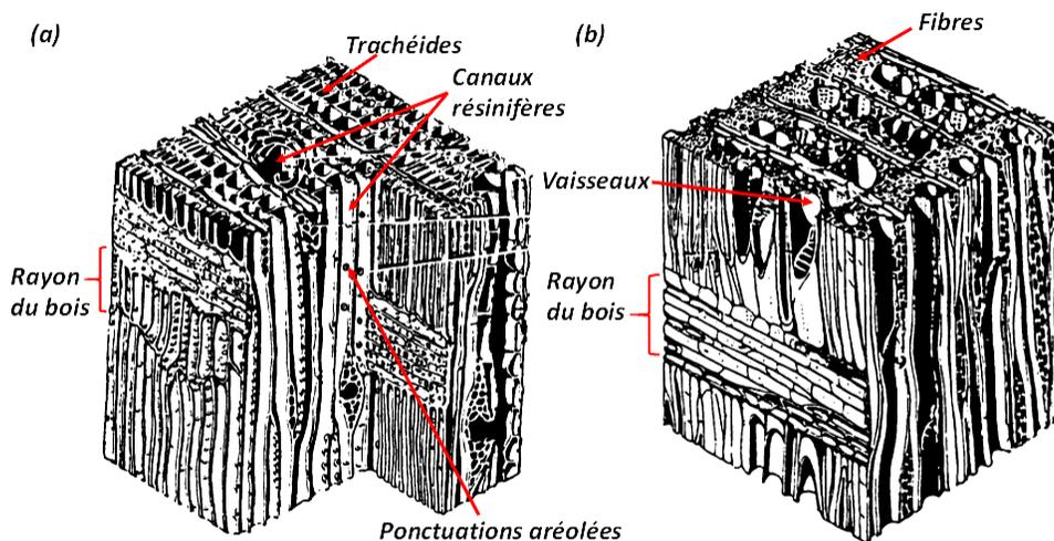
FIGURE 1.4 – Schéma des structures cellulaires d'un résineux (a) et d'un feuillu (b) [2].
