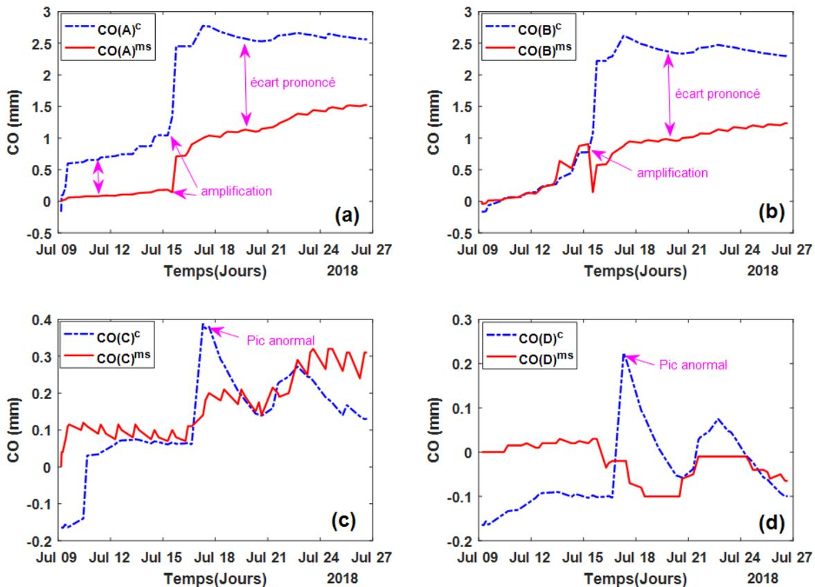
FIGURE 3.17 – comparaisons des évolutions des ouvertures de fissures calculées ( $CO^{(c)}$ ) et mesurées ( $CO^{(ms)}$ ) sur la PE D1 : (a) ouverture observée sur la face A ; (b) ouverture observée sur la face B ; (c) ouverture observée sur la face C ; ouverture observée sur la face D.
