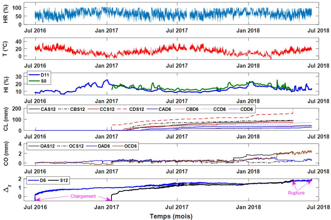
FIGURE 2.19 – Évolutions des paramètres mesurés sur les PE  $D6$  et  $S12$  : HR : humidité relative ;  $T$  : température ; HI : humidité interne (des poutres témoins) ; CL : longueur de la fissure ; CO : ouverture de la fissure ;  $\Delta_r$  : flèche relative tirée de Eq. 2.7.
