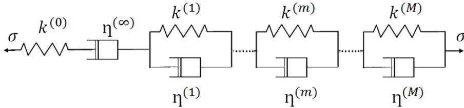
FIGURE 1.11 – Représentation du modèle de Kelvin Voigt généralisé
