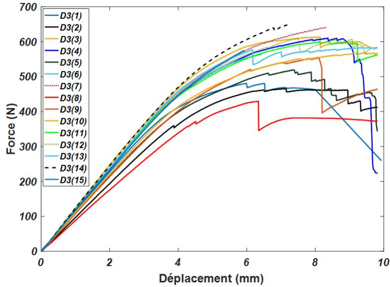
FIGURE 4.9 – Courbes force-déplacement des éprouvettes du groupe *D3*.
