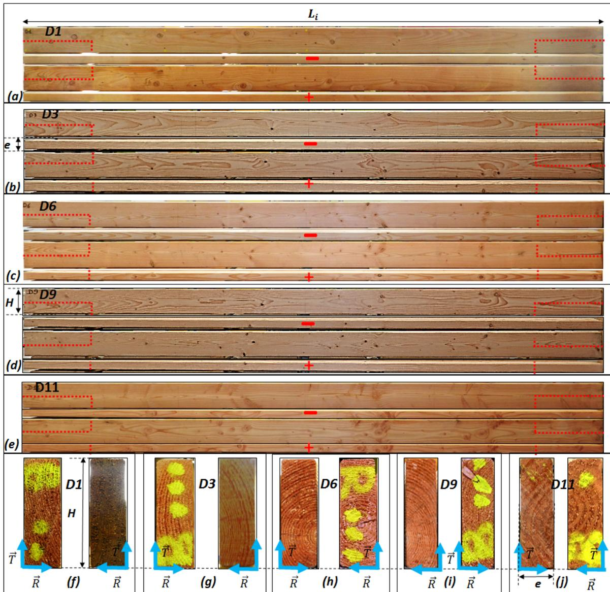
FIGURE 2.2 – Surfaces externes des poutres de Douglas ( $D$ ) utilisées : (a,f) poutre  $D1$  ; (b,g) poutre  $D3$  ; (c,h) poutre  $D6$  ; (d,i) poutre  $D9$  ; (e,j) poutre  $D11$ . Pour la légende voir Fig. 2.1.
