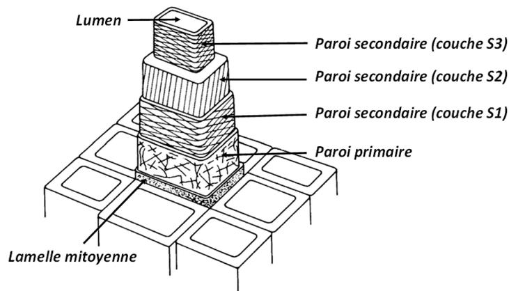
FIGURE 1.2 – Schéma d'une paroi cellulaire [2].
