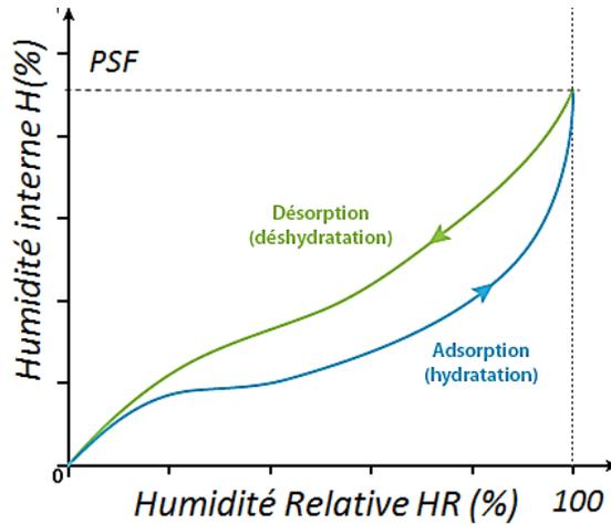
FIGURE 1.13 – Schématisation de l’hystérésis de sorption
