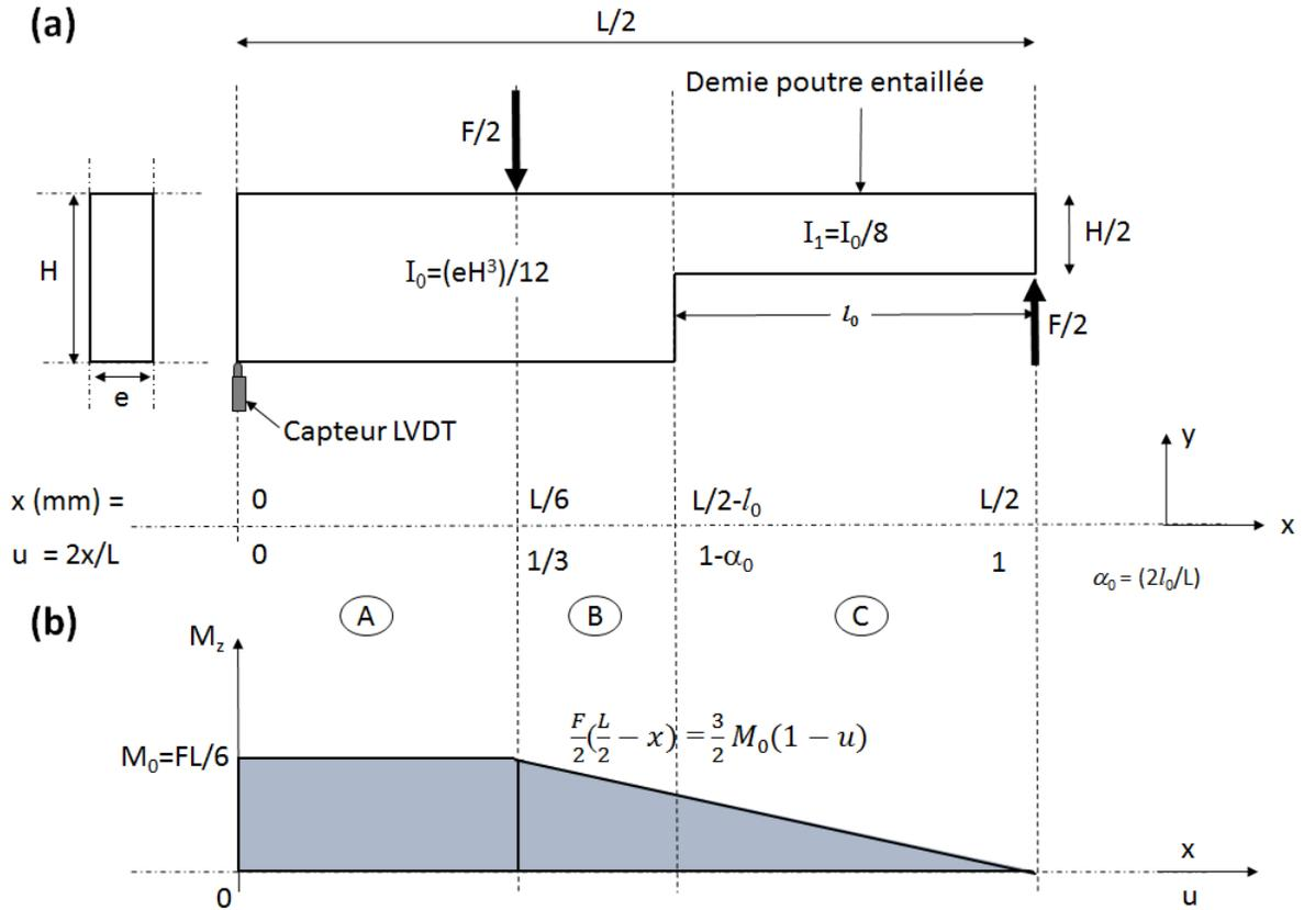
FIGURE 3.5 – (a) Demi poutre entaillée en flexion 4-points; (b) Diagramme des moments fléchissants de la demi PE.
