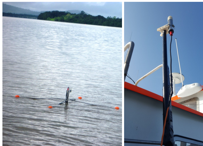
Figure 3.7. Le système TriOS-RAMSES in-water (Radeau) utilisé pour l'acquisition de la couleur de l'océan durant les campagnes en mer composé du capteur TriOS-RAMSES mesurant la luminance ascendante en dessous de la surface marine L_u(\lambda) (à gauche) et du capteur TriOS-RAMSES mesurant au-dessus de la surface marine l'éclairement descendant E_d(\lambda) (à droite).
