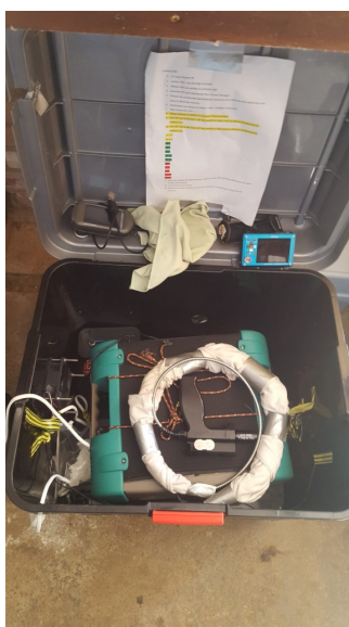
Figure 3.2. Le spectro-radiomètre ASD FieldSpec 4 utilisé pour l'acquisition de la couleur de l'océan durant les campagnes en mer.
