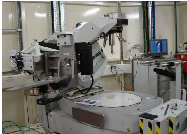
FIGURE 3.8 – Diffractomètre 6-cercles de la ligne CRISTAL à SOLEIL.
