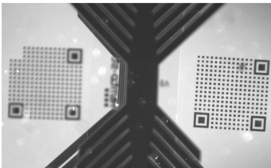
FIGURE 7.1 – Illustration de deux mires "QR-Code" intégrées à des microcomposants plans à assembler (les mires sont ici dans deux plans différents).
