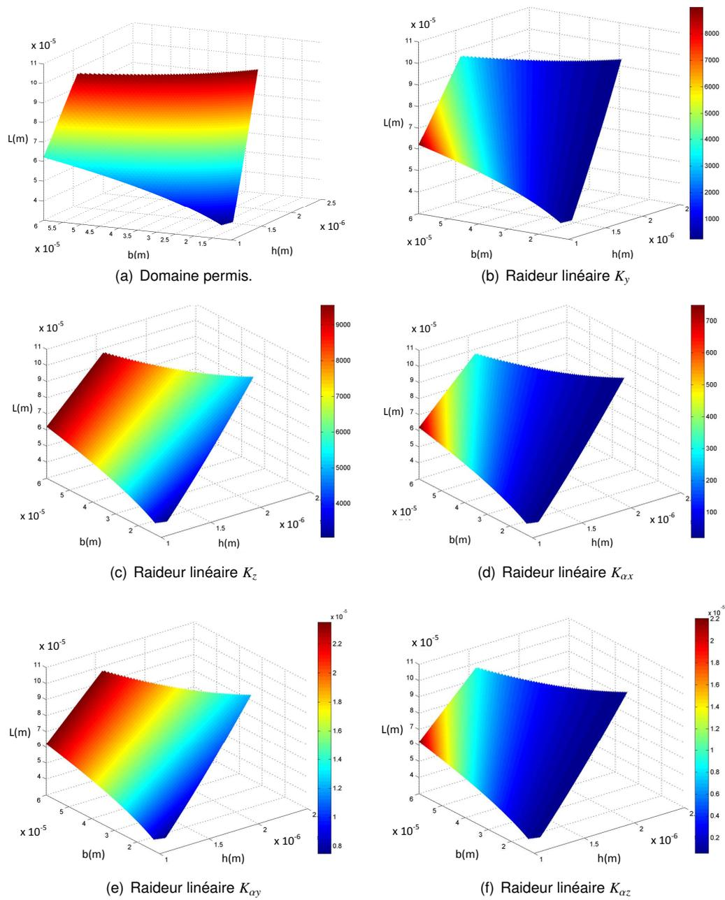
FIGURE D.11 – Analyse des variations des raideurs linéaires  $K_y$ ,  $K_z$ ,  $K_{\alpha_x}$ ,  $K_{\alpha_y}$  and  $K_{\alpha_z}$  en parcourant le domaine des paramètres géométriques possibles ( $L$ ,  $b$ ,  $h$ ) après prise en compte de plusieurs critères.
