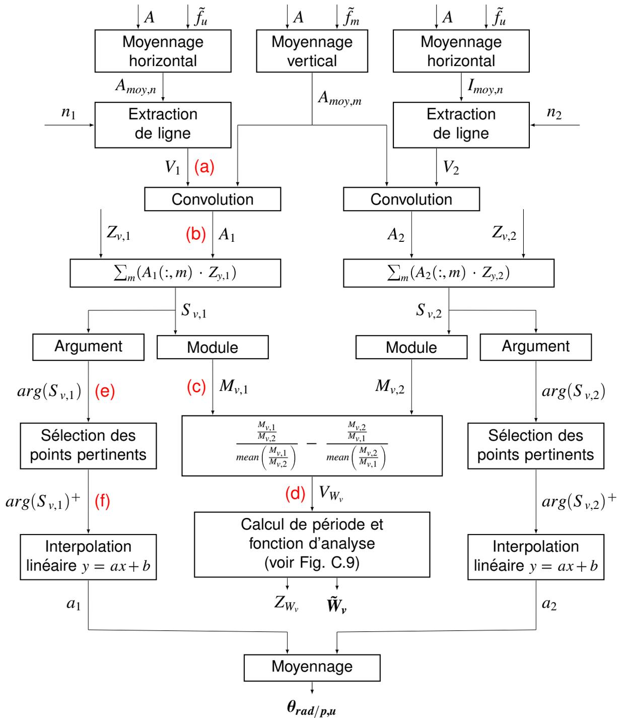
FIGURE C.10 – Algorithme de calcul de  $\tilde{W}_v$  et  $\theta_{rad/p,u}$ . Les lettres en rouge font référence à la figure C.11. L'algorithme symétrique permet de trouver  $\tilde{W}_v$  et  $\theta_{rad/p,u}$ .
