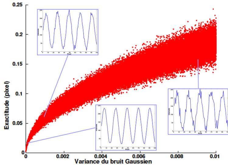
FIGURE 2.9 – Simulation : Exactitude ( $3\text{-}\sigma$ ) de mesure de position d'un signal sinusoïdal 1D suivant le niveau de bruit qui lui est appliqué. La simulation étant réalisée sur un signal parfait subissant un bruit gaussien de moyenne 0 et de variance variable (entre 0 et 0.01). Trois courbes représentatives d'une partie du vecteur d'intensité sont ajoutées, pour des variances de 0.0001, 0.001 et 0.009.
