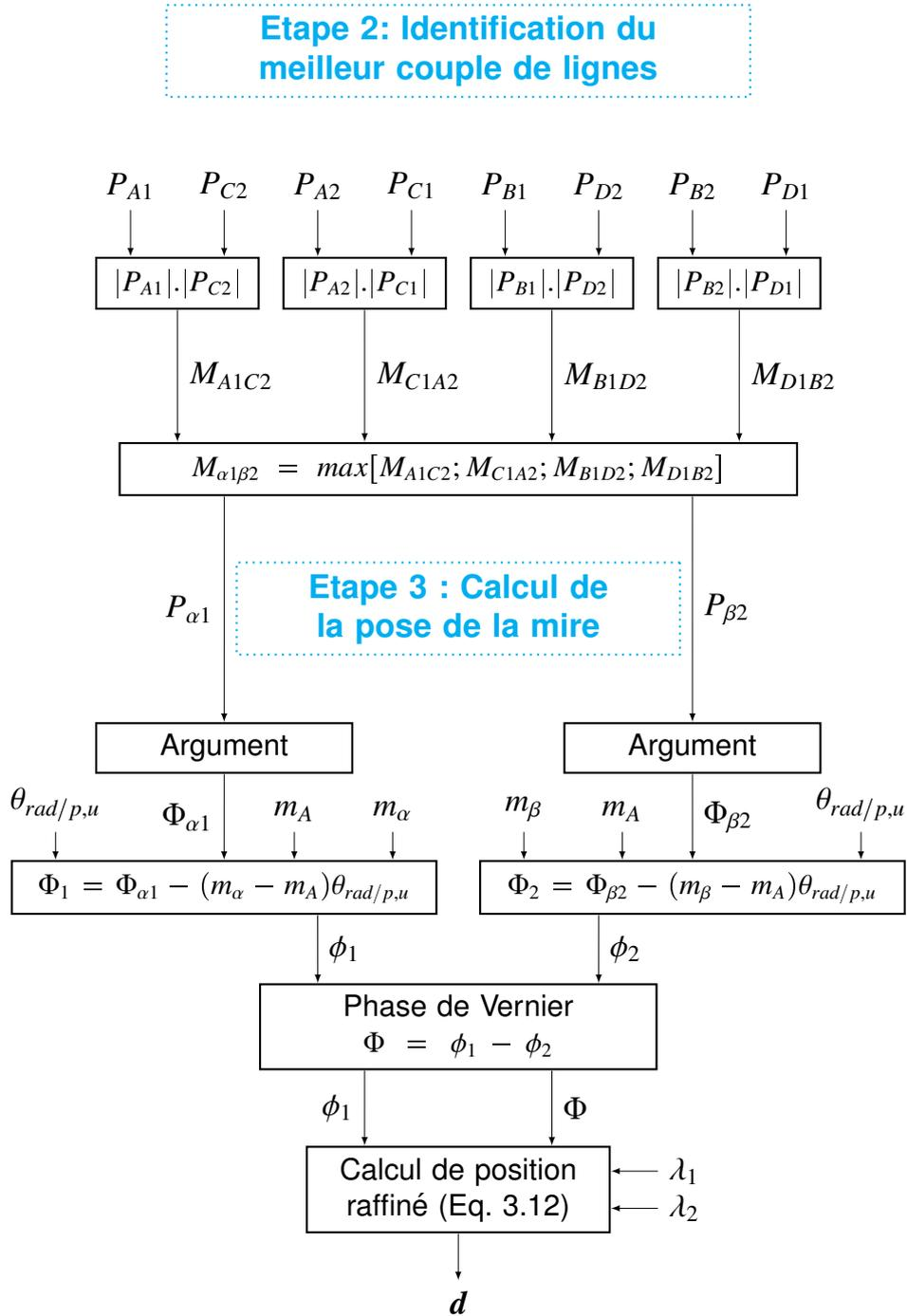
FIGURE C.7 – Algorithme de mesure de position d’une mire de Vernier 2D, deuxième et troisième étape. La mesure se fait ici suivant l’axe  $\vec{u}$ ; l’algorithme est à répéter suivant l’axe  $\vec{v}$ .
