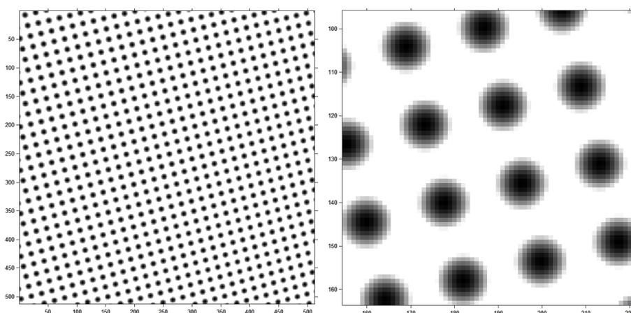
FIGURE 6.6 – Mire périodique 2D ( $\lambda = 1$  mm) simulée pour un modèle sténopé ( $\bar{f} = 20$  mm ;  $\bar{n}_0 = \bar{m}_0 = 3.2$  mm ;  $\bar{k}_n = \bar{k}_m = 100$  mm<sup>-1</sup> ; dimension 640 × 640 pixels).
