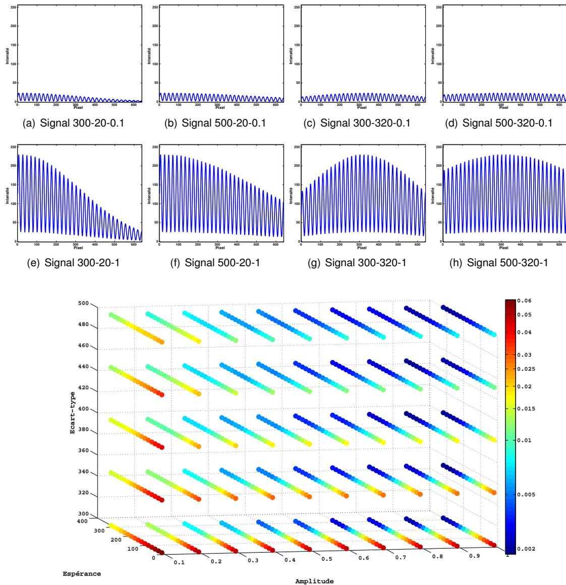
FIGURE B.8 – Simulation : Exactitude ( $3\text{-}\sigma$ ) de mesure de position d'un signal sinusoïdal 1D filtré par une gaussienne d'espérance, centre et intensité variables. Rapporté au cas des mire, la finalité est de simuler des variations d'éclairage telles qu'elles ont pu être observées empiriquement. 8 signaux représentatifs de cas extrêmes de modification par la gaussienne sont représentés en figures (a) à (h), nommés par leur écart-type-espérance-amplitude.
