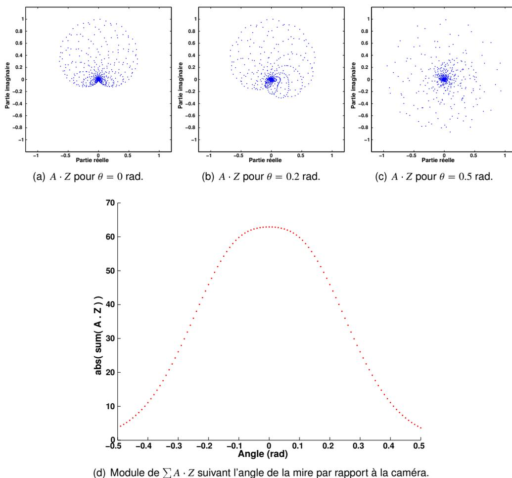
FIGURE E.1 – Observation de l'effet d'une variation d'angle hors-plan d'une mire 1D sur la convolution  $A \cdot Z$ . En considérant la somme des valeurs du vecteur résultant, on observe que sa phase varie peu mais surtout que son module décroît rapidement avec la différence d'angle entre  $Z$  et  $A$ . (a-c) représentations dans le plan complexe de  $A \cdot Z$  suivant la valeur de  $\theta$ ; (d) valeur du module  $r$  suivant  $\theta$ .
