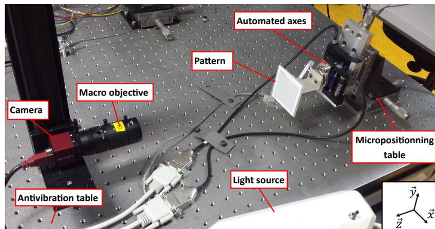
FIGURE 4.5 – Dispositif expérimental pour l'asservissement visuel.
