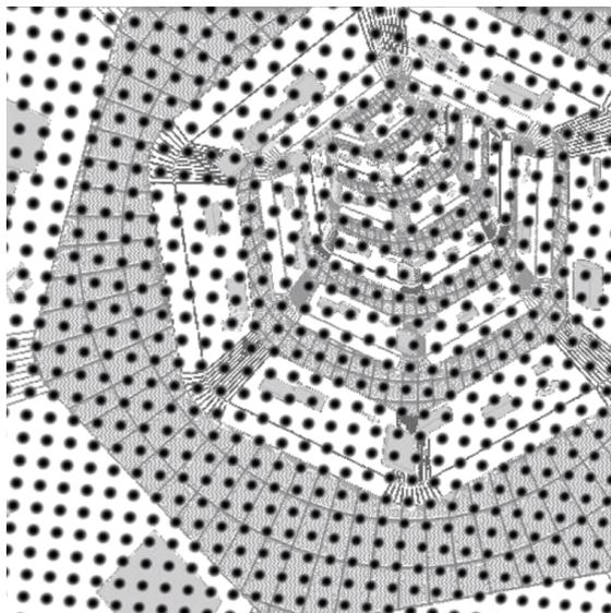
FIGURE E.2 – Mire périodique 2D ( $\lambda = 1$  mm) simulée pour un modèle sténopé ( $f = 20$  mm ;  $n_0 = m_0 = 3.2$  mm ;  $k_n = k_m = 100$  mm<sup>-1</sup> ; dimension 640 × 640 pixels) soumise à un bruit variable.
