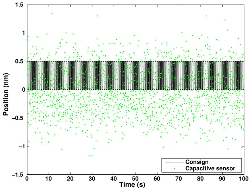
(a) Consigne envoyé à l'actionneur (période : 1 s) et mesure du capteur capacitif.
