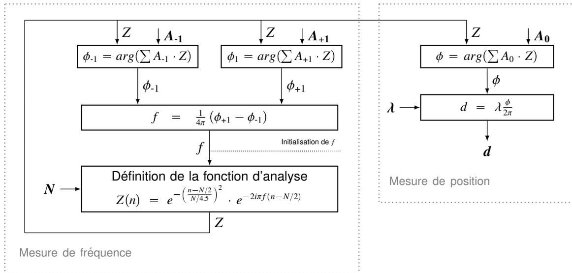
FIGURE 4.1 – Algorithme itératif de mesure de position  $d$  et de fréquence  $f$  d'un signal périodique discret  $A_0$  de taille  $N$ .  $A_{-1}$  et  $A_{+1}$  correspondent à  $A_0$  décalés d'un pixel vers l'avant ou l'arrière (et complété avec un zéro).
