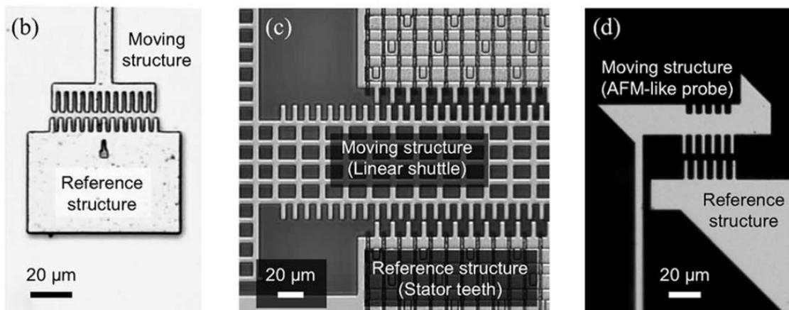
FIGURE 1.8 – Structures périodiques utilisées dans [30] pour réaliser une mesure de position via la mesure de phase.
