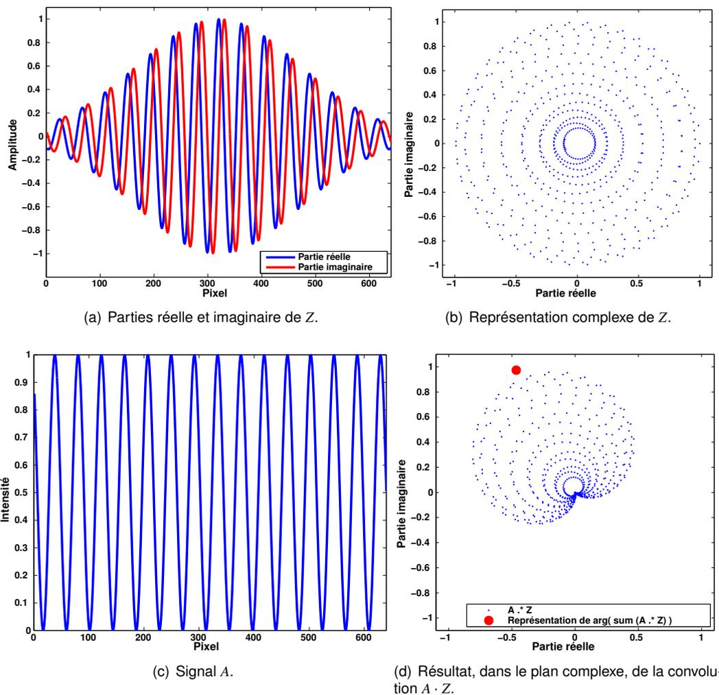
FIGURE 2.4 – Représentation d'un signal 1D  $A$  (de période 42.246 pixels) et de la fonction d'analyse  $Z$  associée (avec  $c = 4.5$ , un choix justifié en annexe B.2). La phase est obtenue par l'angle de la somme du vecteur résultant de la convolution de  $A$  et  $Z$ .
