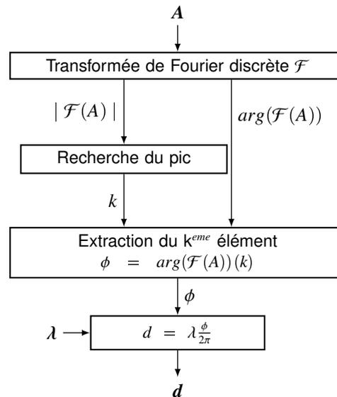
FIGURE 3.1 – Algorithme initial de mesure de position  $d$  d'un signal périodique discret  $A$ . Cette méthode présente deux grands défauts : (1) elle implique de faire une transformée de Fourier du signal à chaque itération et (2) la recherche du pic est une méthode grossière de mesure de la fréquence du signal, ce qui implique que la phase sera donnée le plus souvent avec une erreur due à l'erreur sur l'estimation de la fréquence.
