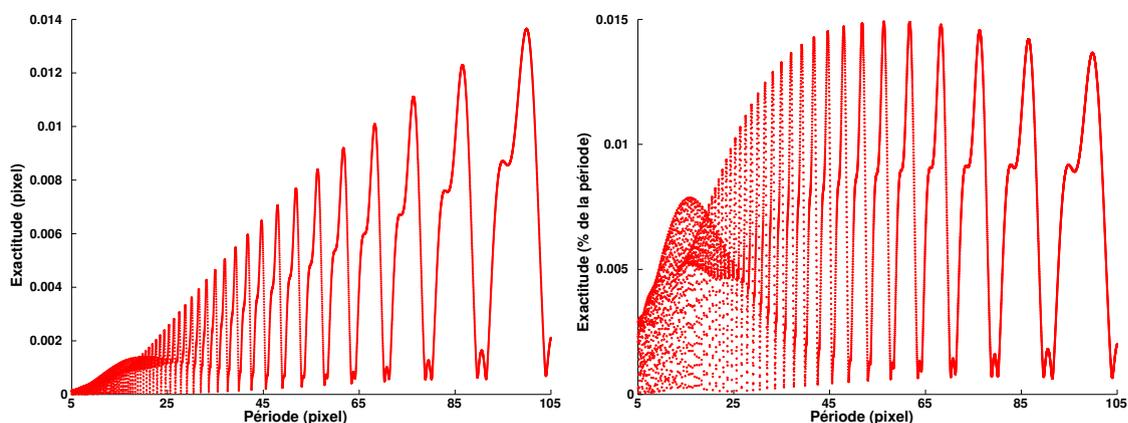
FIGURE 2.6 – Simulation : exactitude ( $3\text{-}\sigma$ ) de mesure de position d'un signal sinusoïdal 1D (non quantifié) en translation, exprimée suivant la période (en pixel) du signal. La période du signal est considérée comme parfaitement connue. En haut : erreur pixellique ; en bas : erreur en pourcentage de la période.
