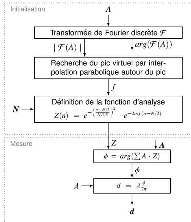
FIGURE 3.2 – Algorithme précis de mesure de position  $d$  d'un signal périodique discret  $A$ . La partie *Initialisation* peut n'être réalisée qu'une fois, en début de mesure (si la fréquence du signal est stable).
