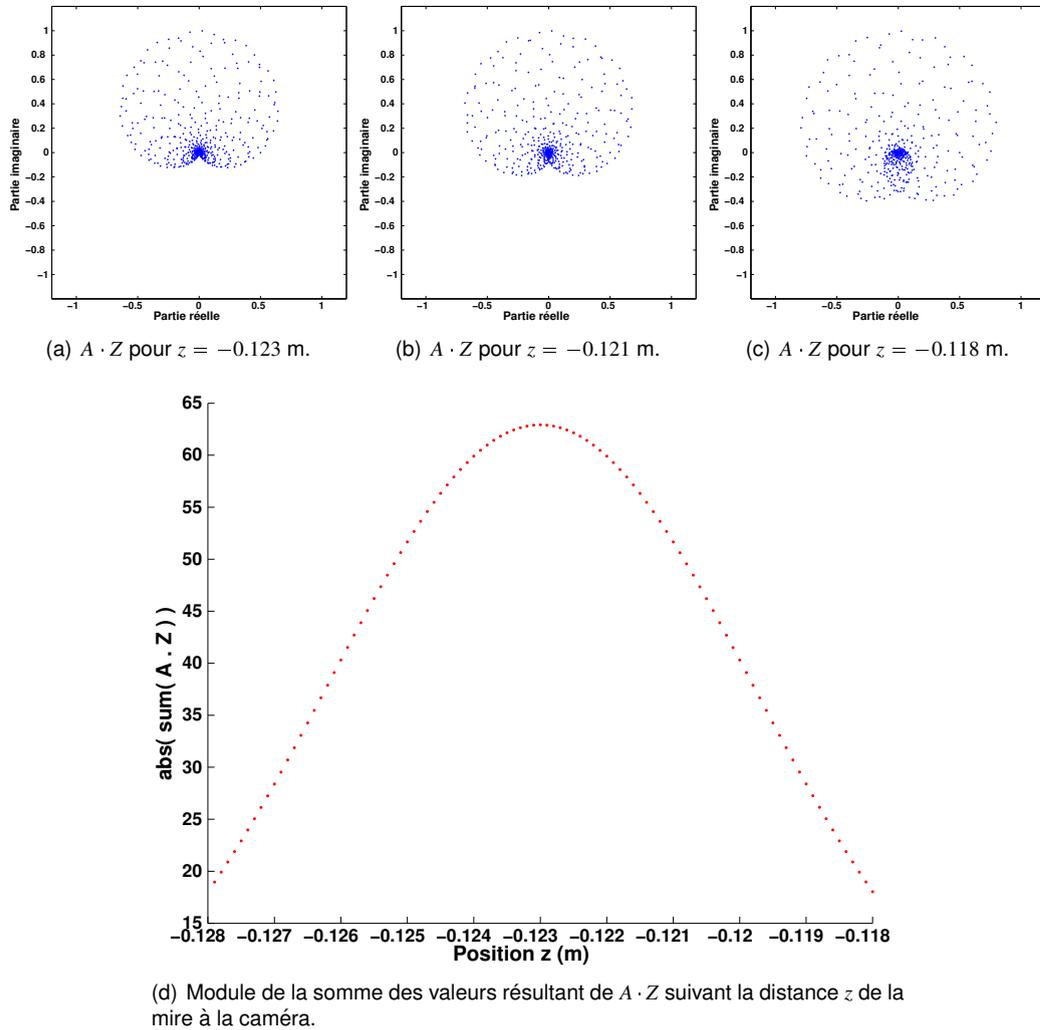
FIGURE 6.3 – Observation de l'effet d'une variation de position  $z$  (axe hors-plan) d'une mire 1D sur la convolution  $A \cdot Z$ . En considérant la somme des valeurs du vecteur résultant, on observe que sa phase varie peu mais surtout que son module décroît rapidement avec la différence de position  $z$  entre  $Z$  et  $A$ . (a-c) représentations dans le plan complexe de  $A \cdot Z$  suivant la valeur de  $z$ ; (d) valeur du module  $r$  suivant  $z$ .
