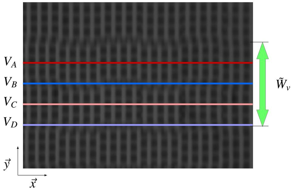
FIGURE C.5 – Représentation de la sélection des quatre lignes horizontales utilisées pour trouver la meilleure zone de travail pour la mesure de position suivant  $x$ . L'image est moyennée verticalement au préalable.  $V_A$  est choisie arbitrairement, les autres lignes sont espacées de  $\tilde{W}_v/4$ .
