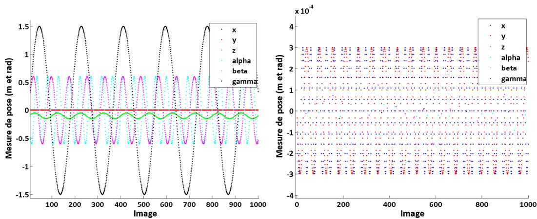
FIGURE 6.7 – Mesure de pose d'une mire périodique 2D ( $\lambda = 1$  mm) (en simulation).
