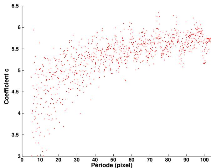
FIGURE B.2 – Simulation : Expression de l'écart-type optimal de la partie gaussienne de la fonction d'analyse pour la mesure en translation d'un signal sinusoïdal 1D suivant sa période, exprimé par  $c$  dans la formule choisie pour l'écart type :  $N/c$ .
