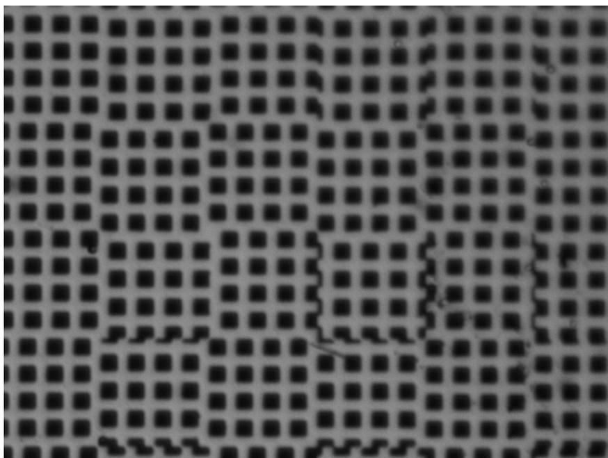
FIGURE 3.13 – Image typique de la mire de Vernier 2D fabriquée, telle que traitée pour la mesure ( $1280 \times 960$  pixels). Ici  $\lambda_{u,1} = \lambda_{v,1} = 8 \mu\text{m}$ ,  $\lambda_{u,2} = \lambda_{v,2} = 8.3 \mu\text{m}$ ,  $\Lambda_u = \Lambda_v = \Lambda = 221.33 \mu\text{m}$  et  $W_u = W_v = 32 \mu\text{m}$ .
