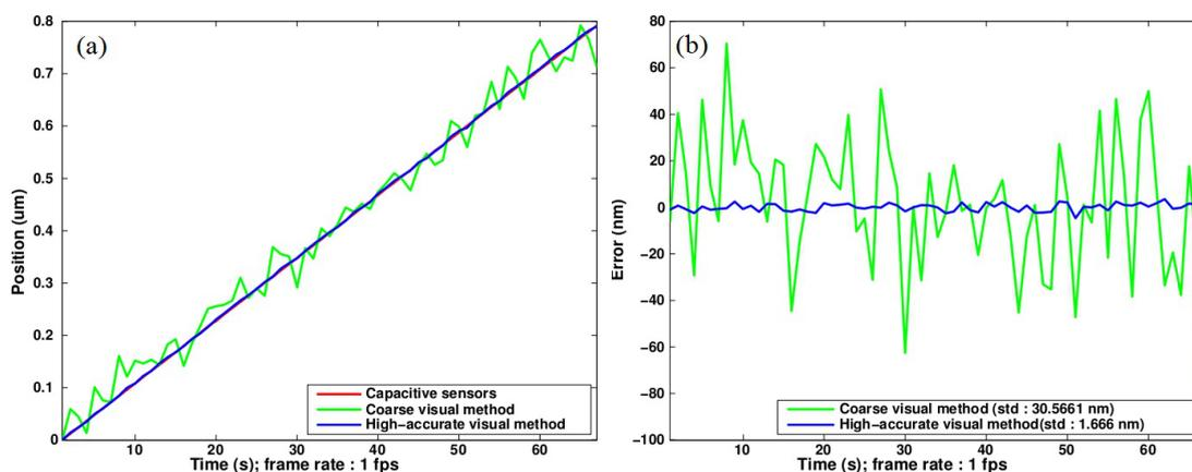
FIGURE 3.10 – Mesure du déplacement linéaire de la mire de Vernier 1D. (a) déplacement total; (b) erreur entre la mesure par vision et la référence (capteur capacitif).
