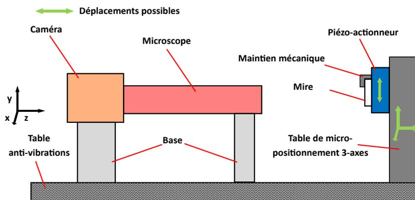
FIGURE 3.7 – Schéma de principe de la mesure par mire de Vernier 1D.
