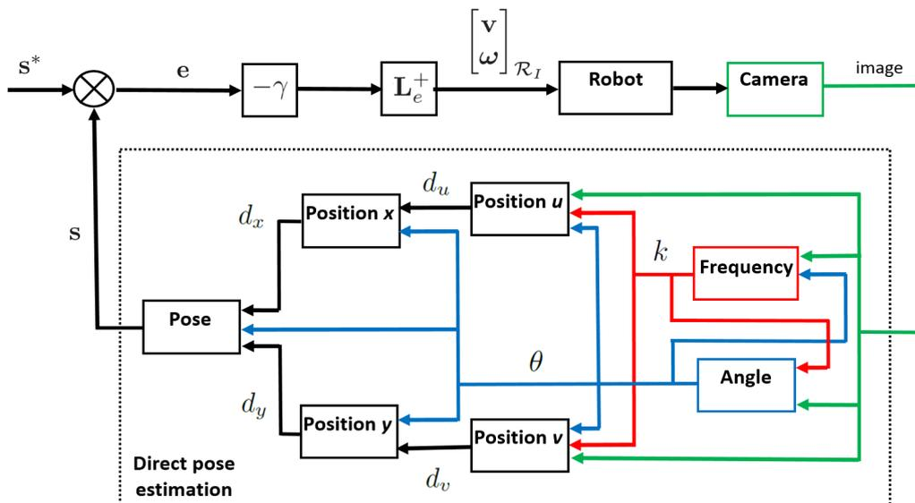
FIGURE 4.4 – Représentation de l'algorithme d'asservissement visuel.
