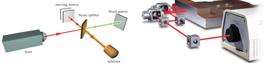
FIGURE A.3 – Interférométrie. A gauche, représentation d'un interféromètre de Michelson ; l'observation des interférences après division puis recombinaison du laser permet d'évaluer la position relative des miroirs. A droite, exemple d'interféromètre à deux axes de Zygo (USA), permettant une mesure 2 DDL (2 translations converties en 1 translation et 1 rotation).
