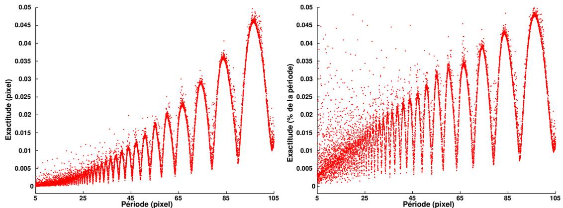
FIGURE 2.8 – Simulation : exactitude ( $3\text{-}\sigma$ ) de position pixellique maximale d'un signal sinusoïdal 1D en translation, exprimé suivant la période (en pixel) du signal. La période du signal est considérée comme parfaitement connue.
