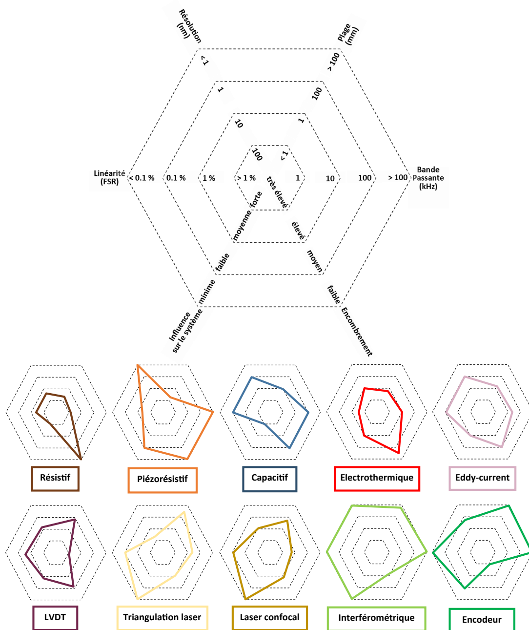
FIGURE 1.1 – Comparaison des performances de différents types de capteurs de position utilisables en microrobotique, hors vision. Les valeurs sont prises pour être représentatives des performances hautes de l'état de l'art. Ces capteurs ne réalisent habituellement des mesures que suivant une unique direction.
