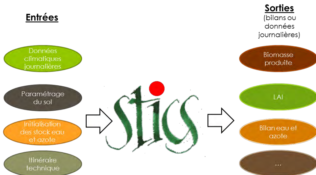
Figure 17 : Schéma simplifié des entrées (gauche) et sorties du modèle STICS (droite)
