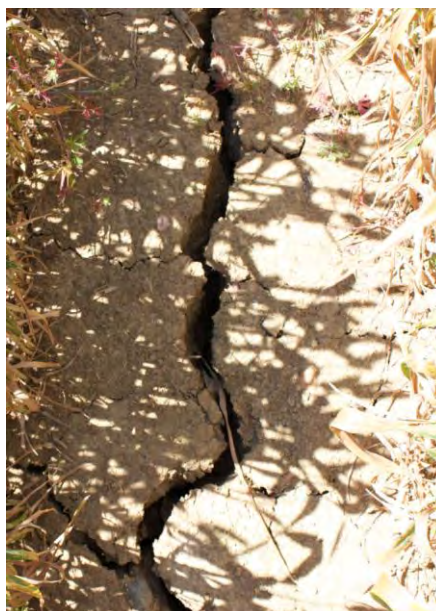
Figure 14: Photographie d'une fente de retrait sur Auradé parcelle Flux. Photo réalisée en juin 2014.
