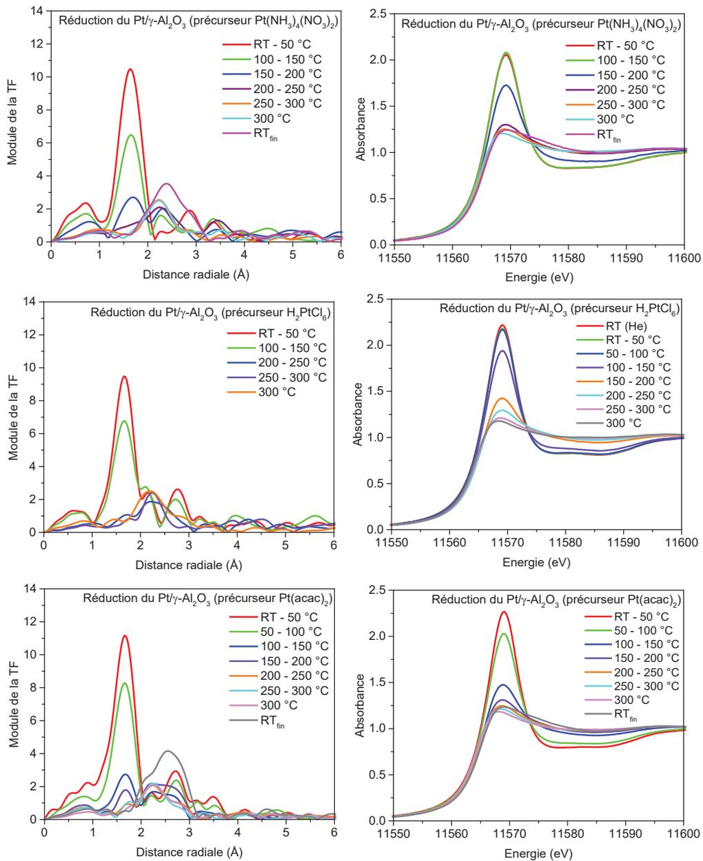
Figure 81. Suivi XAS de la réduction sous H<sub>2</sub> du catalyseur Pt/γ-Al<sub>2</sub>O<sub>3</sub> calciné préparé à partir de Pt(NH<sub>3</sub>)<sub>4</sub>(NO<sub>3</sub>)<sub>2</sub>, H<sub>2</sub>PtCl<sub>6</sub> et Pt(acac)<sub>2</sub>.
