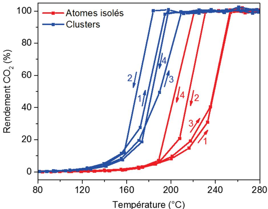
Figure 68. Rendement en CO<sub>2</sub> pour le catalyseur 0,1 %m Pt/γ-Al<sub>2</sub>O<sub>3</sub> en COOX10 au cours de la séquence C300/COOX10 a (atomes isolés)/R300/COOX10 b (clusters). La légende indique la nature de la population principale. La présence de quelques atomes isolés après R300/COOX10 n'est pas exclue.
