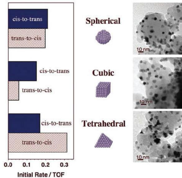
Figure 21. Effet de la forme des nanoparticules de platine dans des catalyseurs Pt/SiO<sub>2</sub> sur la réaction d'isomérisation du 2-butène.<sup>148</sup>
