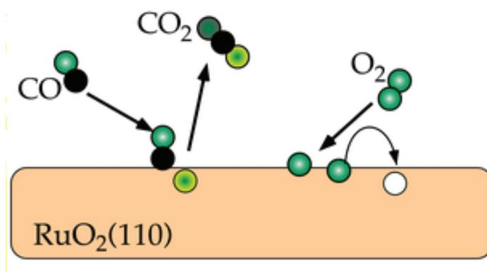
Figure 24. Oxydation du CO via un mécanisme de type Mars Van Krevelen sur un catalyseur modèle  $RuO_2$ .<sup>184</sup>
