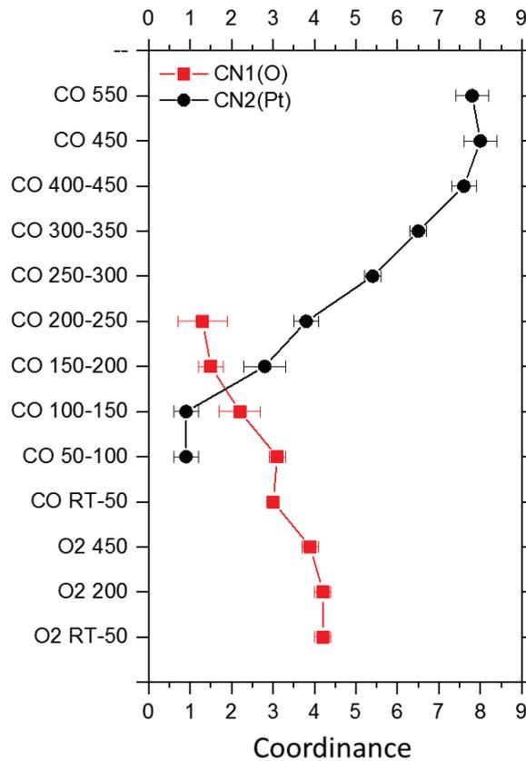
Figure 85. Evolution du nombre et de la nature des premiers voisins dans le catalyseur 0,3 %m Pt/γ-Al<sub>2</sub>O<sub>3</sub> au cours d'une calcination sous air (de RT à 300 ou 450 °C) suivie d'un traitement sous 2 % CO dans He de RT à 550 °C.
