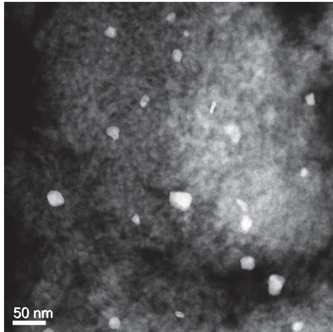
Figure 75. Image STEM du catalyseur 2 %m Pt/γ-Al<sub>2</sub>O<sub>3</sub> C700R500.
