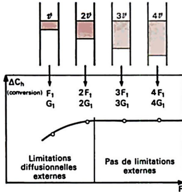
Figure 65. Courbe théorique déterminant la présence ou non de limites diffusionnelles externes au système à temps de contact constant.<sup>278</sup>  $\vartheta$ ,  $F$  et  $G$  représentent le volume de catalyseur, le débit volumique des gaz et le flux massique de gaz réactionnel dans une section droite du lit catalytique (ou régime d'écoulement), respectivement.
