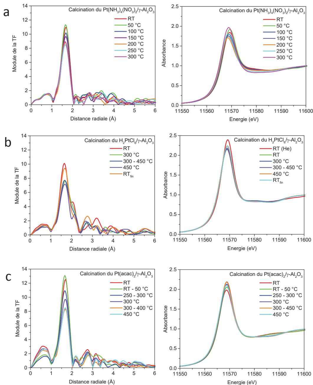
Figure 79. Suivi XAS de la calcination des catalyseurs (a) 0,3 %m Pt(NH<sub>3</sub>)<sub>4</sub>(NO<sub>3</sub>)<sub>2</sub>/γ-Al<sub>2</sub>O<sub>3</sub>, (b) 0,3 %m H<sub>2</sub>PtCl<sub>6</sub>/γ-Al<sub>2</sub>O<sub>3</sub> et (c) 0,5 %m Pt(acac)<sub>2</sub>/γ-Al<sub>2</sub>O<sub>3</sub> sous 20 % O<sub>2</sub> dans He.
