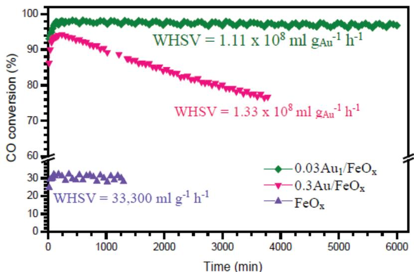
Figure 11. Tests de stabilité des catalyseurs 0,03 %m Au<sub>1</sub>/FeO<sub>x</sub> et 0,3 %m Au/FeO<sub>x</sub> en oxydation de CO à 200 °C. FeO<sub>x</sub> est utilisé comme référence. Conditions de réaction : 1 vol% CO + 1 vol% O<sub>2</sub> + 98 vol% He. <sup>26</sup>
