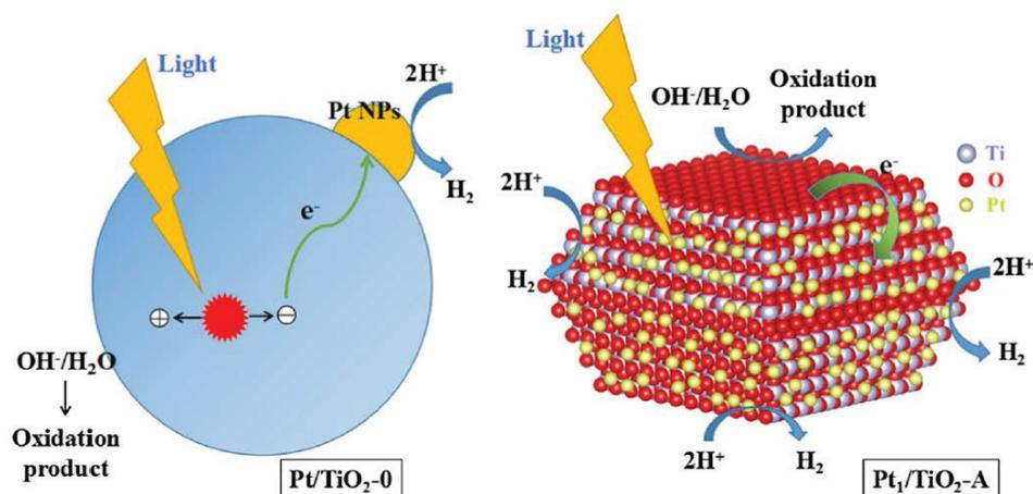
Figure 15. Illustration du transfert de charge et de la production de  $H_2$  dans les catalyseurs  $Pt/TiO_2-0$  (nanoparticules d'environ 3 nm supportées sur un  $TiO_2$  anatase commercial) et  $Pt_1/TiO_2-A$  (atomes isolés supportés sur un  $TiO_2$  anatase « maison » orienté avec faces (001) et (101)) préparés par photodépôt de  $H_2PtCl_6$ .<sup>82</sup>
