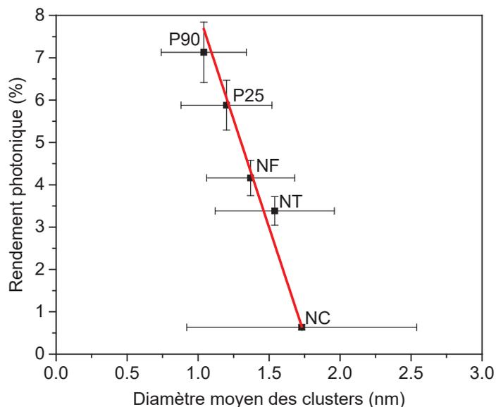
Figure 116. Rendement photonique pour les catalyseurs 0,2 %m Pt/TiO<sub>2</sub> P90, P25, nanofils (NF), nanotubes (NT) et nanoceintures (NC) réduits à 300 °C, en fonction de la taille moyenne des clusters. Droite tracée par ajustement linéaire.
