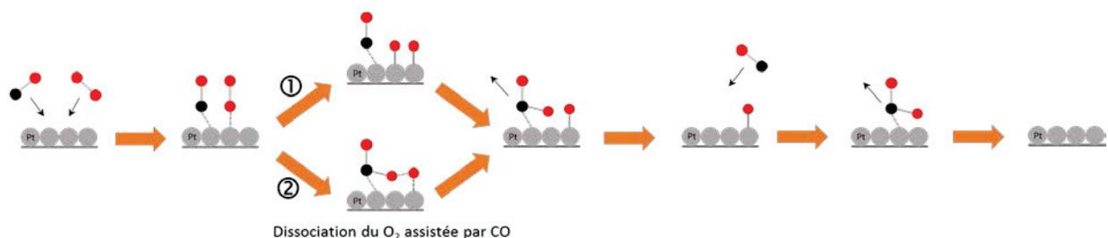
Figure 26. Mécanisme de l'oxydation du CO sur des nanoparticules de platine proposé par Allian *et al.*<sup>203</sup>
