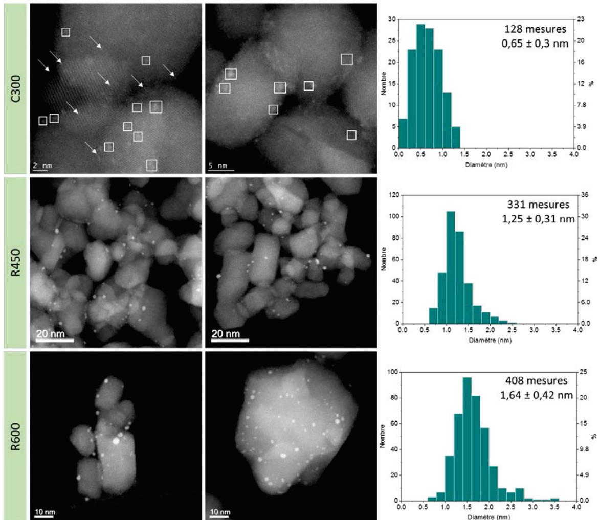
Figure 110. Images STEM et histogrammes de taille du catalyseur 1 %m Pt/TiO<sub>2</sub>-P90 calciné sous air à 300 °C, réduit sous H<sub>2</sub> à 450 °C et réduit sous H<sub>2</sub> à 600 °C. Les flèches et les rectangles indiquent les atomes isolés et les clusters, respectivement. Les clusters et nanoparticules présents sur les catalyseurs R450 et R600 ne sont pas indiqués car bien visibles.
