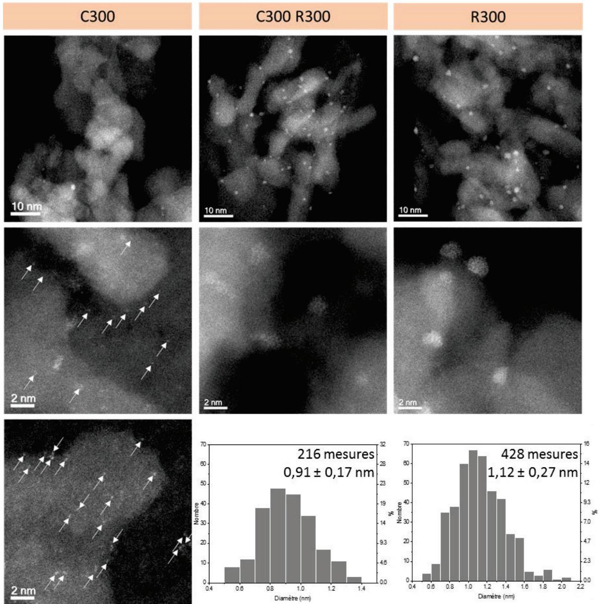
Figure 59. Images STEM représentatives d'un catalyseur 1 %m Pt/γ-Al<sub>2</sub>O<sub>3</sub> après différents traitements thermiques. (C300) Calcination sous air à 300 °C pendant 2 h (dispersion majoritairement atomique). (C300 R300) Calcination sous air à 300 °C pendant 2 h suivie d'une réduction sous H<sub>2</sub> à 300 °C pendant 2 h. (R300) Réduction sous H<sub>2</sub> à 300 °C pendant 2 h. Les flèches pointent vers les atomes isolés.
