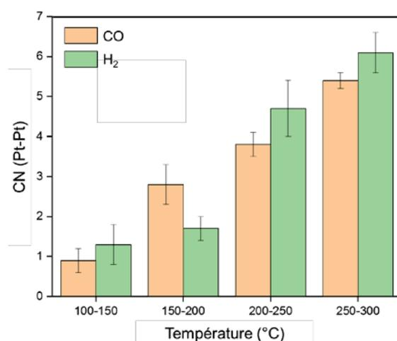
Figure 84. Evolution du CN(Pt) d'un catalyseur 0,3 %m Pt/γ-Al<sub>2</sub>O<sub>3</sub> C300 traité thermiquement sous CO et H<sub>2</sub> en fonction de la température.
