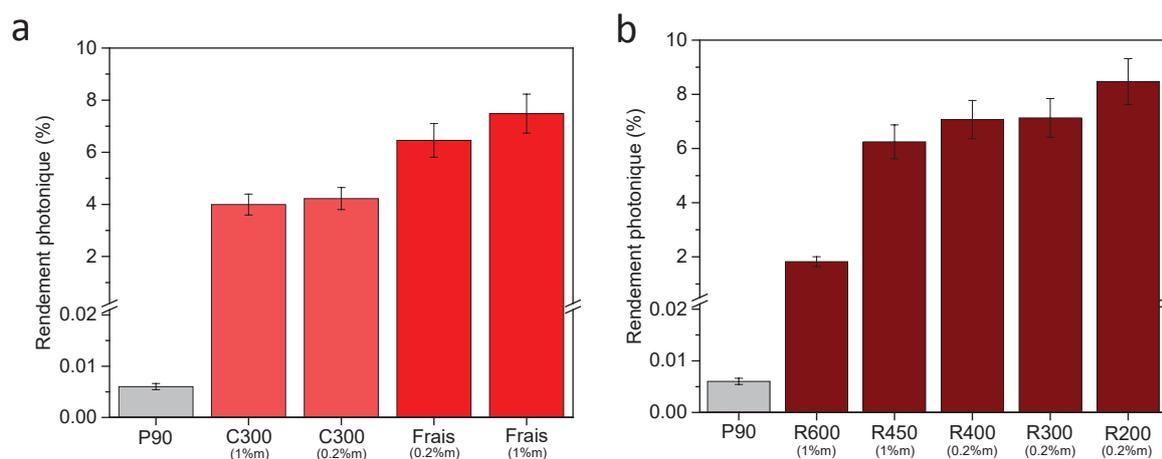
Figure 117. Influence du traitement thermique des catalyseurs Pt/TiO<sub>2</sub>-P90, (a) calcinés et frais et (b) réduits, sur le rendement photonique obtenu pour la déshydrogénation de l'éthanol en phase gaz (durée d'environ 1 h). Le flux de photons est de 2125  $\mu\text{mol/h}$ . C300 correspond à une calcination de 2 h sous air à 300 °C. RX00 correspond à une réduction de 2 h sous hydrogène à X00 °C.
