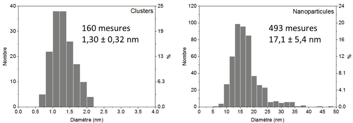
Figure 76. Distributions de taille des catalyseurs 1 %m Pt/γ-Al<sub>2</sub>O<sub>3</sub> R300 (clusters) et 2 %m Pt/γ-Al<sub>2</sub>O<sub>3</sub> C700R500 (nanoparticules).
