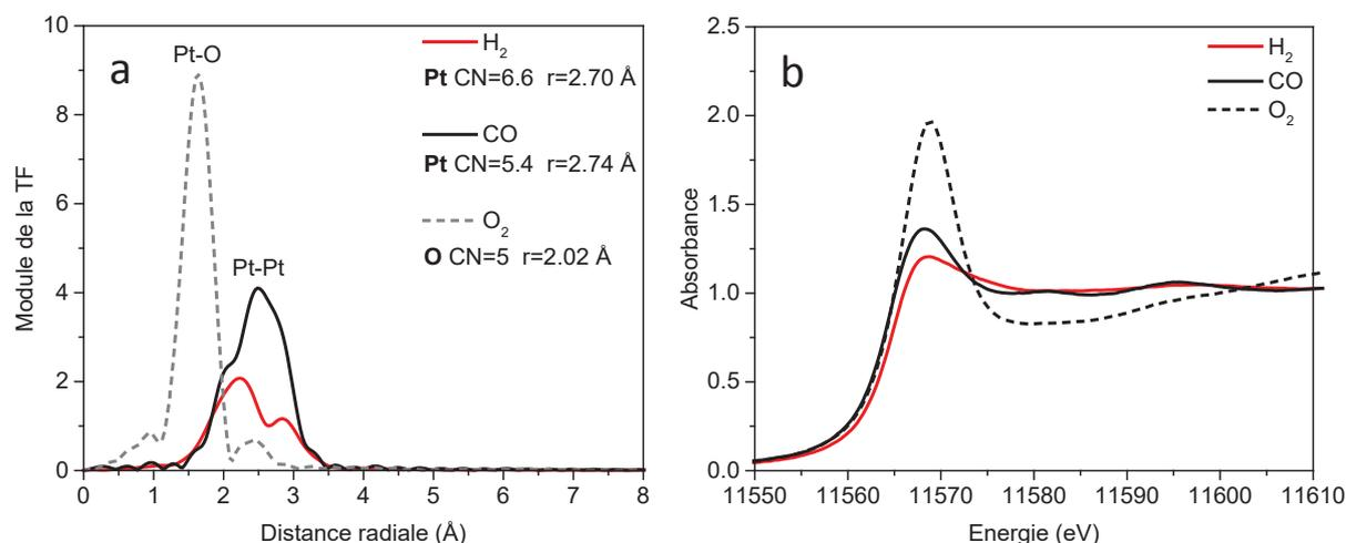
Figure 60. (a) EXAFS et (b) XANES du catalyseur 0,3 %m Pt/γ-Al<sub>2</sub>O<sub>3</sub> à base d'atomes isolés sous H<sub>2</sub>, 5 % CO dans He ou 20 % O<sub>2</sub> dans He à 300 °C. La coordinance CN et la distance radiale *r* (premiers voisins) sont indiquées.
