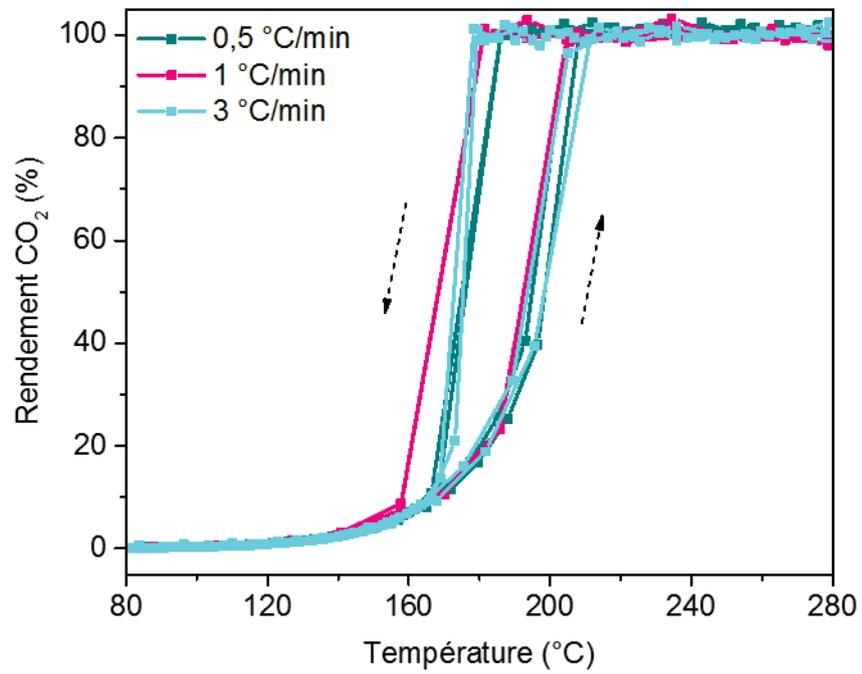
*Courbes d'oxydation de CO (10 % O<sub>2</sub>, 2 % CO) avec différentes rampes de température sur le catalyseur 1 %m Pt/ $\gamma$ -Al<sub>2</sub>O<sub>3</sub> R300.*
