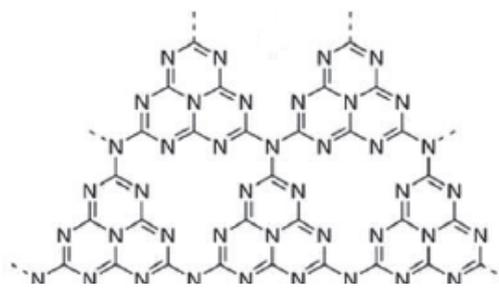
Figure 32. Nitrure de carbone graphitique  $g\text{-C}_3\text{N}_4$ .
