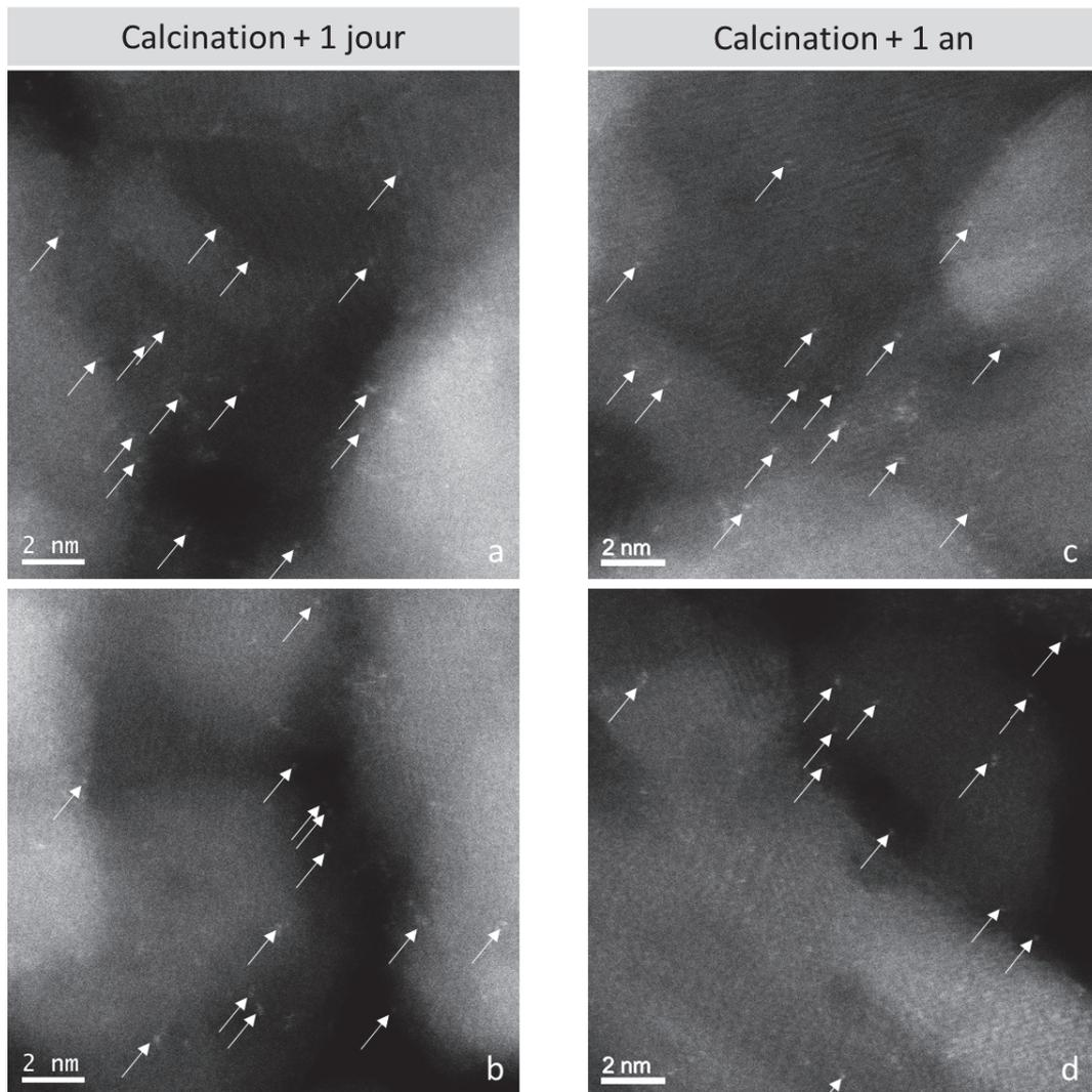
Figure 62. Images STEM représentatives du catalyseur 0,3 %m  $\text{Pt}/\gamma\text{-Al}_2\text{O}_3$  calciné 1 jour (a, b) ou 1 an (c, d) après avoir été préparé (IWI, précurseur  $\text{Pt}(\text{NH}_3)_4(\text{NO}_3)_2$ ).
