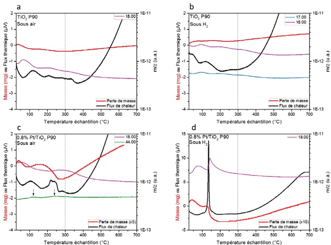
Figure 105. Analyse thermique ATG-ATD-SM du support TiO<sub>2</sub>-P90 (a, b) et du catalyseur frais Pt(NH<sub>3</sub>)<sub>4</sub>(NO<sub>3</sub>)<sub>2</sub>/TiO<sub>2</sub>-P90 chargé à 0,8 %m en platine (c, d) sous flux d'air (a, c) et d'H<sub>2</sub> (b, d).
