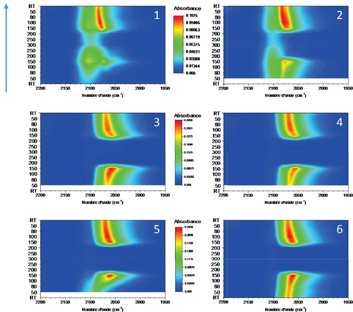
Figure 102. Suivi en DRIFTS operando du catalyseur 0,3 %m Pt/γ-Al<sub>2</sub>O<sub>3</sub> en COOX2 a (1 et 2), b (3 et 4) et c (5 et 6).
