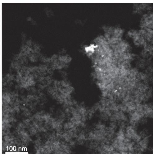
Figure 49. Image STEM de nanoparticules présentes sur le catalyseur 0,5 %m Pt/γ-Al<sub>2</sub>O<sub>3</sub> préparé par WI avec Pt(acac)<sub>2</sub>.
