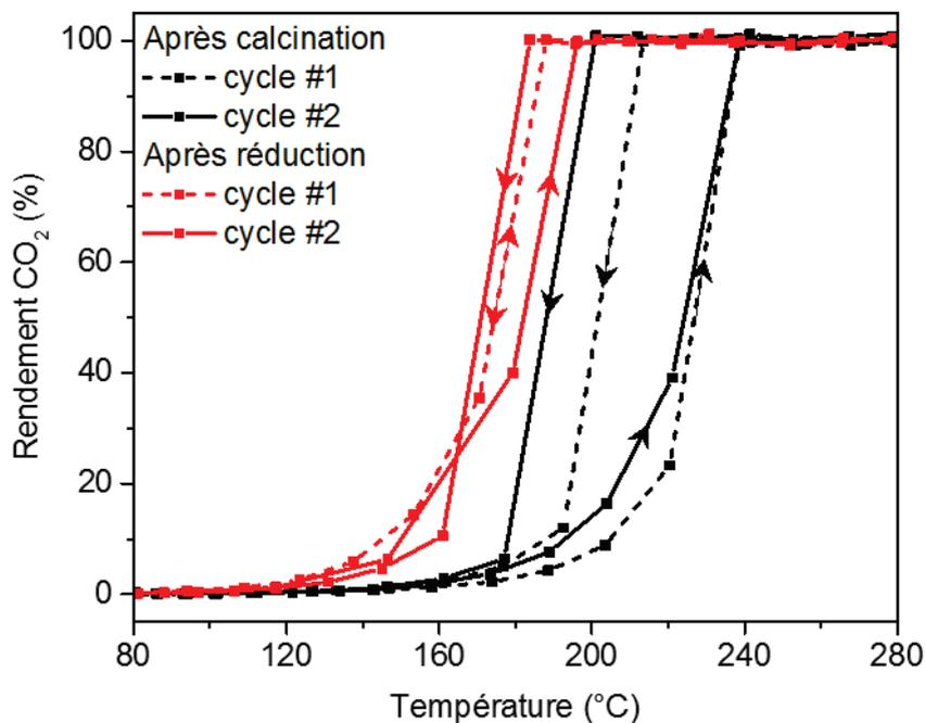
Figure 94. Résultats de l'oxydation du CO (en réacteur) sur le catalyseur 0,3% Pt/γ-Al<sub>2</sub>O<sub>3</sub> après calcination et après réduction.
