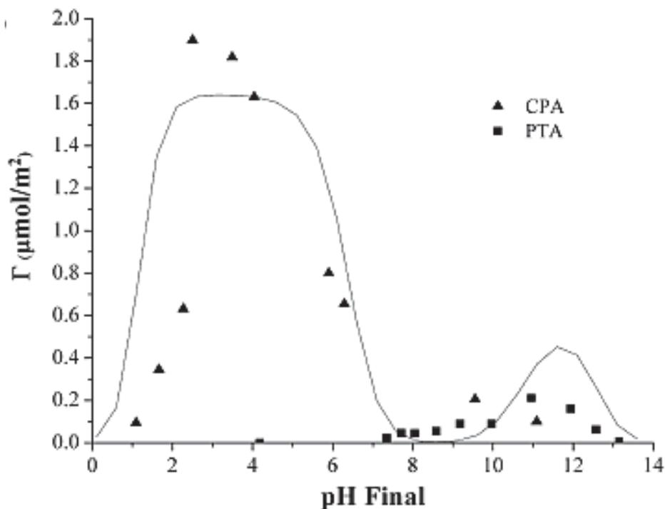
Figure 36. Adsorption des complexes  $\text{PtCl}_6^{2-}$  (CPA) et  $\text{Pt}(\text{NH}_3)_4^{2+}$  (PTA) sur alumine- $\gamma$ .<sup>250</sup> En ordonnée,  $\Gamma$  correspond à la densité de métal en surface.
