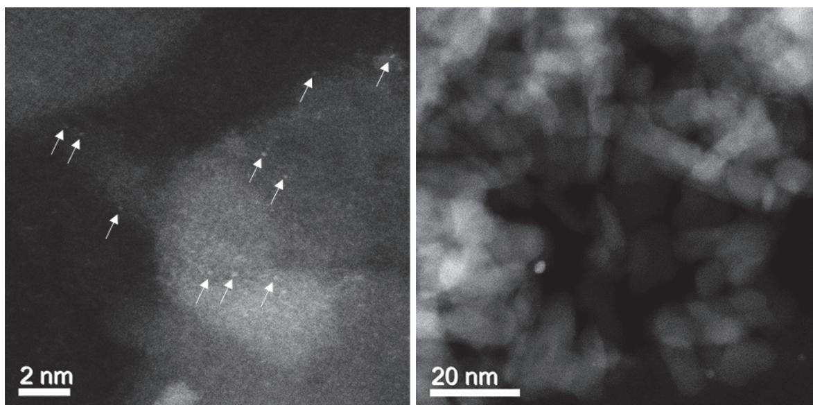
Figure 96. Images STEM représentatives du catalyseur 0,3 %m Pt/γ-Al<sub>2</sub>O<sub>3</sub> calciné après deux cycles COOX10 en réacteur (COOX10 a#1 et #2). Les flèches pointent les atomes isolés.
