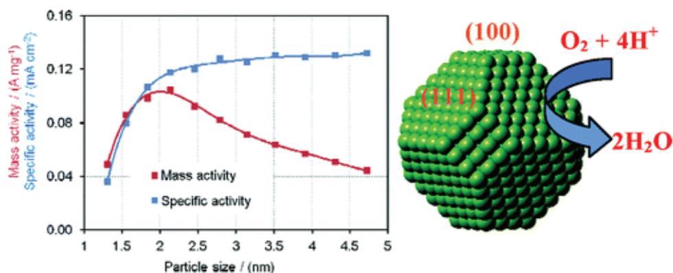
Figure 22. Influence de la taille des nanoparticules de platine dans la réaction de réduction de l'oxygène.<sup>149</sup>
