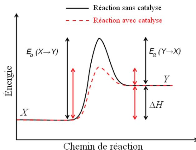
Figure 1. Illustration de la diminution de l'énergie d'activation ( $E_a$ ) d'une réaction en présence d'un catalyseur (enthalpie  $\Delta H$ ).<sup>1,2</sup>
