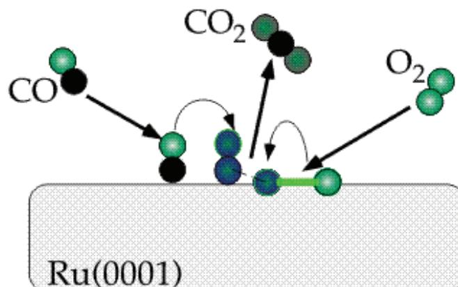
Figure 25. Oxydation du CO via un mécanisme de type Langmuir-Hinshelwood sur un catalyseur modèle Ru. <sup>190</sup>
