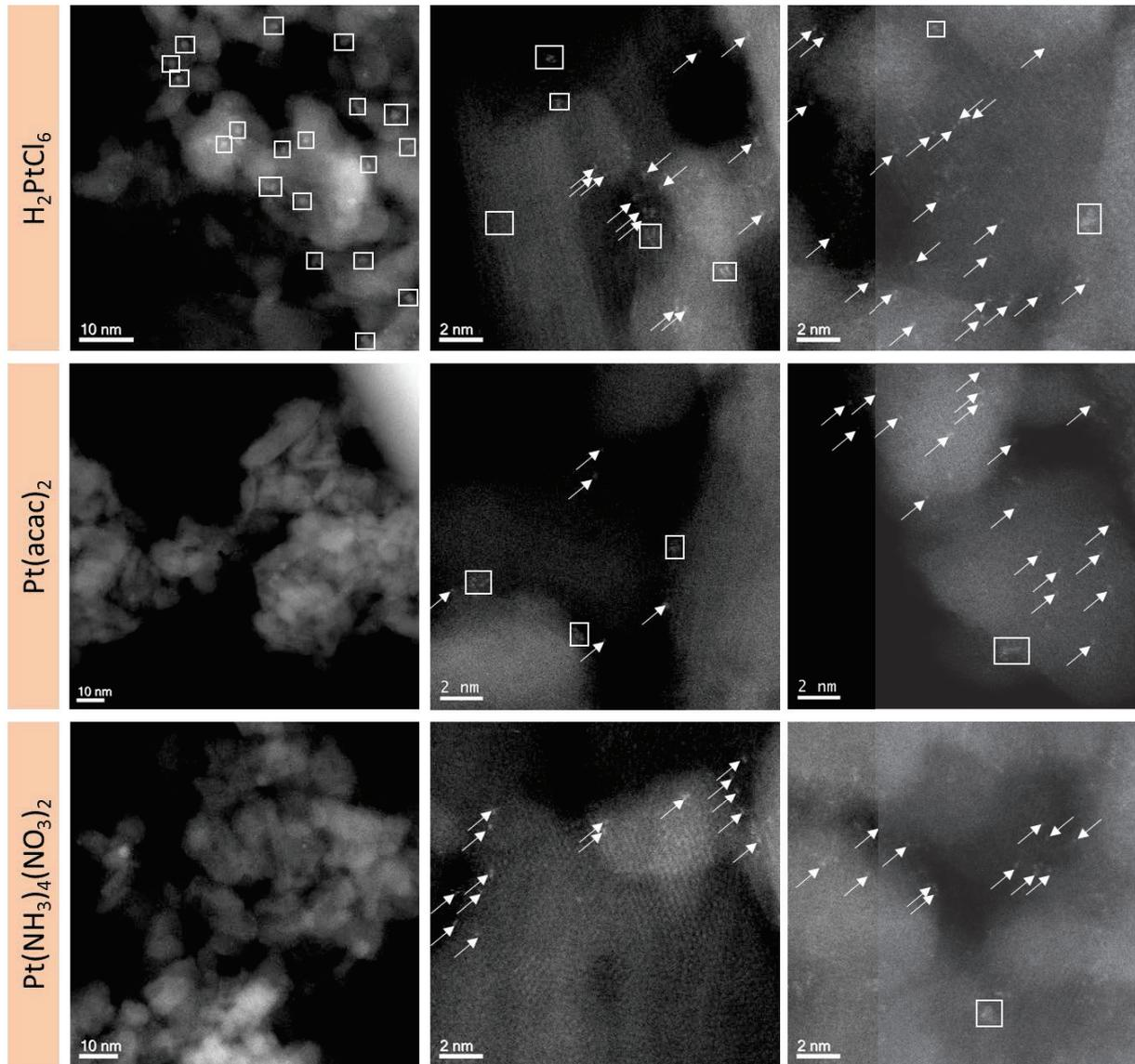
Figure 52. Images STEM représentatives de catalyseurs 0,5 %m  $\text{Pt}/\gamma\text{-Al}_2\text{O}_3$  C300 préparés par IWI avec différents précurseurs de platine. Les flèches pointent les atomes isolés et les rectangles les clusters.
