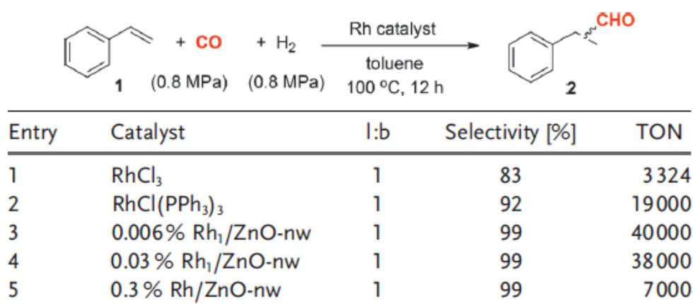
Figure 7. Activité catalytique des catalyseurs  $\text{Rh}_1/\text{ZnO}$ -nanofils en hydroformylation du styrène.<sup>20</sup>
