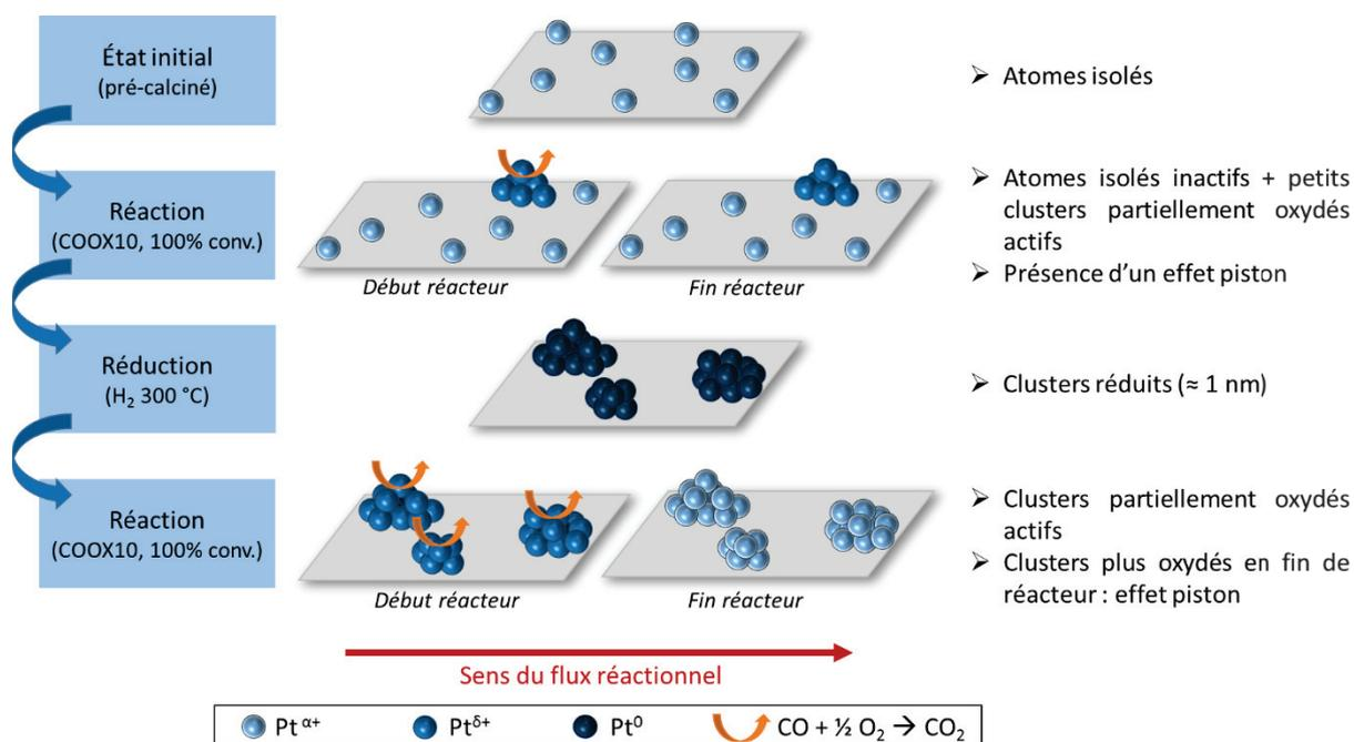
Figure 104. Schéma résumant l'état du platine après différentes étapes de traitements et de réactions du catalyseur 0,3 %m Pt/γ-Al<sub>2</sub>O<sub>3</sub>. Les espèces en présence au cours de la réaction dépendent de la position dans le « réacteur piston » (gradient de composition de l'atmosphère réactionnelle). Seules les étapes suivies par XAS et DRIFTS *operando* sont représentées.
