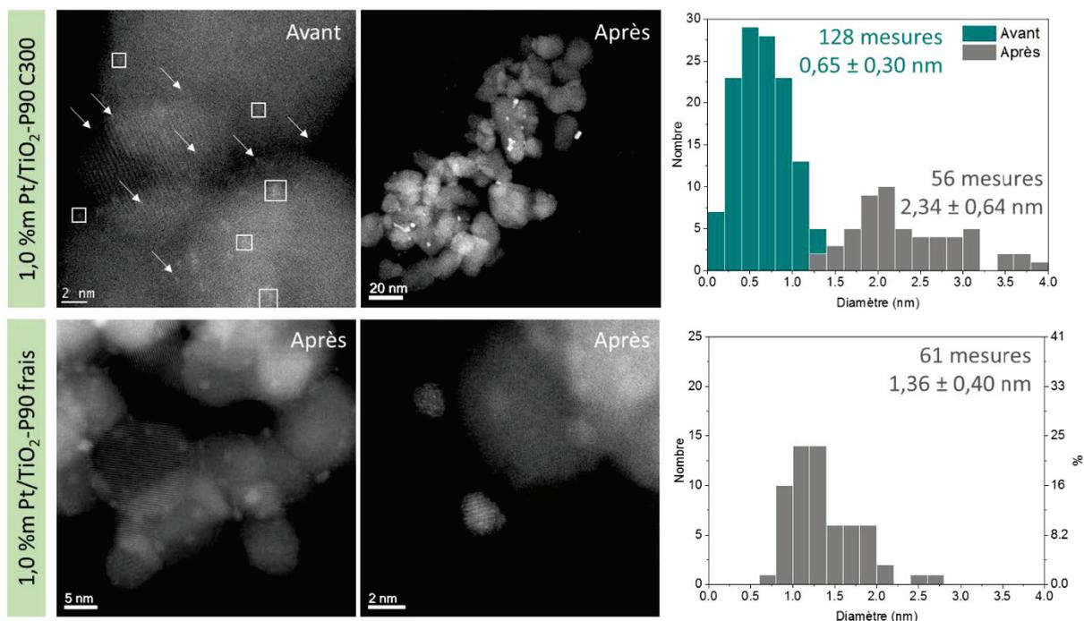
Figure 118. Images STEM et histogrammes de taille des catalyseurs 1,0 %m Pt/TiO<sub>2</sub>-P90 C300 et frais, avant et après la réaction de déshydrogénation de l'éthanol.
