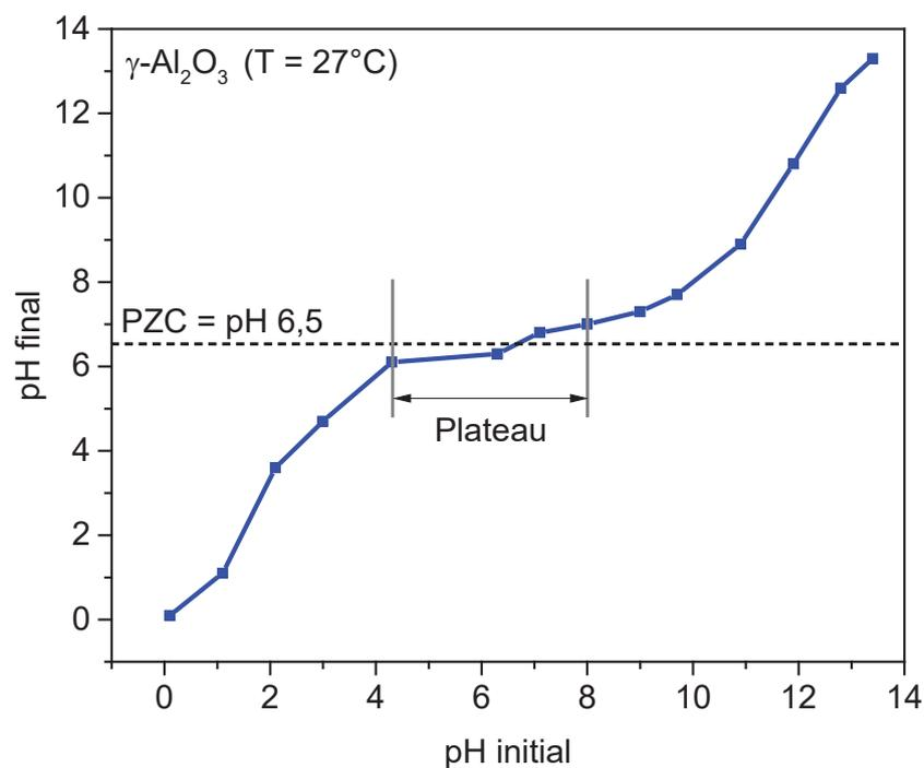
Figure 35. Détermination du PZC de l'alumine- $\gamma$  Puralox SCFa-140 (Sasol).
