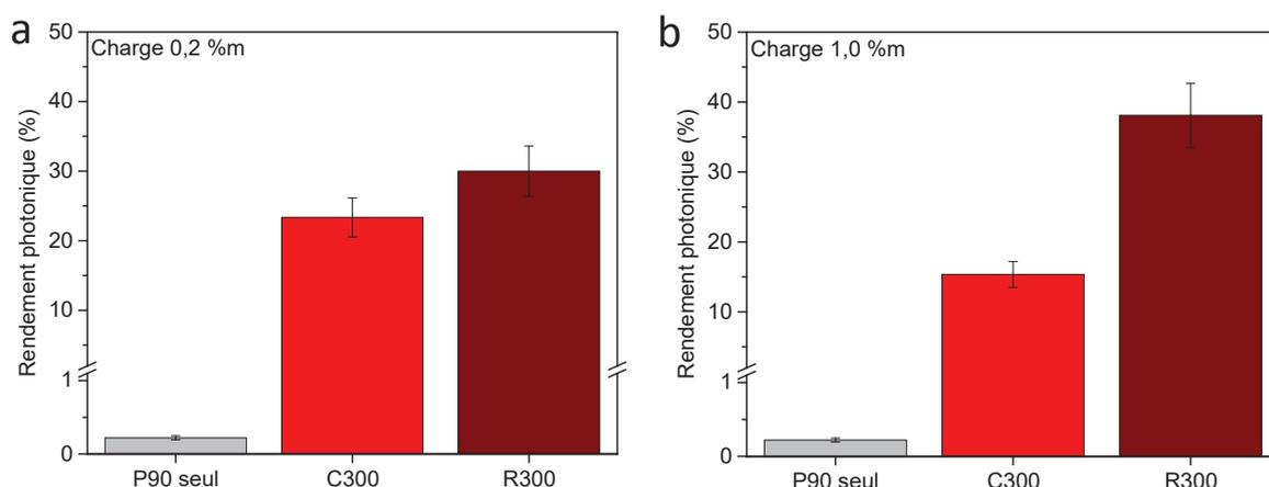
Figure 121. Influence du traitement thermique des catalyseurs (a) 0,2 et (b) 1,0 %m Pt/TiO<sub>2</sub>-P90 sur le rendement photonique de déshydrogénation de l'éthanol en phase liquide. Le flux de photons est de 1020  $\mu\text{mol}\cdot\text{h}^{-1}$ .
