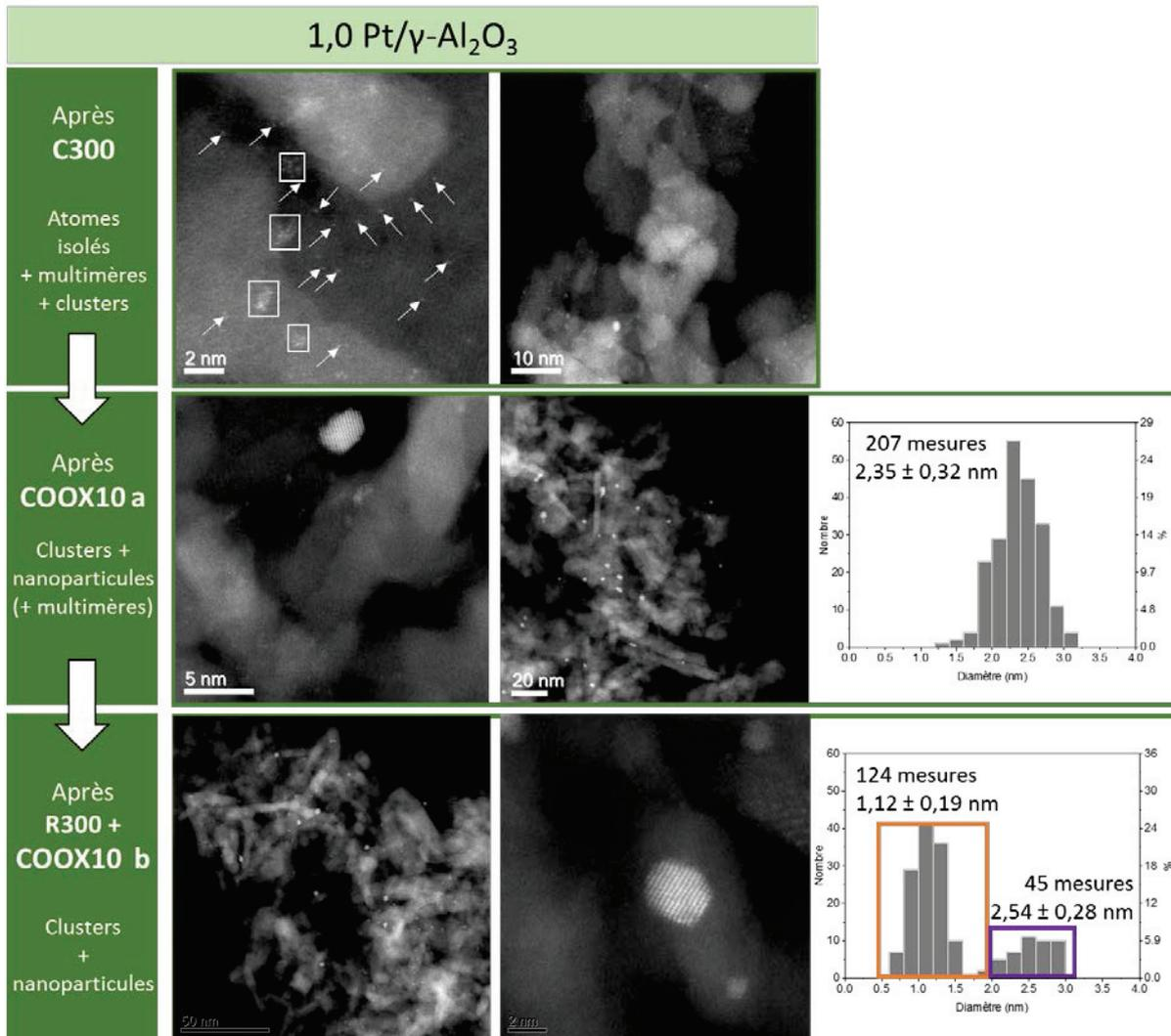
Figure 73. Images STEM représentatives du catalyseur 1,0 % Pt/γ-Al<sub>2</sub>O<sub>3</sub> étudié à différentes étapes de l'expérience COOX10. Les flèches pointent les atomes isolés et les rectangles encadrent les clusters. Les nanoparticules, assez visibles, ne sont pas encadrées.
