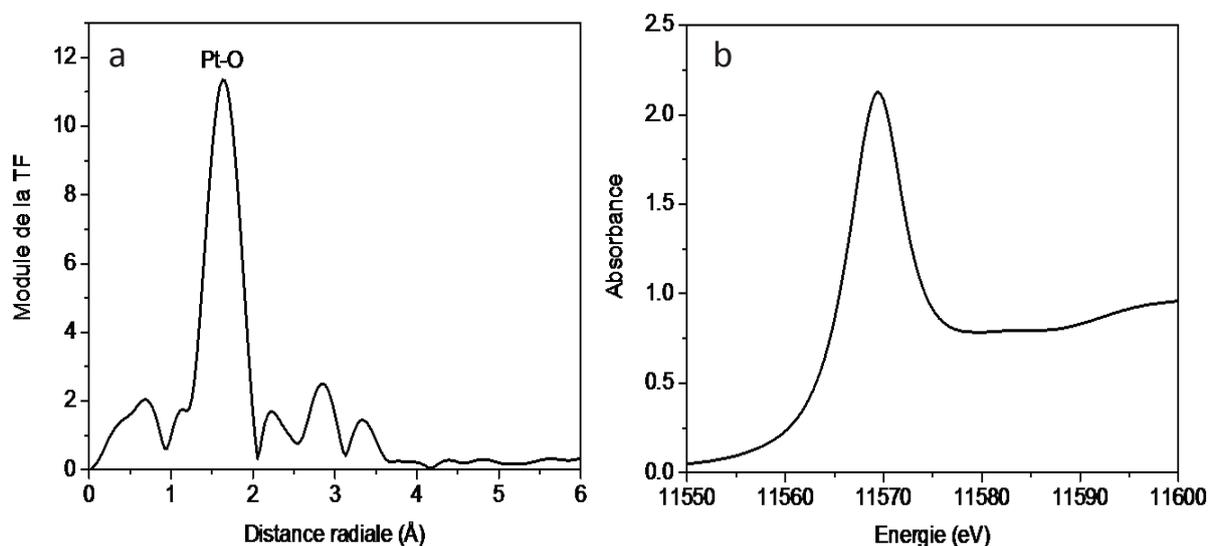
Figure 54. EXAFS (a) et XANES (b) d'un catalyseur 0,3 %m Pt/γ-Al<sub>2</sub>O<sub>3</sub> après une calcination à 300 °C.
