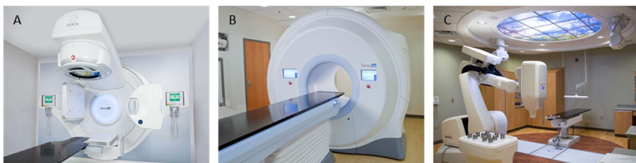
Figure 10: Différents accélérateurs de radiothérapie. A : accélérateur linéaire conventionnel ; B : appareil de tomothérapie hélicoïdale ; C : appareil de radiothérapie stéréotaxique type « Cyberknife »
