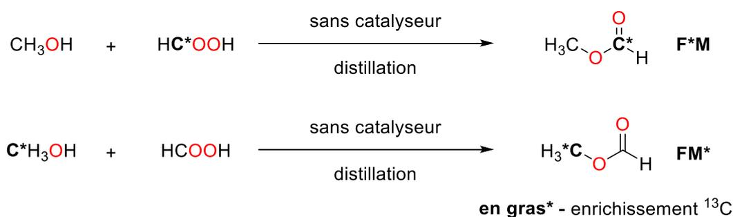
Figure IV-9 Synthèse des formiates de méthyle marqués  $^{13}\text{C}$
