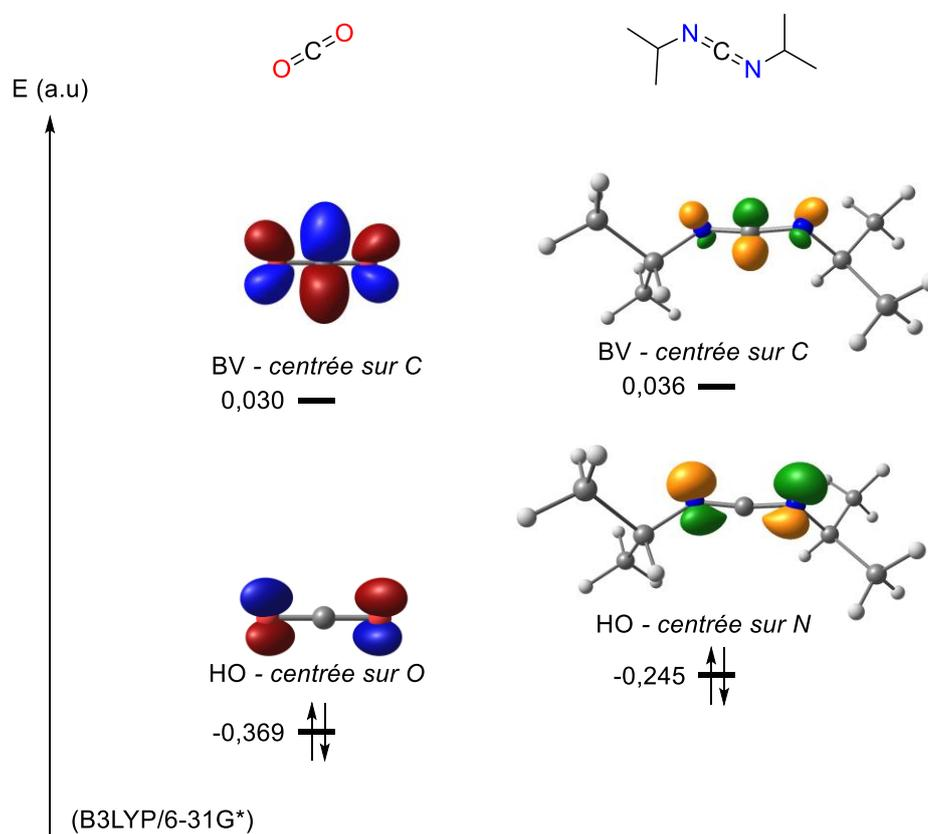
Figure V-4 Comparaison théorique des orbitales frontières entre le CO<sub>2</sub> et le DIC
