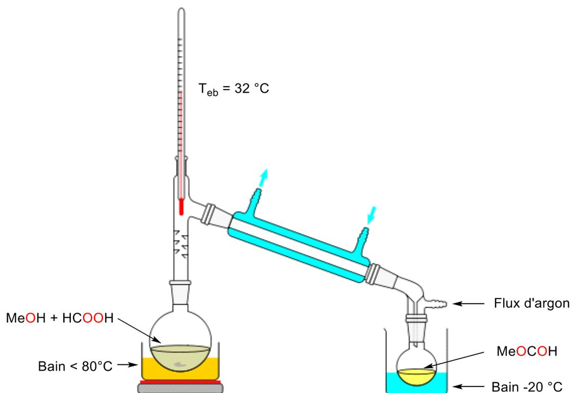
Figure II-32 Montage de distillation sous atmosphère inerte<sup>[28]</sup>
