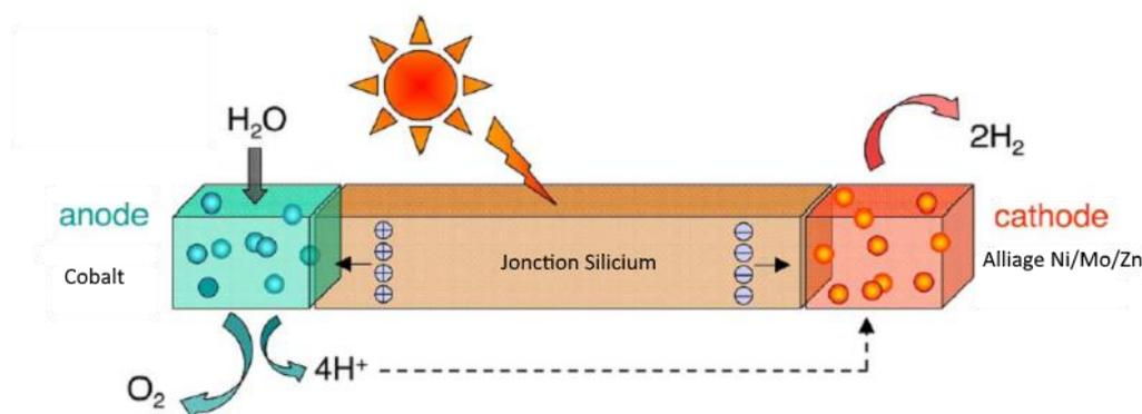
Figure I-10 Concept de feuille artificielle par D. Nocera <sup>[13]</sup>
