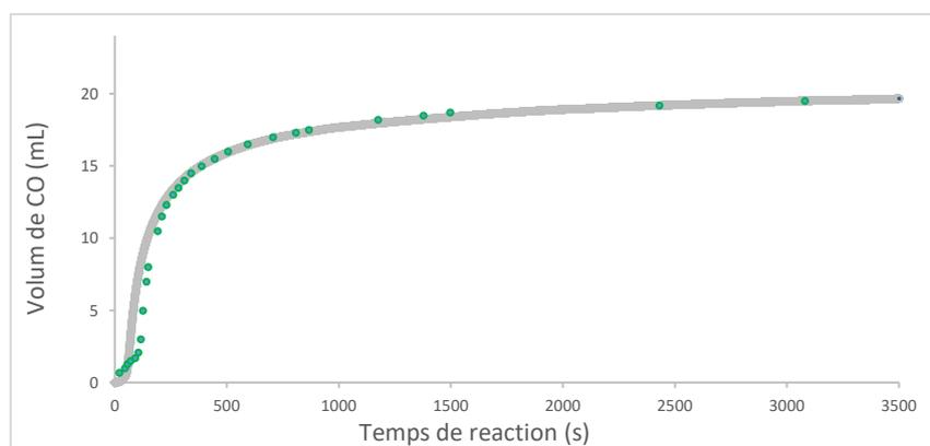
Figure II-11 Tracé du volume de CO lors d'une réaction typique de décarbonylation du formiate de méthyle en système ouvert avec 5 mol% de MeOK, avec le système eudiomètre en vert et avec le débitmètre en gris
