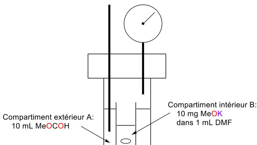
Figure II-22 Système en autoclave pour la réaction de décarbonylation
