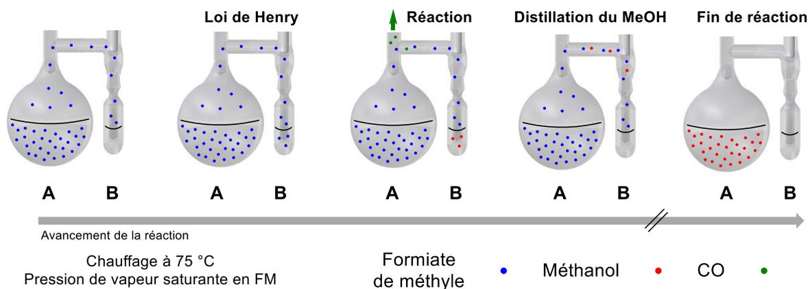
Figure II-21 Explication schématique du fonctionnement de la double chambre
