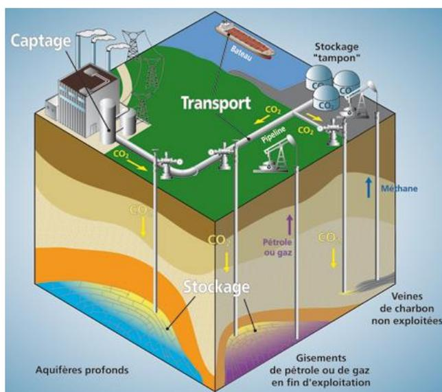
Figure I-8 Captage et stockage géologique du CO<sub>2</sub> (Source BRGM, géosciences pour une terre durable) <sup>[11]</sup>
