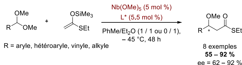
Schéma I.8. Substitution énantiosélective d'acétals catalysée au niobium(V)
