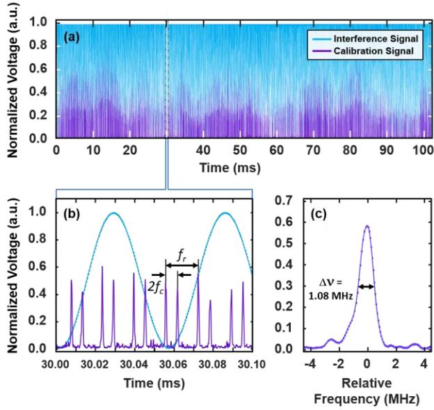
**Figure 4.** (a). Signal d'interférence et pics de calibration référencés au peigne de fréquences. (b). Zoom de la partie encadrée de la section (a). Chaque paire de pics est produite lorsque la fréquence de balayage se rapproche puis s'éloigne d'une raie du peigne. (c). Un autre zoom de (b) montre la largeur spectrale du pic et la grande résolution du pic de calibration.
