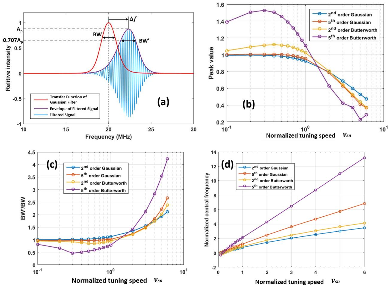
**Figure 2.** Caractéristiques des signaux crêtes filtrés. **(a)** Illustration de la distorsion du pic filtré en fonction de la fréquence d'entrée chirpée, en considérant l'amplitude, la bande passante et la fréquence centrale. **(b)-(d)** L'amplitude, la bande passante et le pic filtré en fonction de différentes vitesses de balayage.
