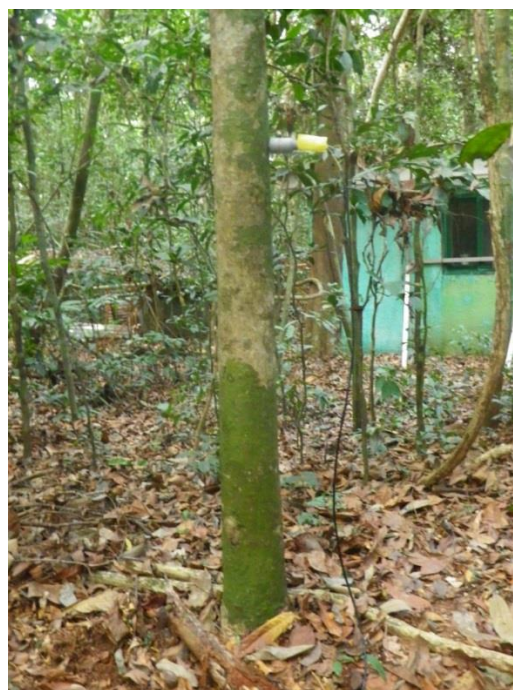
Figure 3-3 : A gauche, datalogger mis en place sur un arbre. 3 sondes sont fixées à différents niveaux. A droite, « petit arbre » sur lequel une sonde est positionnée.
