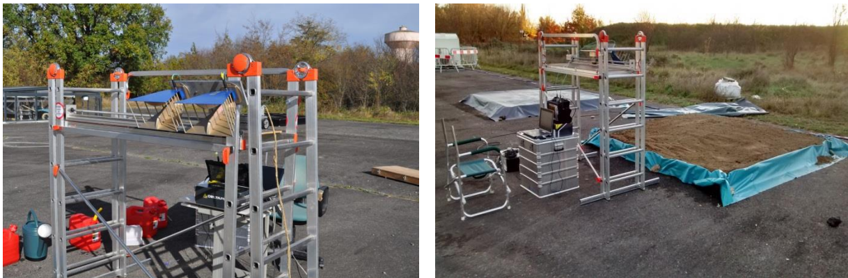
Figure 2-39 : Présentation du radar de proximité. Le dispositif est composé d'un analyseur de réseau vectoriel (VNA) (visible à droite), de deux antennes et d'un banc de translation posé sur un échafaudage (gros plan à gauche).
