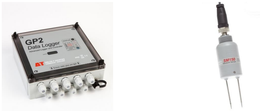
Figure 2-38 : À gauche : data logger utilisé pour collecter des mesures d'humidité régulières. À droite, sondes d'humidité utilisées pour effectuer les mesures.
