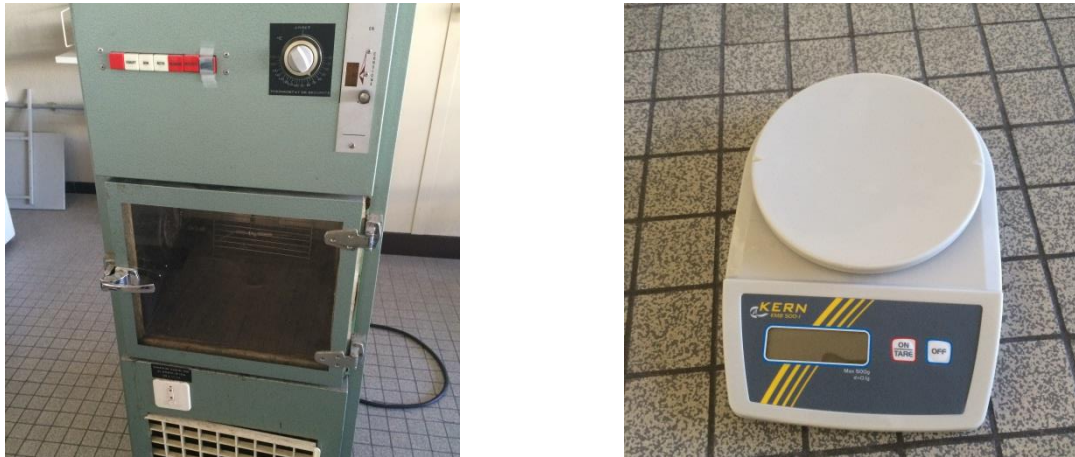
Figure 2-37 : A gauche four permettant le séchage des feuilles et des tiges, à droite balance pour peser avant et après séchage.
