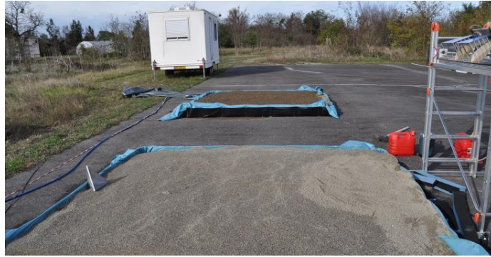
Figure 2-40 : Mise en place d'un trièdre au fond de l'image lors d'une acquisition. Il servira pour la calibration des mesures.
