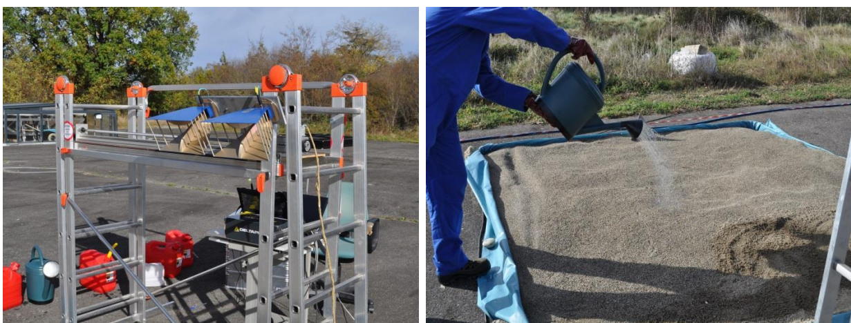
Figure 4-10 : Dispositif radar (à gauche) et versement de gasoil en surface (à droite). Le dispositif est composé d'un analyseur de réseau vectoriel (VNA), de deux antennes et d'un banc de translation posé sur un échafaudage. Le versement d'hydrocarbure s'effectue avec un arrosoir pour ne pas modifier la rugosité du sol. On répartit l'essence aussi uniformément que possible sur toute la surface.
