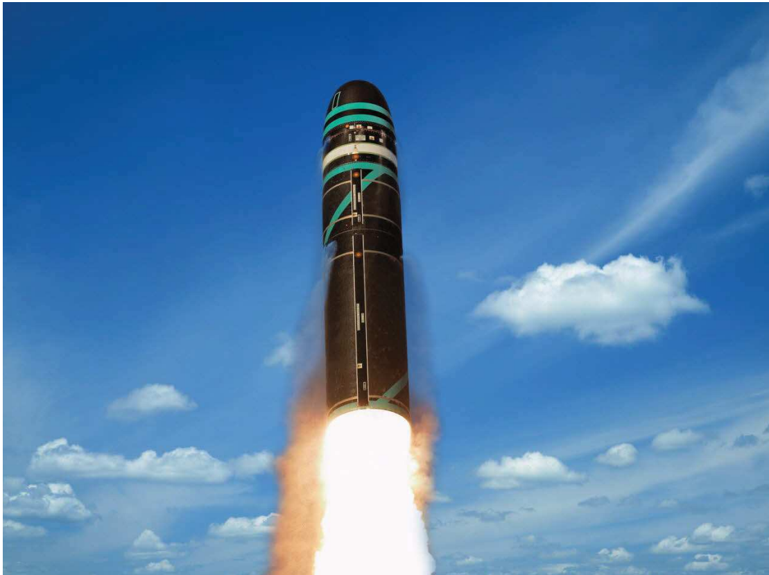
FIGURE 1 – Photographie du missile M51. La dissuasion nucléaire française emploie la propulsion solide. Plusieurs étages à propulsion solide sont assemblés et plusieurs compositions et types de propergols sont utilisés. Lors du décollage, le premier étage est allumé et la combustion du propergol engendre une force de poussée vers le haut. Un étage est largué lorsque tout le propergol est brûlé [ Aerospatium 2016 ].
