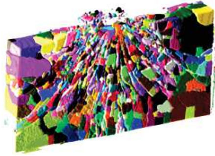
FIGURE 4.11 – Identification de chaque fragment pour les isoler et pouvoir les analyser séparément [Forquin et Ando 2017].
