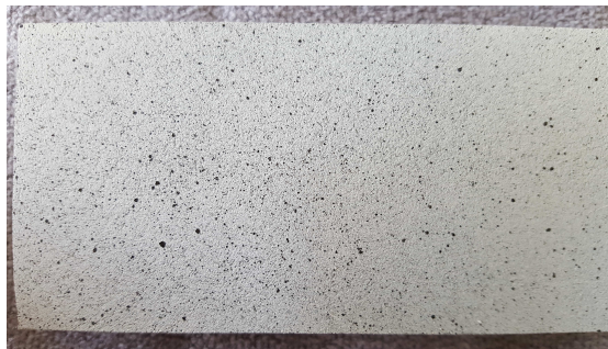
FIGURE 4.6 – Photographie d'un échantillon revêtu d'un mouchetis réalisé à la bombe de peinture. Une très fine sous-couche blanche est appliquée pour maximiser le contraste.
