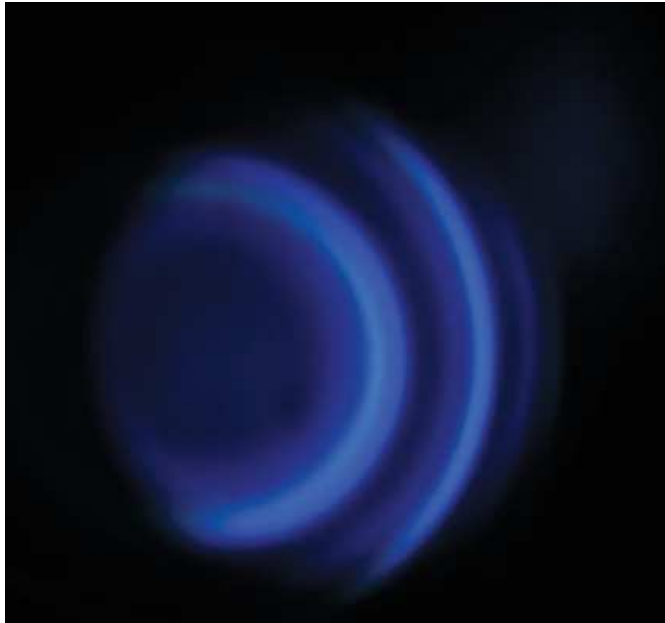
FIGURE A.2 – Illustration du phénomène d'interférence. Des franges plus au moins illuminées apparaissent lorsqu'une différence de phase existe entre deux faisceaux cohérents. Il s'agit ici d'une figure d'interférence obtenue par un interféromètre de Fabry-Pérot. Ici, les cercles lumineux sont les ordres d'interférences p = 1 et p = 2 [Wikipédia 2019a].
