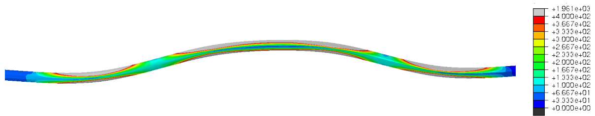
FIGURE 56 – Contraintes de Von Mises dans le fil orthodontique au niveau de l'attache B3 (en MPa).
