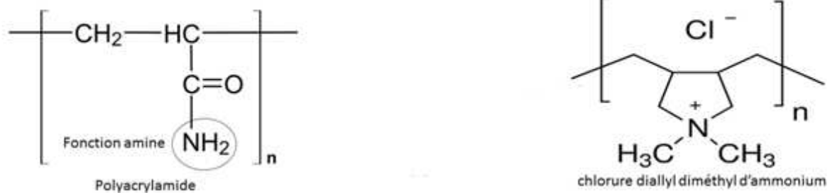
Figure 7 : Structure chimique de deux polymères : polyacrylamide et chlorure diallyl diméthyl d'ammonium
