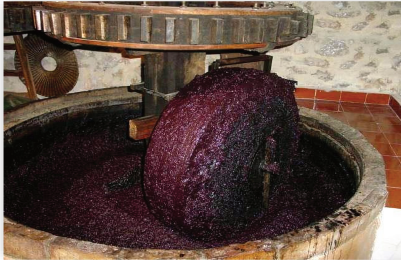
Figure 20 : Trituration des olives et production de margines
