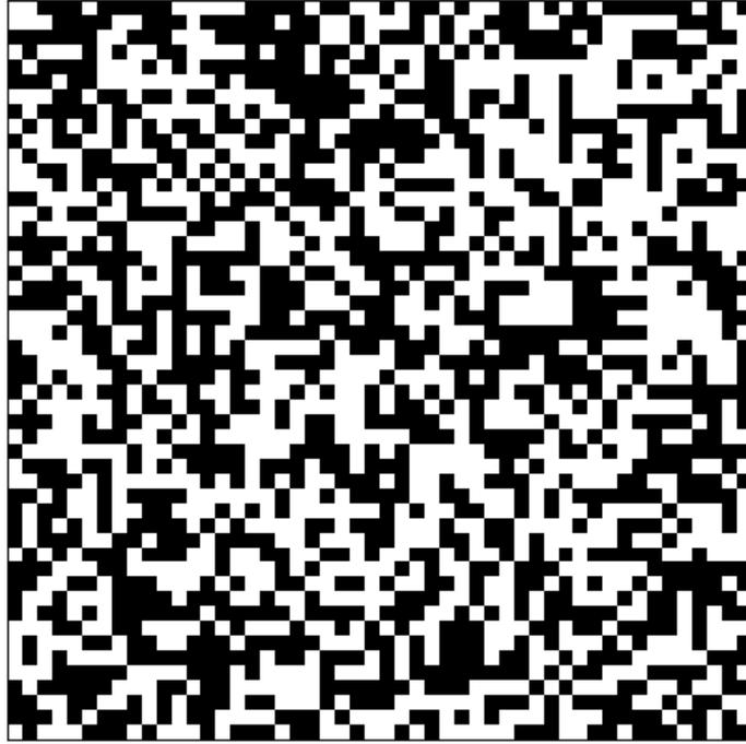
FIGURE 1.10 – lame RPP avec des éléments carrés.
