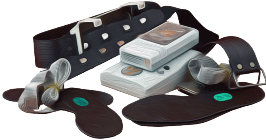
Рисунок 21. Общий вид тензометрических стелек «ДиаСлед-М» и регистрирующего блока.
