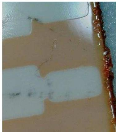
Figure 19 : Surépaisseur de résine sur le bord de l'échantillon.
