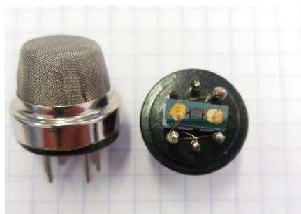
Figure 8 : Boîtier d'un capteur de gaz commercial dans lequel sont assemblés les éléments du capteur.
