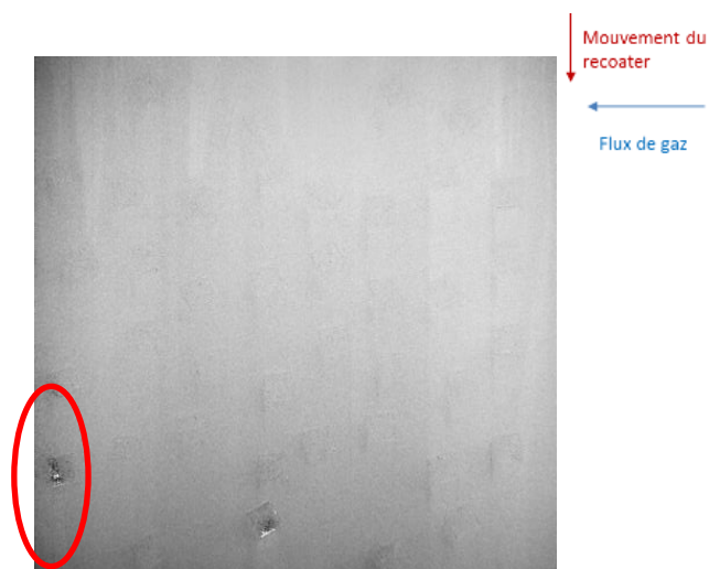
FIGURE 3-21 : EXEMPLE DE MAUVAISE DEPOSE DE POUDRE, COUCHE 132, DIRECTION NORD-SUD.
