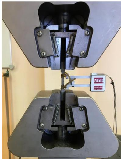
FIGURE 2-29 : MONTAGE DES EPROUVETTES SLM POUR LES ESSAIS DE TRACTION UNI-AXIALE.
