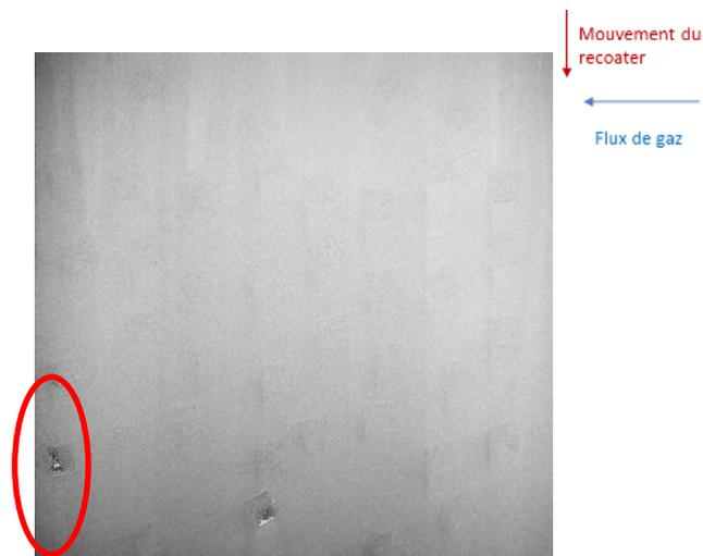
FIGURE 3-21 : EXEMPLE DE MAUVAISE DEPOSE DE POUVRE, COUCHE 132, DIRECTION NORD-SUD.
