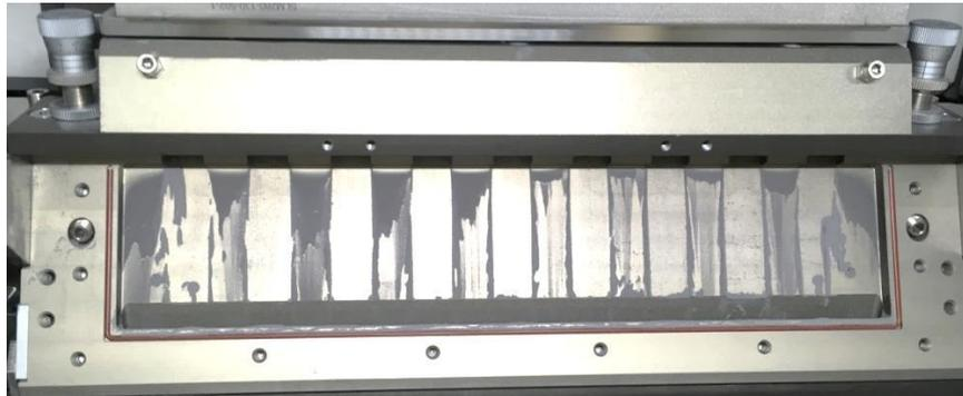
FIGURE 3-20 : RESIDUS DE POUVRE DANS LE RECOATER
