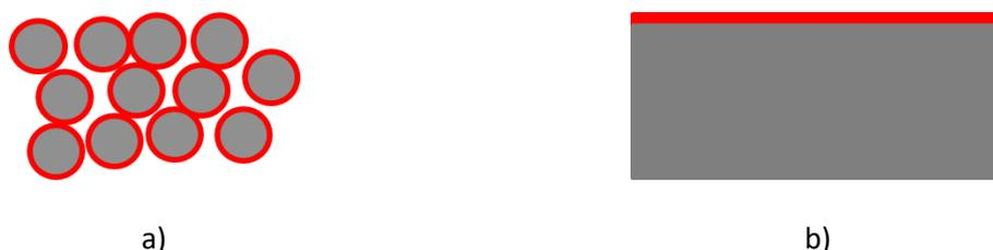
**FIGURE 4-50 : SCHEMATISATION DE LA SURFACE DEVELOPPEE AU CONTACT DIRECT AVEC LE MILIEU ENVIRONNANT, A) EN SLM, B) EN SOUDAGE LASER**
