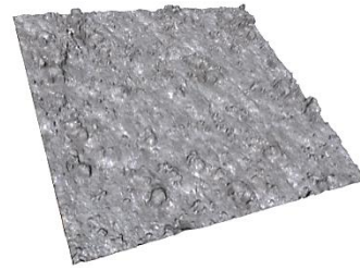
FIGURE 2-15 : RECONSTITUTION 3D D'UNE SURFACE LATÉRALE BRUTE DE SLM.
