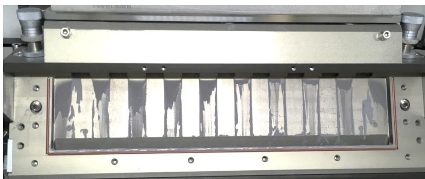
FIGURE 3-20 : RESIDUS DE POUUDRE DANS LE RECOATER
