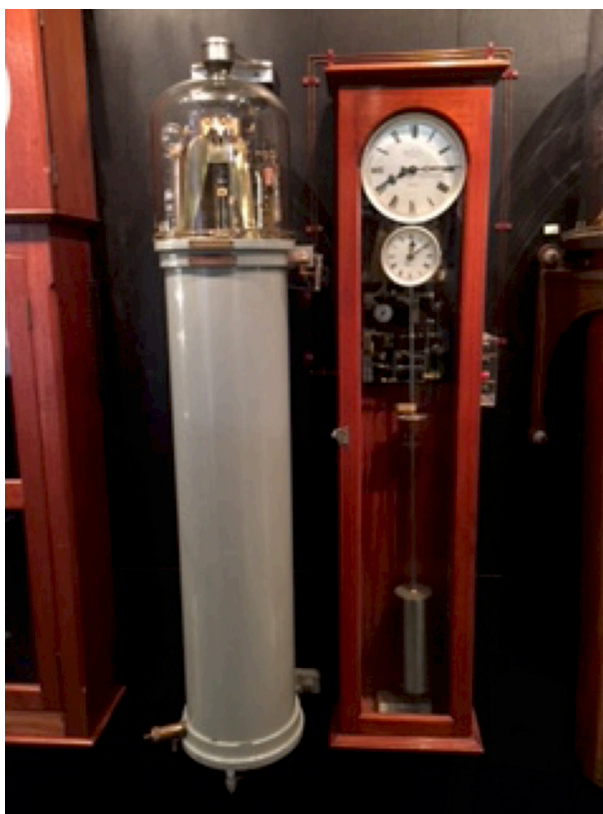
FIGURE 3.2 – Horloge de Shortt exposée à l'observatoire de Greenwich (photo personnelle).
