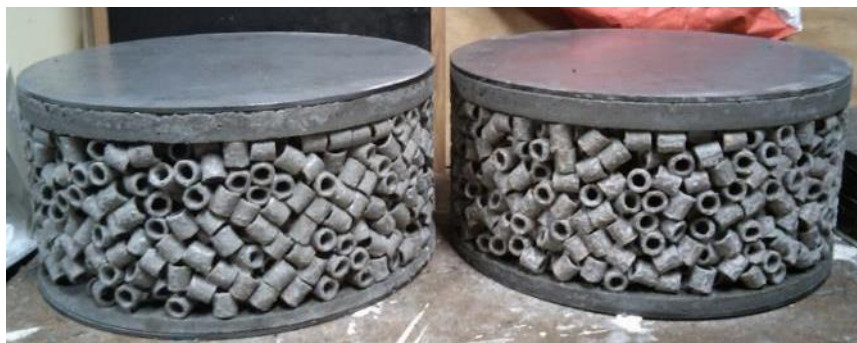
Photographie 5-6 : Echantillon œdométrique avec barbotine de collage
