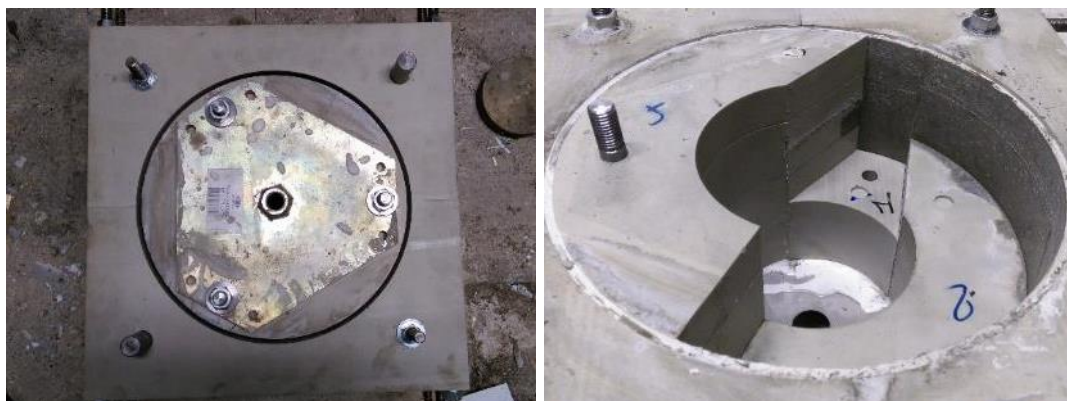
Photographie 5-14 : Moule pour la fabrication de coque de protection en matériau cimentaire
