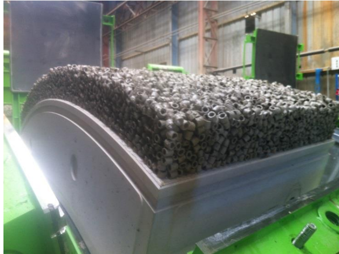
Photographie 6-1 : Fabrication d'un voussoir compressible VMC chez Stradal
