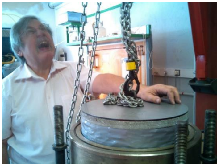
Photographie 5-7 : Mise en place de l'échantillon dans la cellule œdométrique
