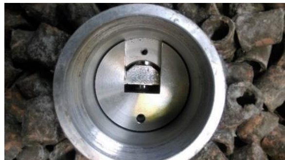
Photographie 5-11: Vue du haut du soutènement avec ses deux coins
