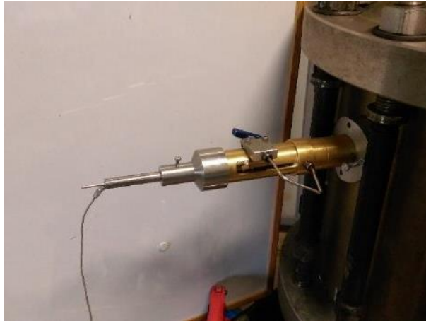
Photographie 5-12 : Palpeur de mesure du déplacement radial installé sur la jupe d'appareil
