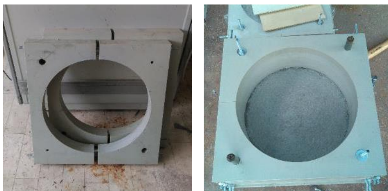
Photographie 5-5 : Moule en PVC de fabrication de l'échantillon œdométrique
