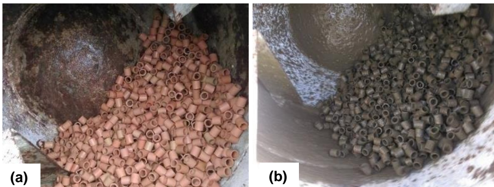
Photographie 5-16 : Mode opératoire pour la fabrication de l'échantillon du modèle réduit de voussoirs
