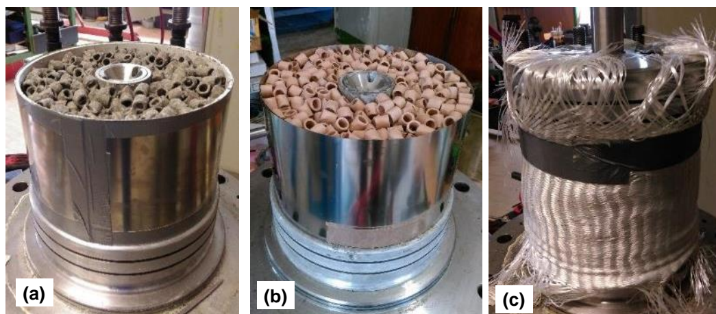
Photographie 5-18 : Protection de membrane par clinquant et fibre de verre
