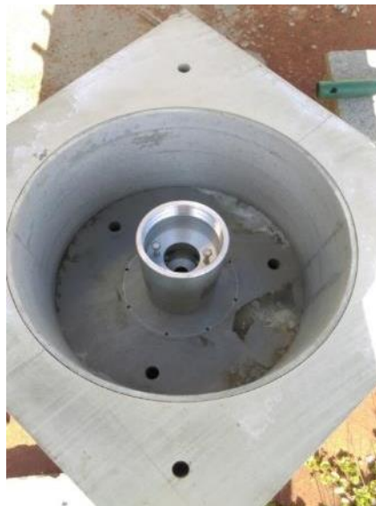
Photographie 5-15 : Moule assemblé avec la coque de protection et le soutènement
