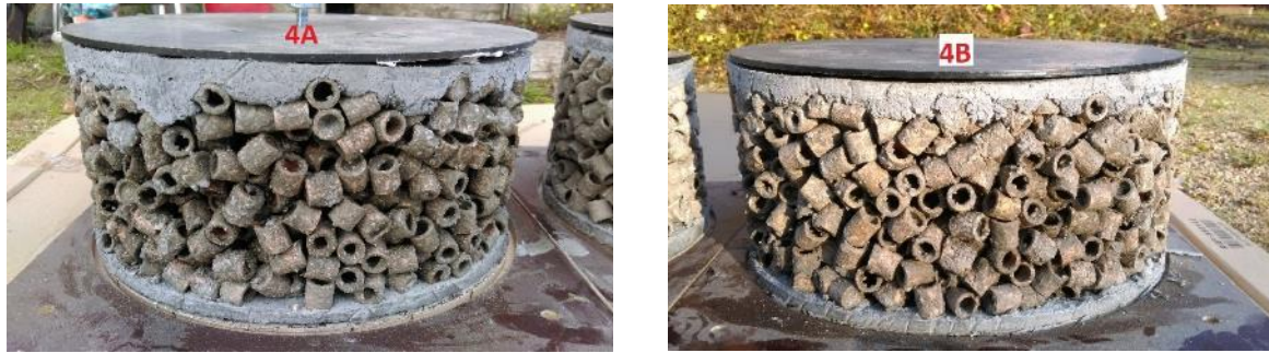
Photographie 5-9 : Echantillons 1A, 1B, 2A, 2B, 3A, 3B, 4A, 4B avant l'essai de compressibilité
