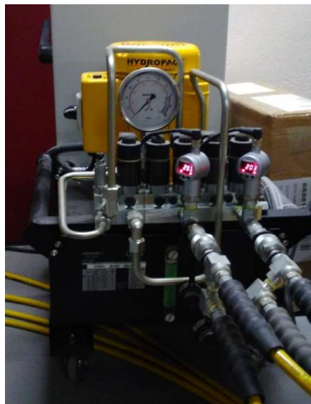
Figure 10 : compresseur asservi en pression
