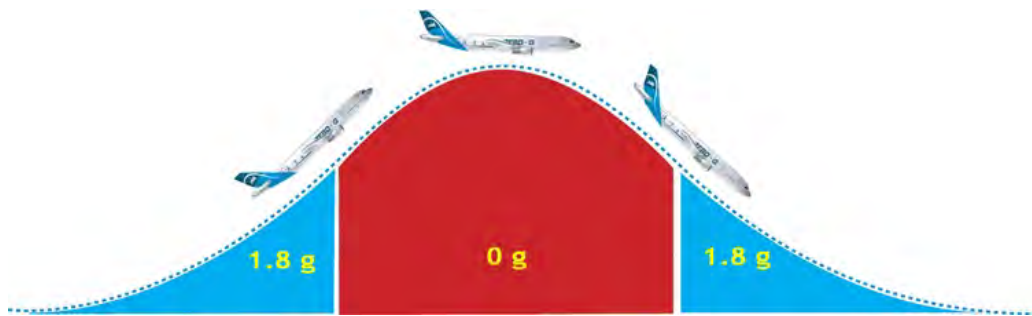
FIGURE 1.8 – Trajectoire d'un vol parabolique composé de deux phases d'hyperpesanteur séparant la phase de micropesanteur [9].
