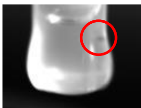
Figure III-15 : Photographie de l'extrémité du tuyau de génération juste après la formation d'une goutte de solution de FS à 10g/L. La surface du tuyau est lubrifiée par de l'huile
