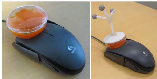
Figure 57. Prototype v3 de la RPM 2 avec des boutons plus doux. Pour détecter les manipulations de la RPM, celle-ci a été équipée de billes infrarouges (Droite).
