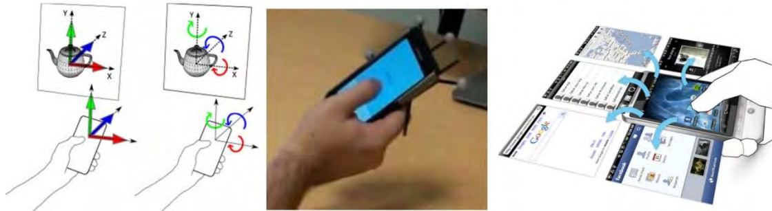
Figure 20. Manipulation tangible d'un dispositif mobile pour la manipulation 3D (Gauche, tiré de [15]) et pour la navigation dans un ensemble d'applications (Droite, tiré de [5]).
