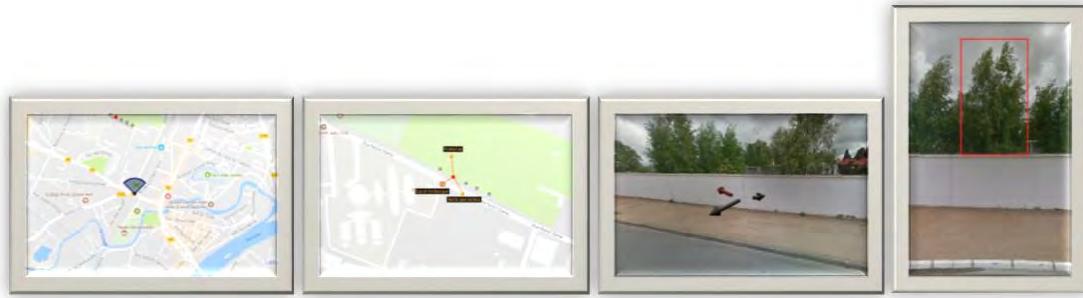
Figure 87. Scénario complet d'utilisation de notre technique d'interaction, de gauche à droite : déplacement jusqu'à 10m de l'arbre à l'aide du GPS embarqué, triangulation à l'aide d'objets urbains, affichage de la direction de l'arbre par rapport à la position actuelle (flèche rouge) et position des précédentes observations et mise en évidence de l'arbre à l'aide de photos des précédentes observations.
