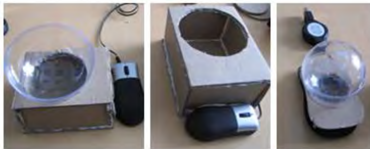
Figure 53. Prototypes en carton de la RPM 2 : la souris est placée sur le côté droit (gauche), à l'arrière (centre) ou sous (droite) la RPM.
