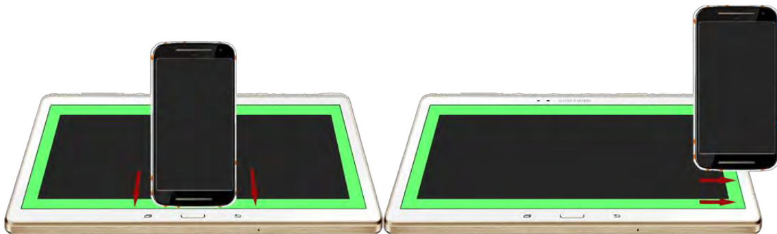
Figure 67. Défilement vertical (gauche) et horizontal (droite). La zone représentée en vert désigne la zone dans laquelle le mécanisme de défilement peut être activé.
