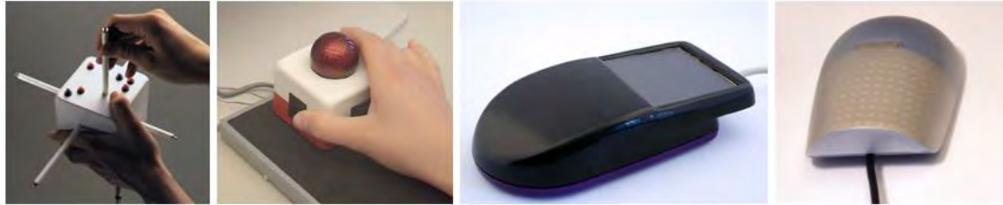
Figure 52. De gauche à droite, la Cubic Mouse [54], la GlobeMouse [53], la PadMouse [8] et la CapMouse [185].
