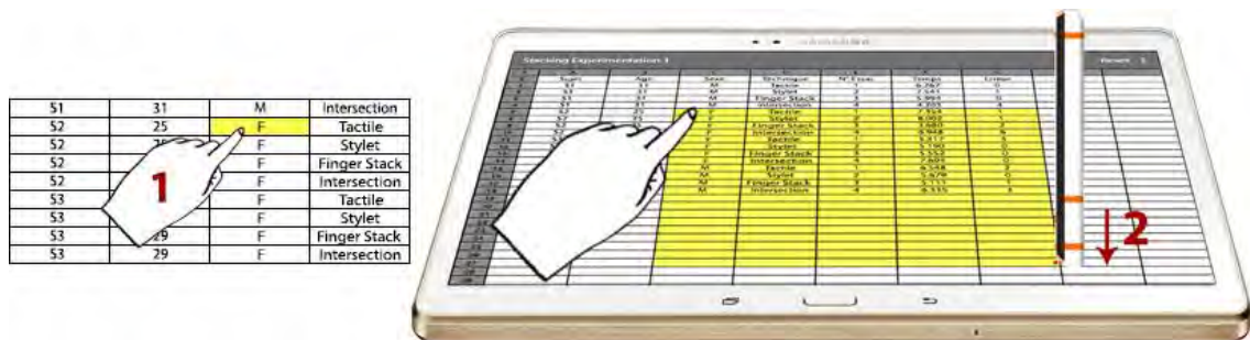
Figure 69. Technique Finger Stack : toucher pour sélectionner le coin haut-gauche (1) et stack pour sélectionner le coin bas-droit (2) de la plage.
