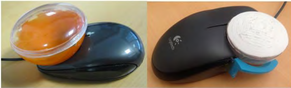
Figure 56. Prototype v3a (Gauche) et v3b (Droite) de la RPM 2. Ces prototypes diffèrent dans la position de la RPM par rapport à la souris ainsi que dans la disposition des boutons.
