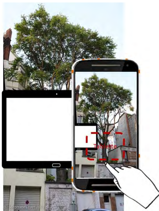
Figure 86. Calcul de la télémétrie de l'arbre à l'aide d'un objet étalon: une tablette.
