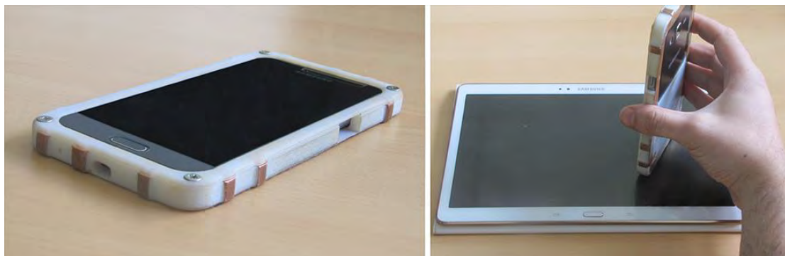
Figure 63. Coque conductrice en cuivre (gauche). stacking de notre prototype sur l'écran de la tablette (droite).
