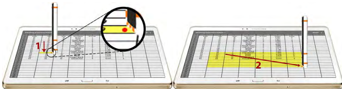
Figure 68. Technique Stack-and-Drag : stack du smartphone (1) et translation (2) pour étendre la sélection.
