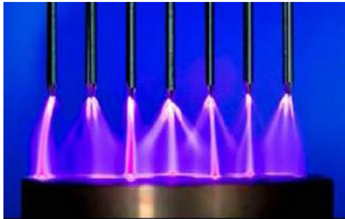
Figure 1-3 Photographie d'une décharge corona multi-pointes pulsée au laboratoire LAPLACE (d'après M.Yousfi et al. 40 ). Conditions expérimentales : tension d'alimentation 8kV, durée d'impulsion 40 \mu s, fréquence de répétition 100Hz, distance inter-électrode 8mm et rayon de courbure des pointes : 25 \mu m. 14 pointes réparties en deux rangées de 7.
