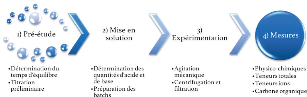
FIGURE 21 – Protocole expérimental du test
