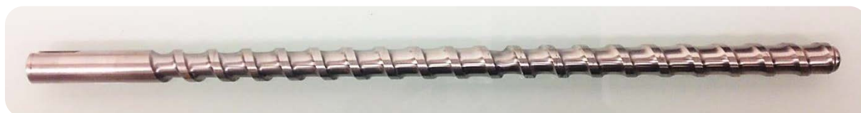
Figure II.3 – Photographie de la vis de l'EMV dont le profile favorise le transport de la matière.
