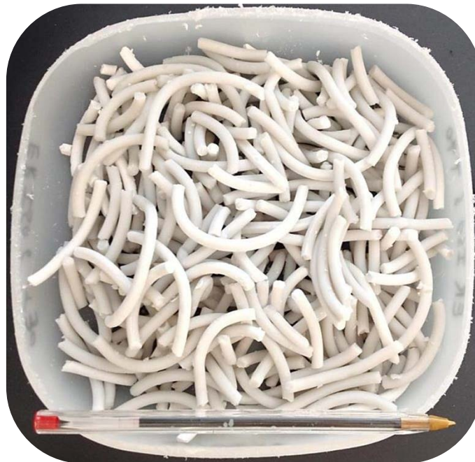
Figure V.33 – Photographie des extrudés ER-iso-8-C-MEF-SOFT et HARD après séchage.
