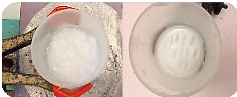
Figure IV.2 - a) Photographie de la boehmite \text{SAI}(2,10)/\text{NAI}(1,00) fraîchement synthétisée b) test de viscosité qualitatif (à la spatule) de la boehmite synthétisée pour un rapport \text{SAI}(2,10)/\text{NAI}(1,00) .
