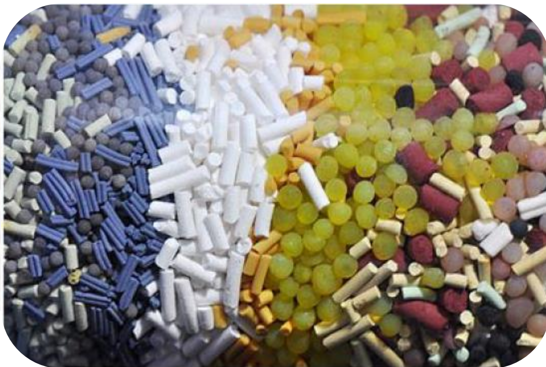
Figure 1.20 – Photographie des différentes mises en forme possibles d'un catalyseur. 99
