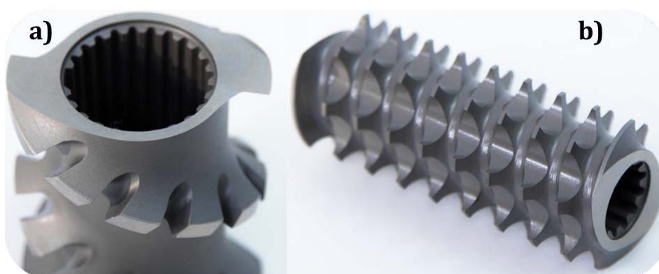
Figure I.29 - Mélangeurs a) deux lobes avec rainures d'écoulements et b) deux lobes. 116
