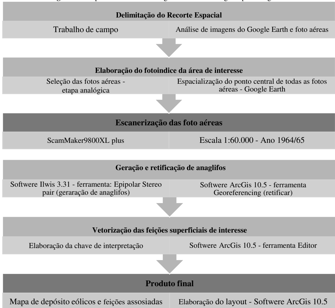
Figura 7: Pré-processamento de fotografias aéreas analógicas para anaglifos
