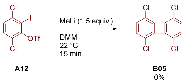
Schéma 89 : Synthèse du biphenylène B05
