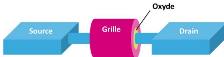
Figure 5 : Représentation schématique d'un transistor à grille enrobante (GAA)
