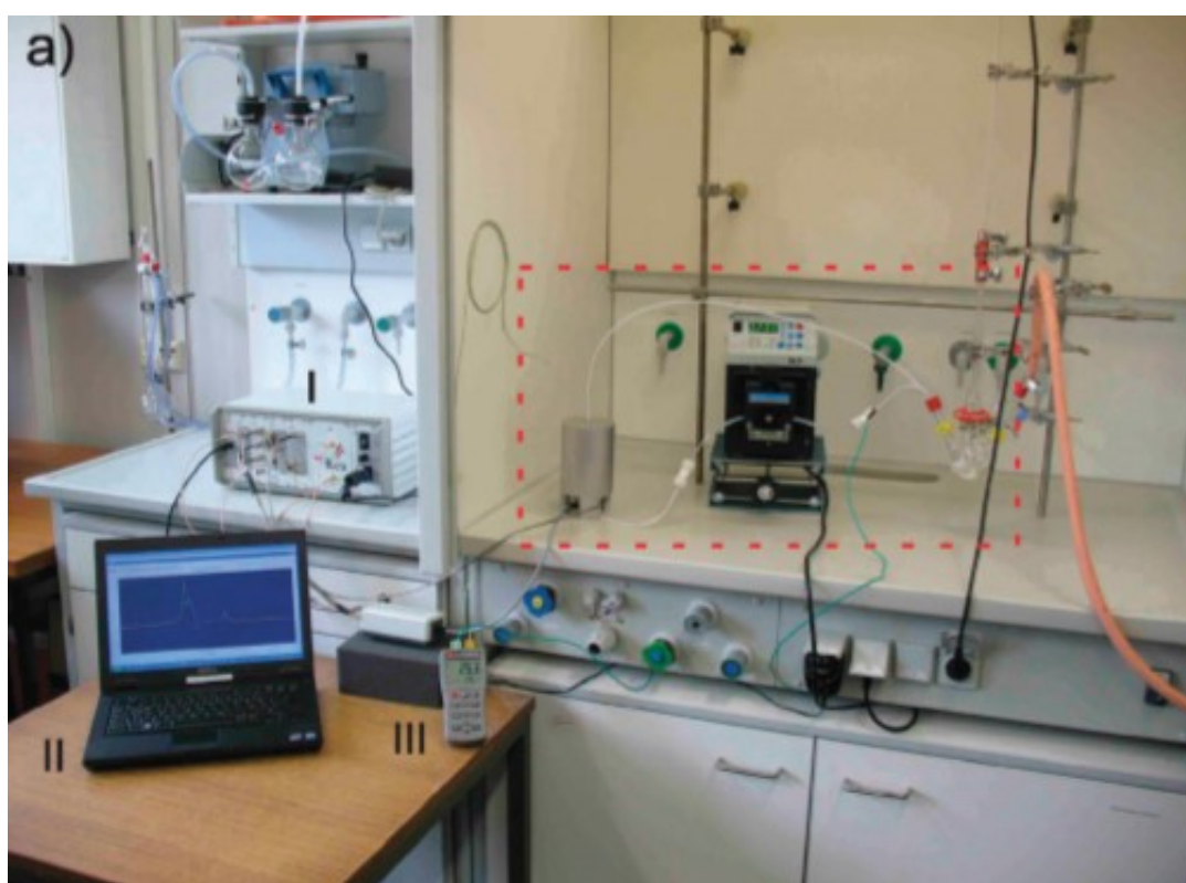
Figure 17 : Montage « on-line » pour le suivi réactionnel directement sous une hotte. Extrait de la référence 70.
