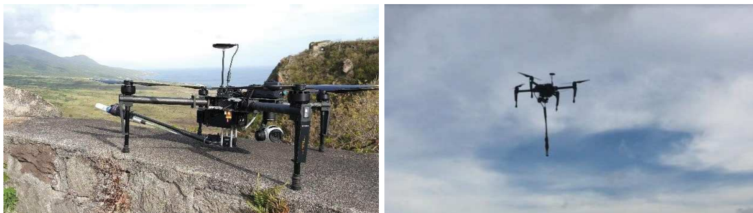
FIGURE 4.30 – Image du drone Matrice 100 équipé de l'électronique IPGS/DIEFI et du capteur fluxgate trois composantes Bartington. A droite, le drone en vol avec la perche magnétométrique déployée
