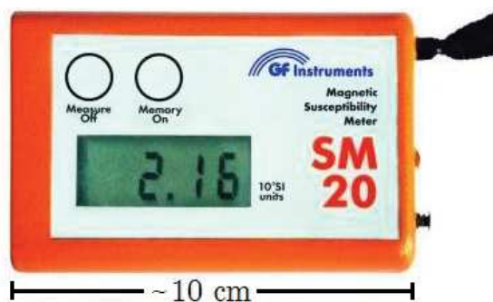
FIGURE 4.19 – Susceptibilimètre de terrain SM-20, GF-Instruments ( http://www.gfinstruments.cz/ ).
