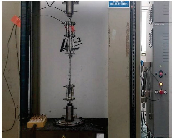
(a) Vue générale de la configuration des essais d'arrachement
