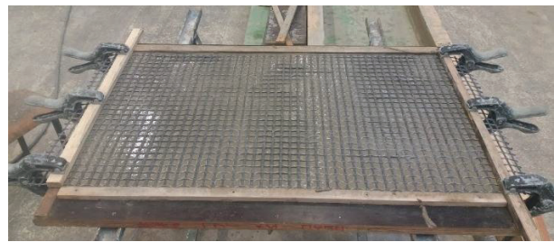
(b) Moulage au contact (à la main)
