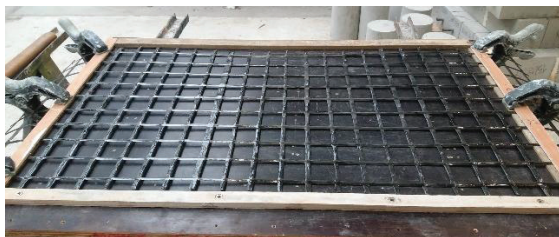
(a) Maillage de carbone et préparation de moulage
