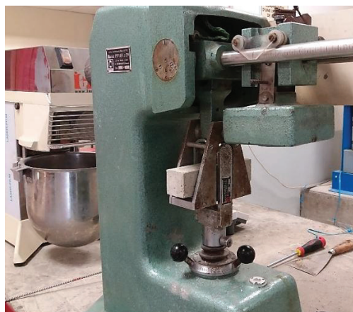
(a) Essai de flexion trois points
