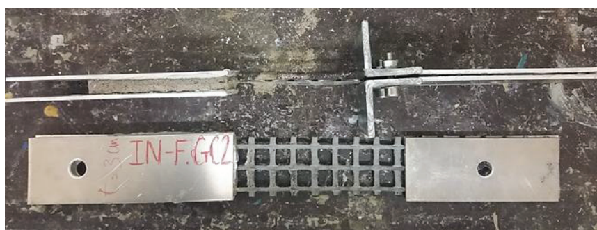
(c) Etiquetage des éprouvettes d'interface textile/matrice
