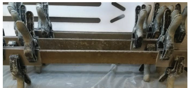
(d) Renforcement des extrémités d'éprouvettes de TRC par les plaque en aluminium
