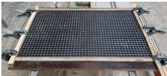
(a) Maillage de carbone et préparation de moulage
