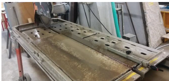
(c) Coupe de la plaque rectangulaire de composite
