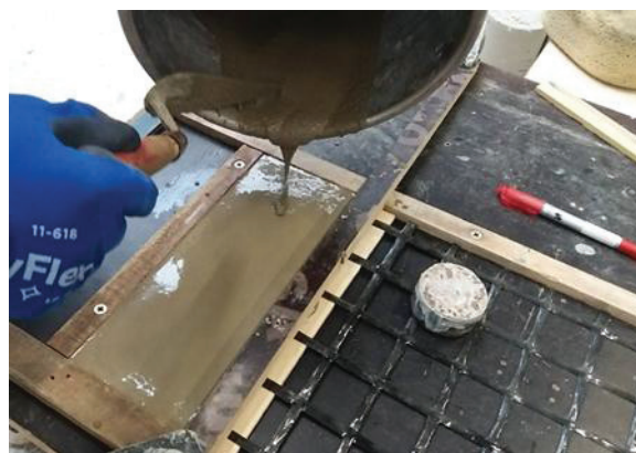
(b) Moulage des éprouvettes d'interface textile/matrice
