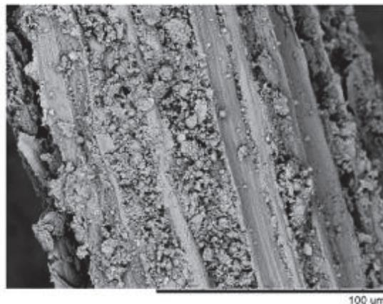
(b) Des produits d'hydratation à la surface des fibres de sisal après le test d'arrachement
