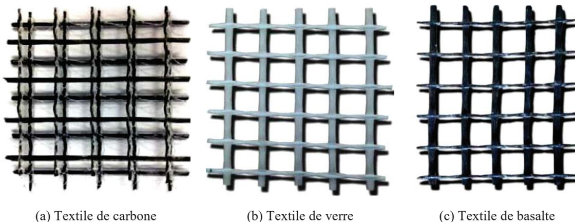
*Figure 1. 1 : Textile de renforcement à différentes natures*
