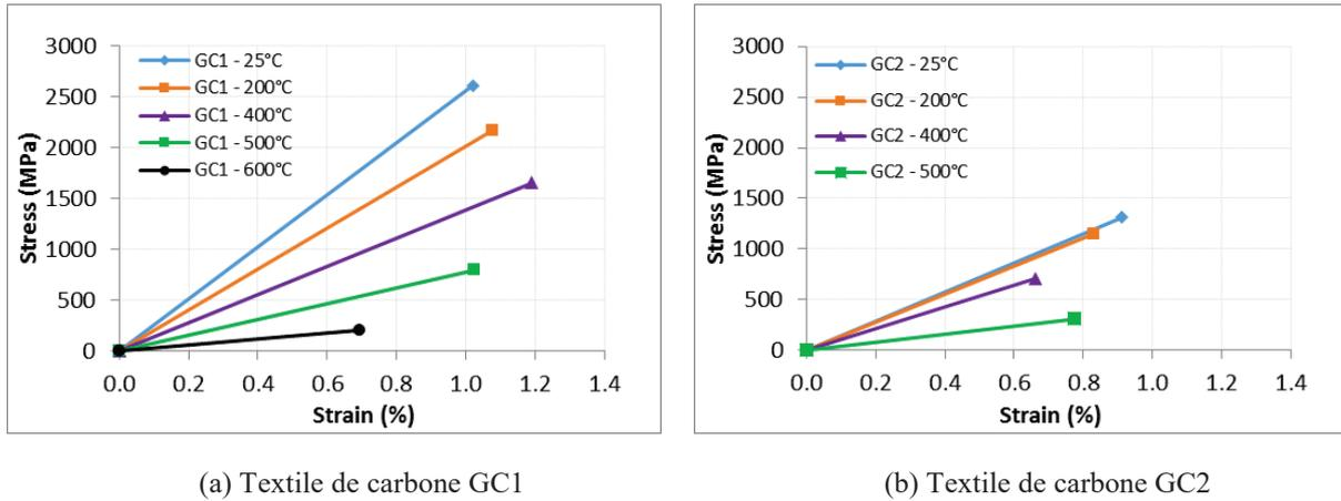
Figure 4. 2: Loi du comportement mécanique des textiles de carbone GC1 et GC2 dans le modèle numérique à différentes températures
