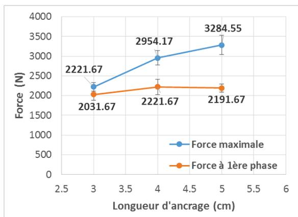
(a) Force à 1<sup>ère</sup> phase et force d'arrachement pour les éprouvettes IN-F.GC1
