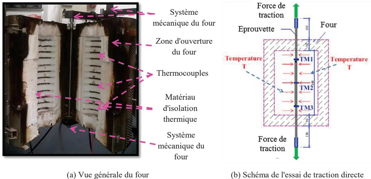
Figure 2. 10: Détail du four pour l'essai thermomécanique sur TRC
