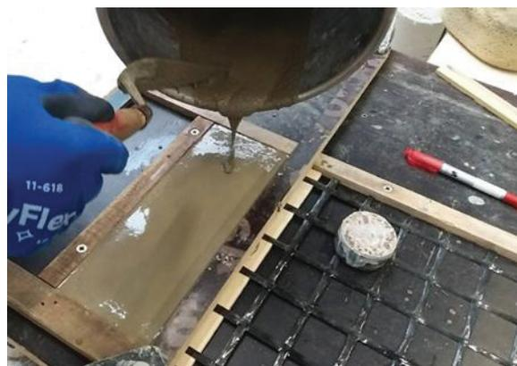
(b) Moulage des éprouvettes d'interface textile/matrice
