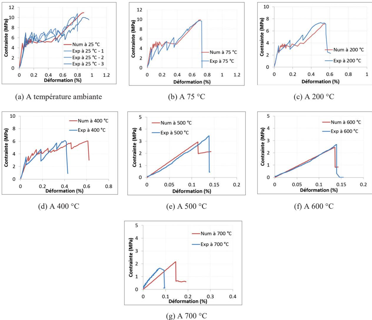
Figure 4. 32 : Comportement du composite F.GC2 à différentes températures
