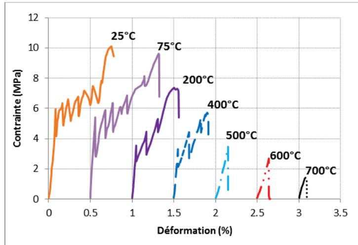
Figure 3. 11 : Comportement thermomécanique des éprouvettes F.GC2: relation contrainte-déformation à différentes températures
