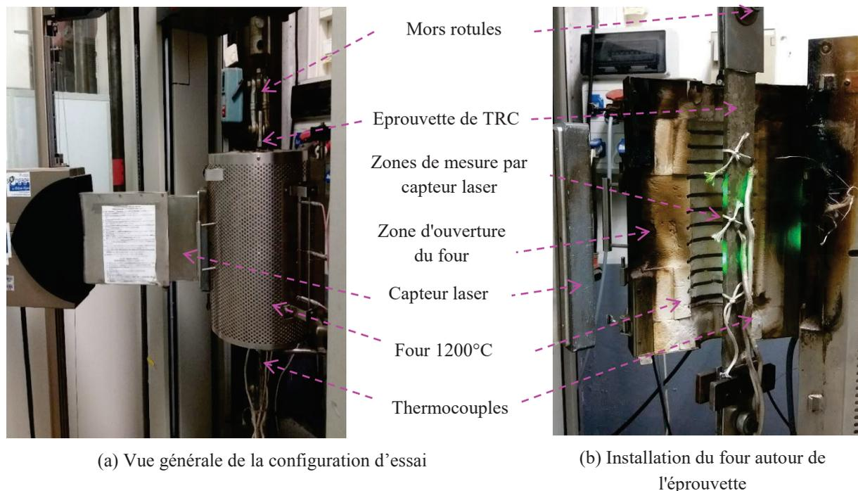
Figure 3. 1: Configuration d'essai thermomécanique sur l'éprouvette de TRC
