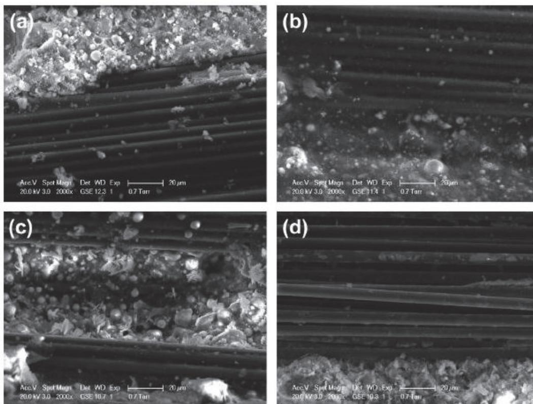
Figure 1. 34 : Interface matrice-fibre de carbone revêtue: (a) dans son état naturel et (b) après exposition à des températures de (b) 150 °C, (c) de 200 °C et (d) de 400 °C, Selon Silva et al [43]
