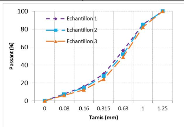
Figure 2. 4 : Courbes granulométriques d'agrégats synthétiques silico-alumineux-calciques
