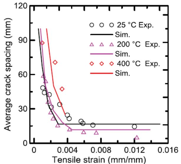
(b) Espacement des fissures à différentes températures
