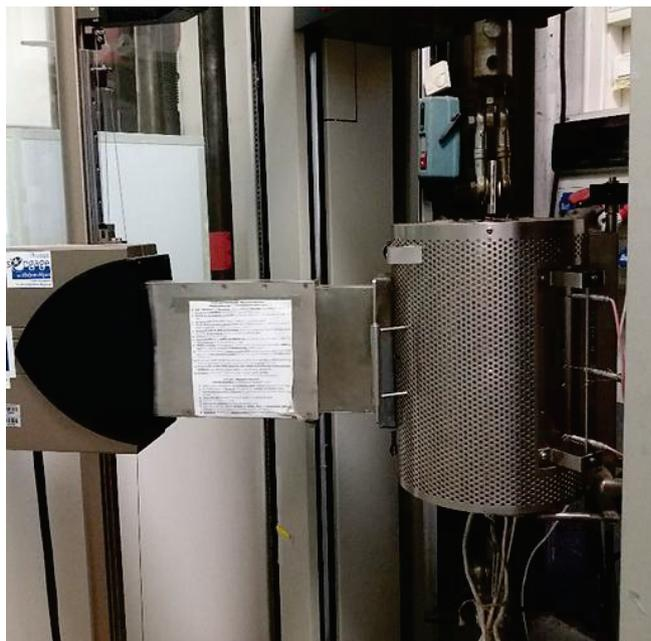
a) Vue générale de la configuration d'essai thermomécanique
