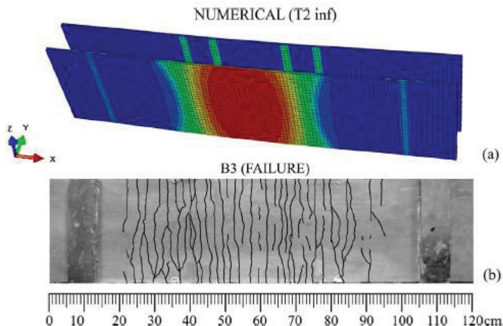
Figure 1. 67 : Mode de rupture sur le renforcement de TRC, selon Colombo et al [132]
