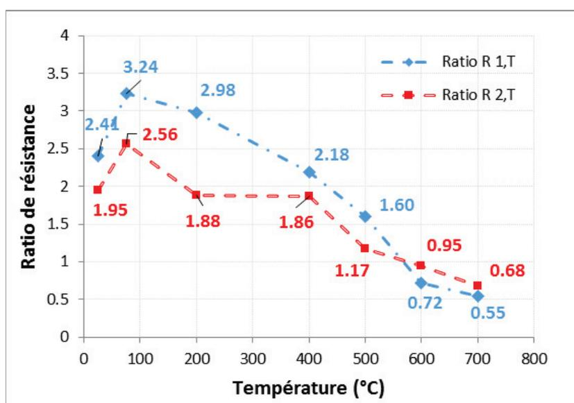
Figure 3. 17: Evolution du rapport de la résistance ultime  $R_{1,T} = \sigma_{T,UTS}$  (F.GC1) /  $\sigma_{T,UTS}$  (F.M) et  $R_{2,T} = \sigma_{T,UTS}$  (F.GC2) /  $\sigma_{T,UTS}$  (F.M) en fonction de la température
