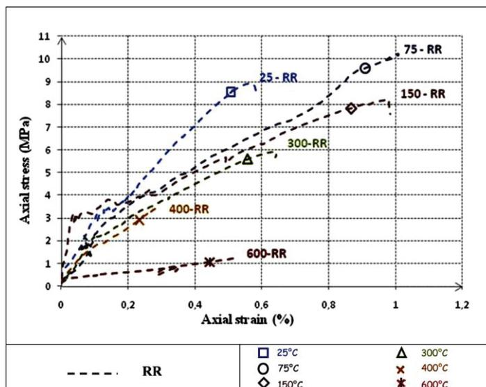
Figure 1. 45 : Comportement résiduel du composite 3G.AR à différentes températures, Selon Tlajji et al [35]
