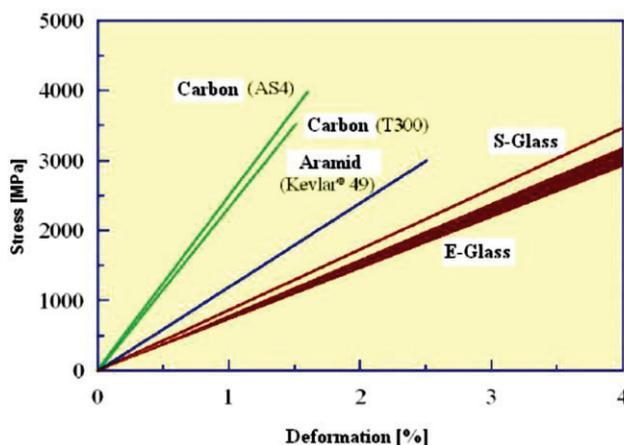
Figure 1. 5 : Comportement mécanique des fibres à différentes natures [44]
