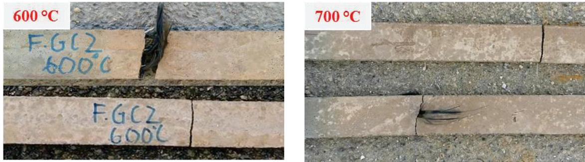
Figure 3. 12: Modes de rupture d'éprouvettes de F.GC2 à différentes températures
