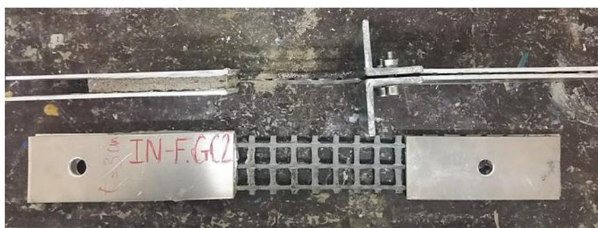
(c) Etiquetage des éprouvettes d'interface textile/matrice
