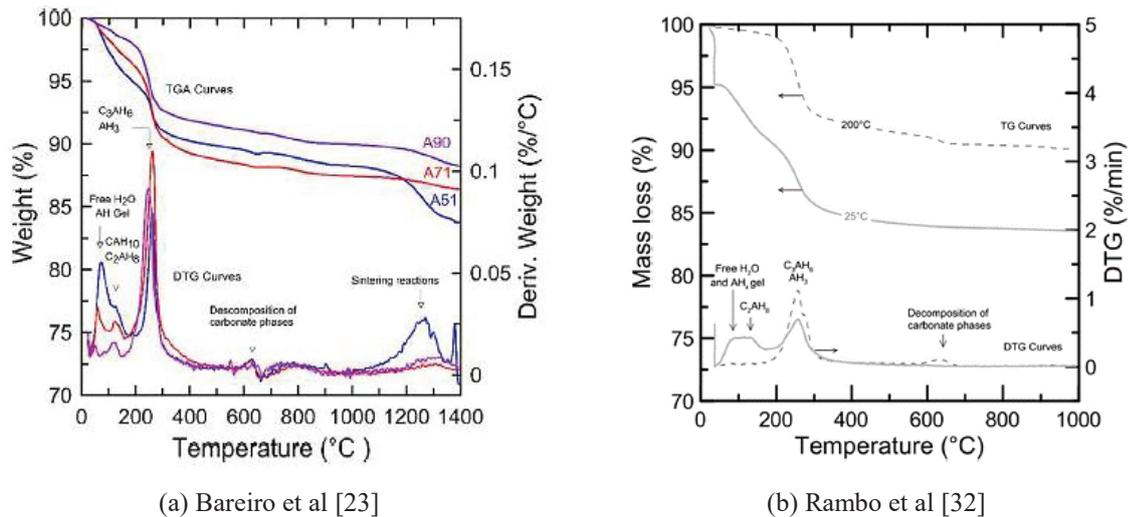
Figure 1. 14 : Résultats des analyses thermogravimétriques et thermogravimétries dérivées pour perte de masse des bétons réfractaires
