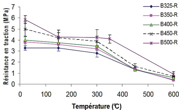
Figure 1. 22 : Evolution de la résistance résiduelle en traction en fonction de la température [58]
