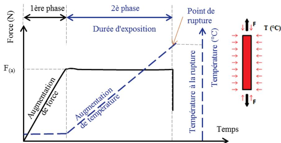
Figure 3. 4: Schéma de chargement des essais thermomécaniques au régime TMFC
