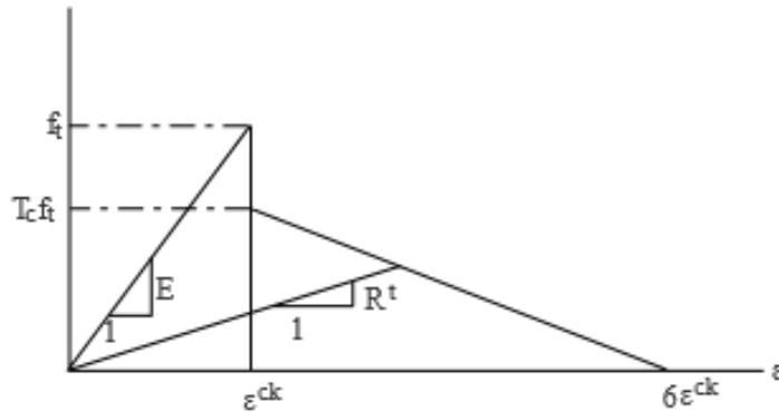
Figure 4. 8: Loi du comportement mécanique de la matrice
