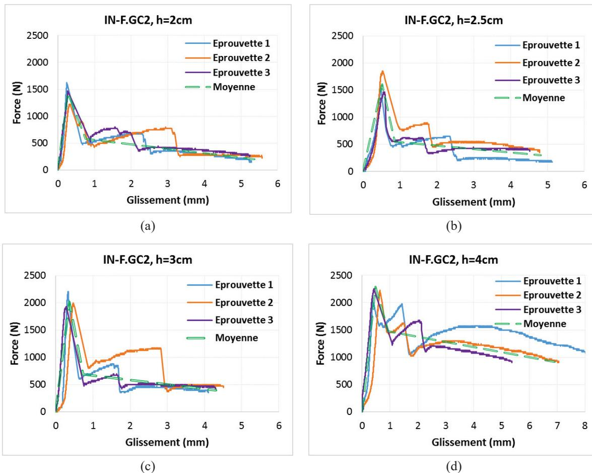
Figure 2. 37: Courbes « force – glissement » de l'interface textile GC2/matrice cimentaire avec différentes longueurs d'ancrage
