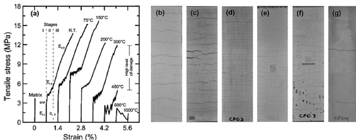
Figure 1. 46: Influence de la température sur le comportement résiduel en traction des composites TRC : (a) courbes contrainte – déformation à différentes températures de préchauffage dans le régime de préchauffage-refroidissement; modes de rupture d'éprouvettes (préchauffées-refroidies) après essai mécanique en traction : (b) à température ambiante, (c) à 75 °C, (d) à 150 °C, (e) à 200 °C, (f) à 300 °C et (g) à 400 °C, selon Rambo et al [31] [32] [33]
