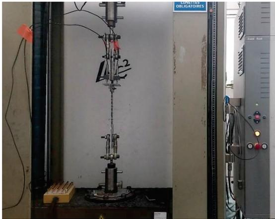
(a) Vue générale de la configuration des essais d'arrachement
