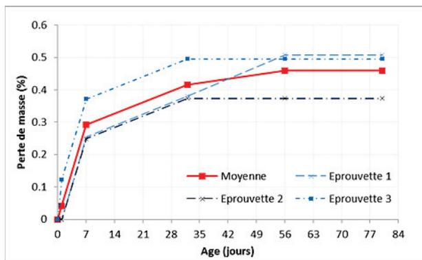
Figure 2. 7 : Perte de masse dans l'air de l'éprouvette de matrice réfractaire (initialement saturée)
