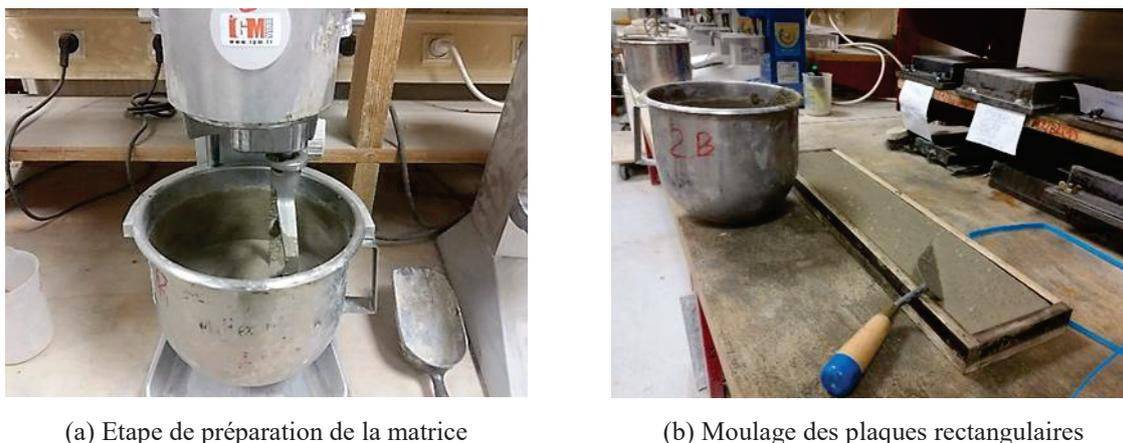
Figure 2. 15 : Préparation d'éprouvettes de la matrice du béton pour des essais en traction directe
