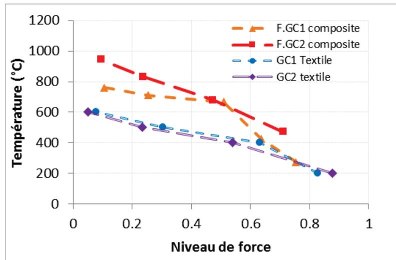
Figure 3. 25 : Evolution de la température de rupture ( $T_r$ ) en fonction du niveau de charge appliquée en comparant avec les résultats expérimentaux des textiles de carbone
