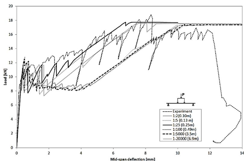
Figure 1. 61 : Modèle numérique en 2D du comportement en flexion de TRC, Selon Portal et al [118]
