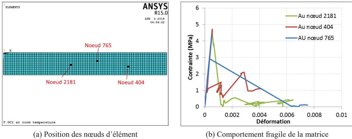
Figure 4. 33 : Comportement mécanique de la matrice cimentaire aux nœuds d'élément sur l'éprouvette
