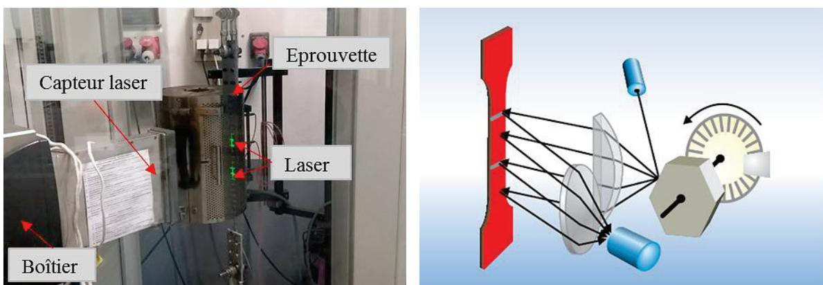
Figure 2. 11: Détails du capteur laser utilisé
