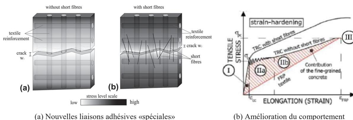
Figure 1. 55: Comportement d'un TRC avec et sans fibres courtes
