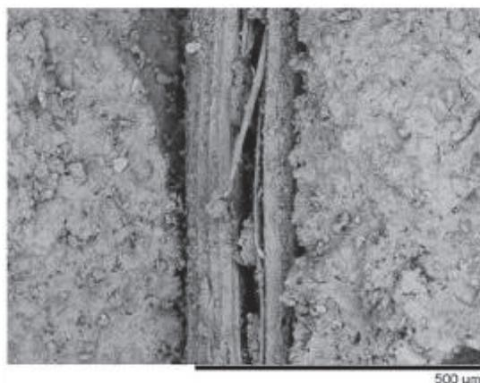
(c) Fibre incorporée dans une matrice à base de ciment
