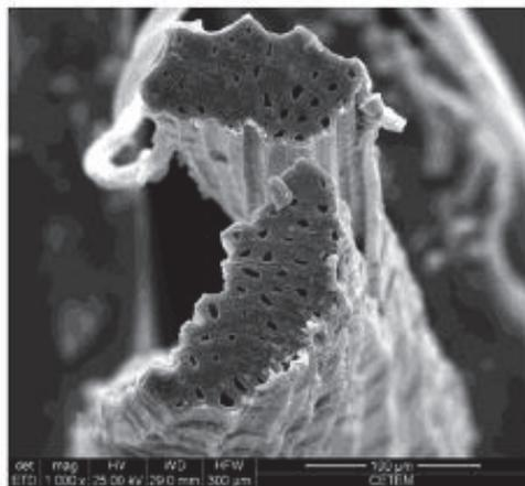
(a) Une section transversale de la fibre avant de test
