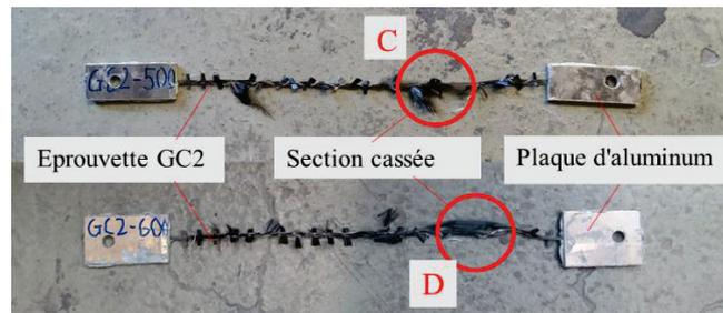
(a) GC2 : Mode de rupture à température supérieure à 400 °C
