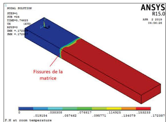
(b) Déplacement des points sur l'éprouvette
