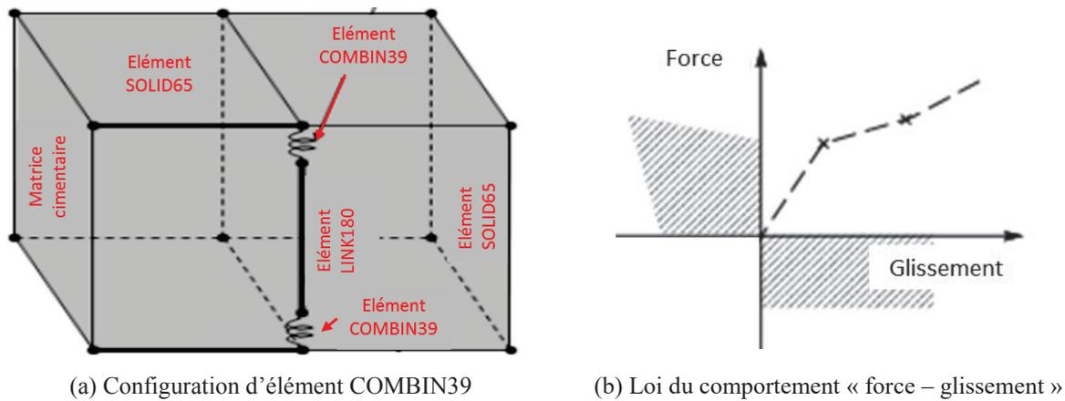
Figure 4. 12 : Elément COMBIN39 pour modèle de l'interface
