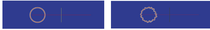
FIGURE 1.15 – Simulation du schéma explicite (1.103) pour un pas de temps dt = 0.0035 supérieur au seuil limite. La bulle explose rapidement.
