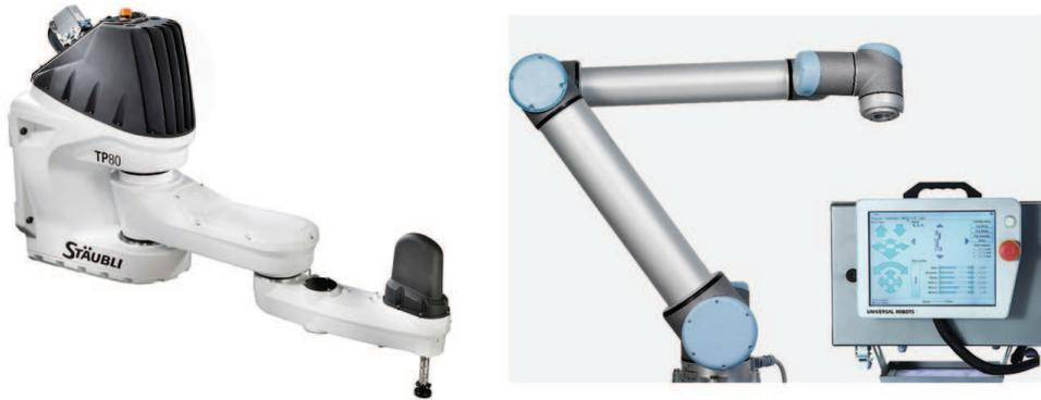
FIGURE 1.2: Robot Staubli TP80 Fast Picker (à gauche) et bras Universal (à droite).
