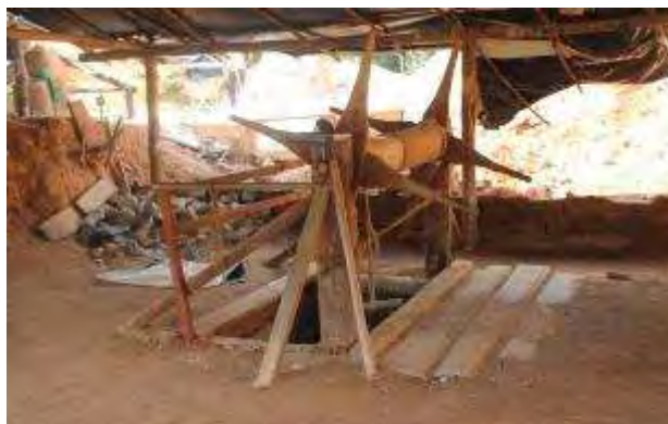
Figure 23 : Puits construit pour l'entrée et la sortie des hommes et l'extraction du minerai (terre et pierre) au Filon de Macu, Suriname (2012).
