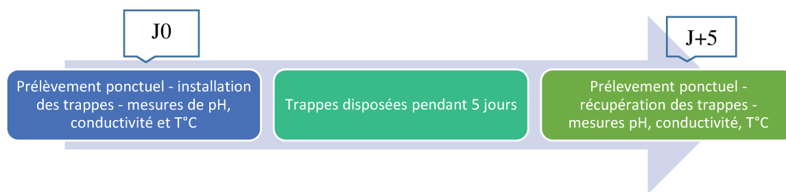
Figure 2 - 8 : Schéma du déroulement d'une campagne de prélèvements
