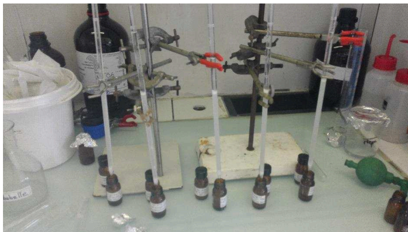
Figure 2 - 14 : Etape de purification des échantillons sur colonnes de silice (LEESU, Créteil).
