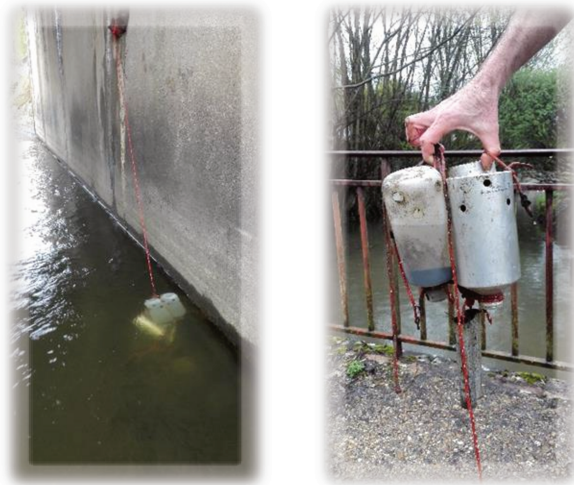
Figure 2 - 9 : Système de trappes à sédiments installées dans la rivière, avec un jeu de deux bouteilles en plastique pour les ETM et deux bouteilles en aluminium pour les HAP. Le dispositif est conçu pour être maintenu verticalement sous la surface. Conception du dispositif, pose et dépose réalisée par Gaël Monvoisin (GEOPS).
