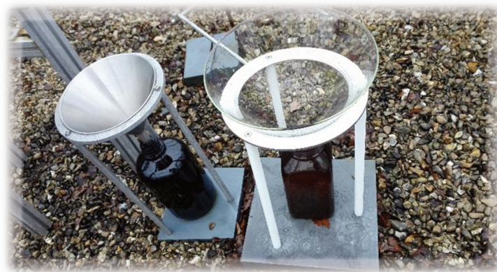
Figure 2 - 10 : Pluviomètres installés sur le site de l'Yvette (fabrication par Gaël Monvoisin (GEOPS))
