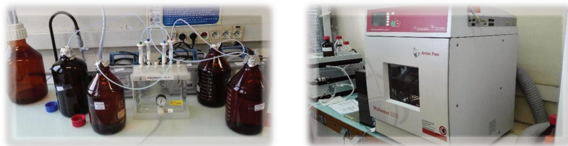
Figure 2 - 13 : (a) Extraction manuelle des matrices liquides sur Visiprep (LSCE, Gif). (b) Micro-ondes utilisé pour les extractions des matrices solides (LEESU, Créteil).
